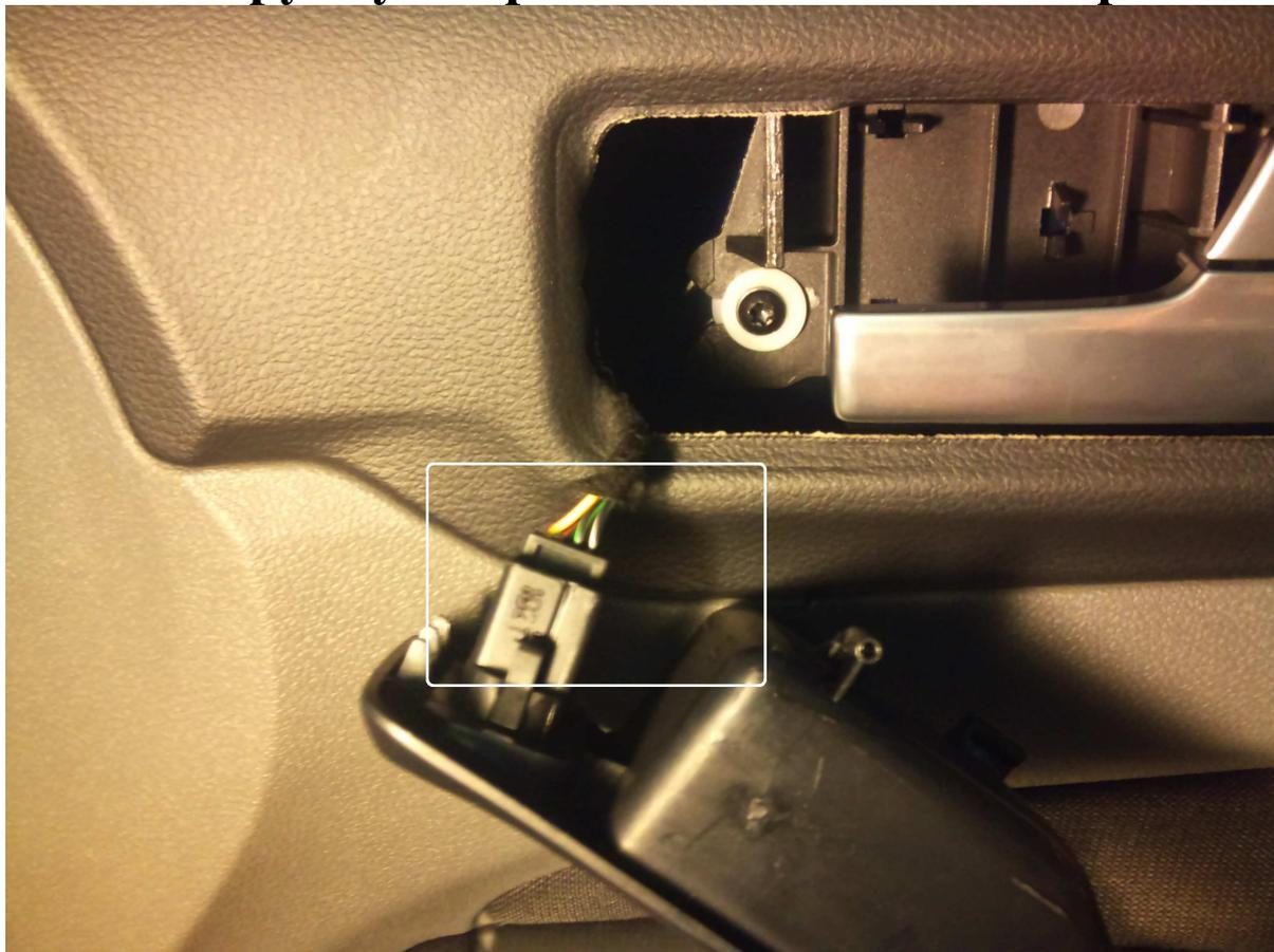
**потом отщёлкиваем накладку под ручкой закрытия**
