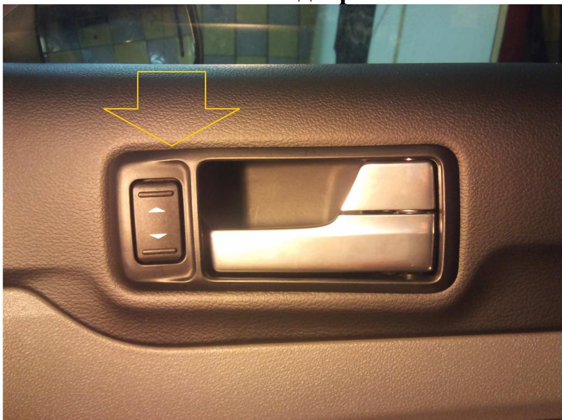
**снимаем ручку открытия и отщёлкиваем разъём**
