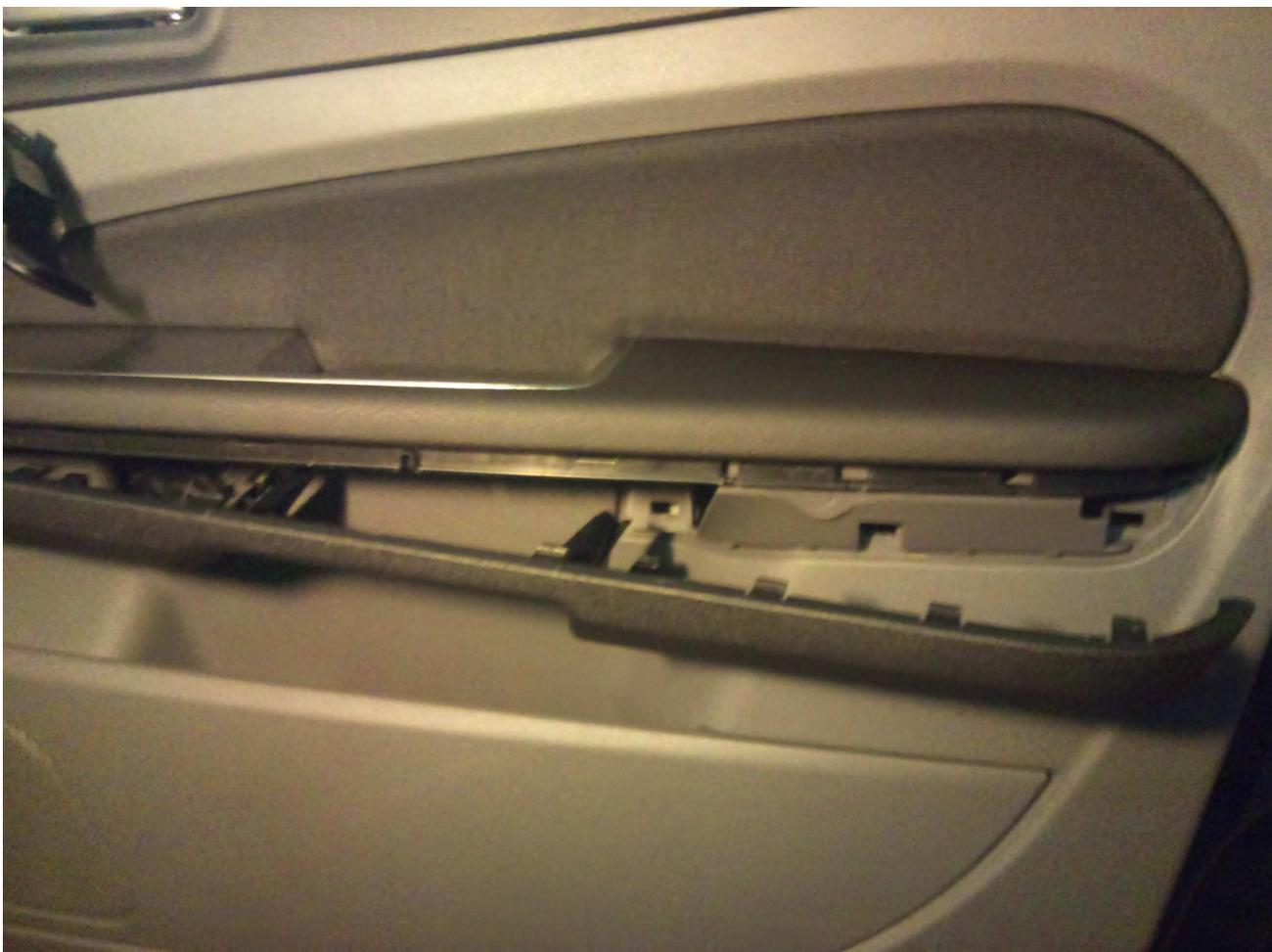
**выкручиваем болты и снимаем обшивку**
