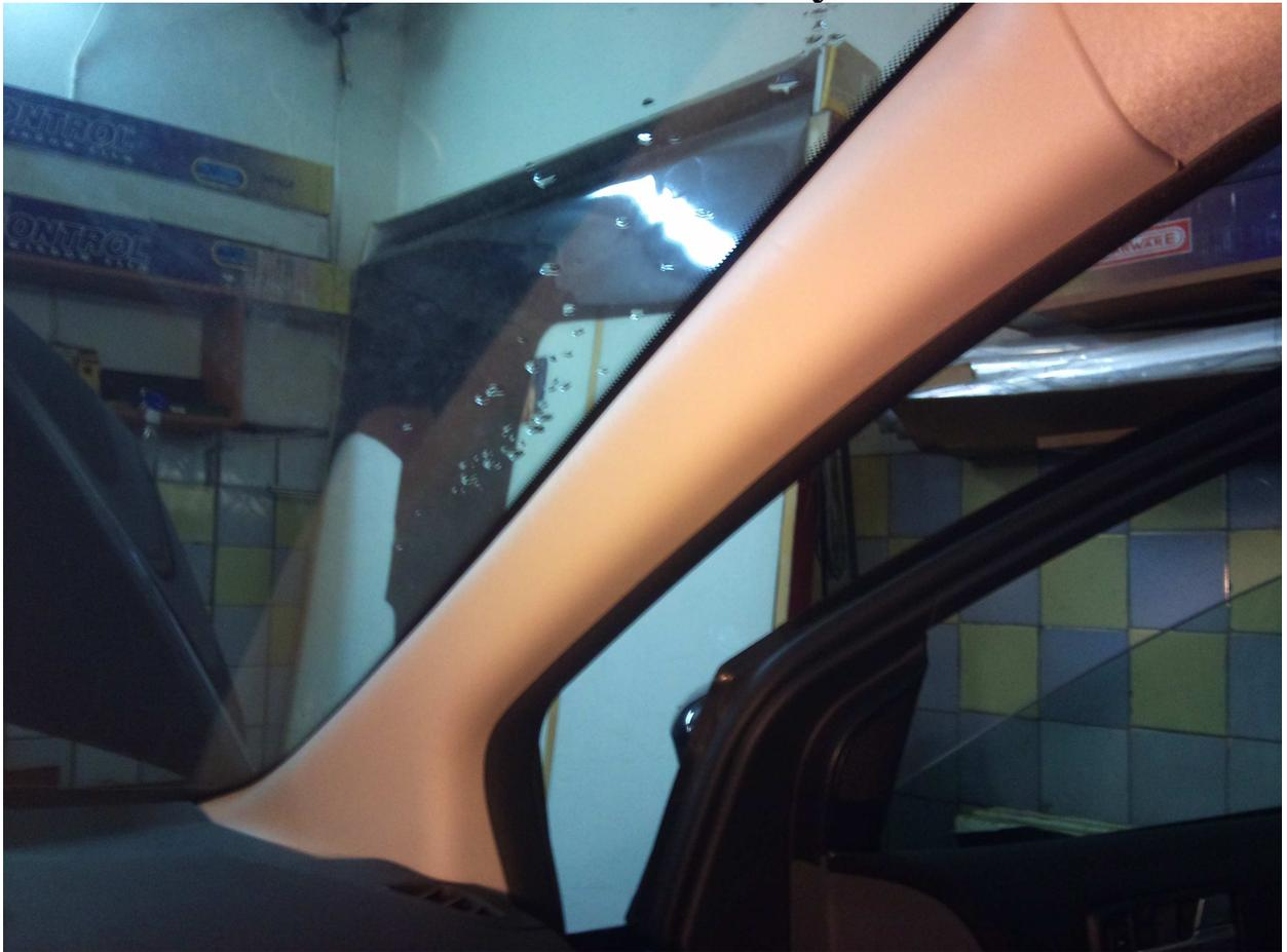
**снимаем накладку стойки**
