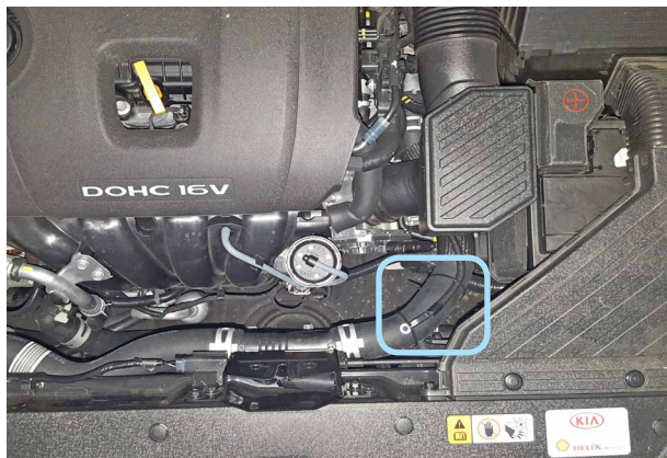
Фото 5.3. Место установки датчика температуры двигателя
