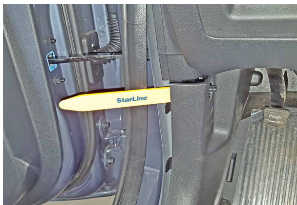
Фото 1.5. Снять накладку левой кик-панели
