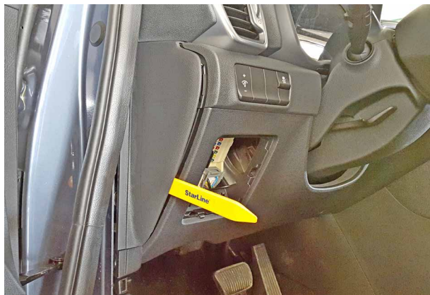
Фото 1.7. Снять боковую накладку передней панели
