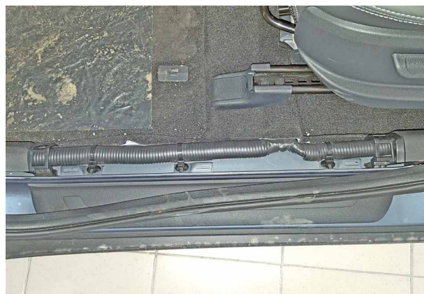
Фото 1.4. Накладка порога двери водителя снята
