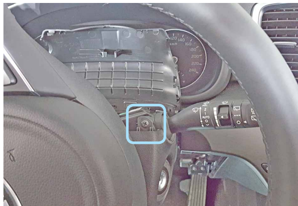
Фото 2.4. Саморез крепления нижней части кожуа рулевого вала справа
