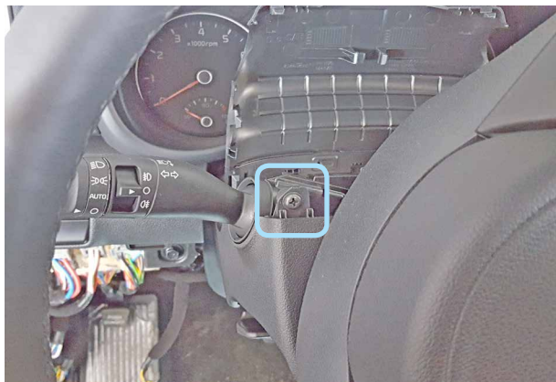
Фото 2.3. Саморез крепления нижней части кожуа рулевого вала слева
