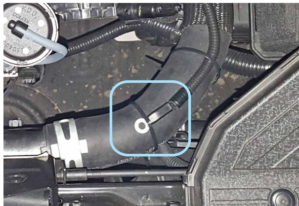
Фото 5.4. Крепление датчика температуры двигателя
