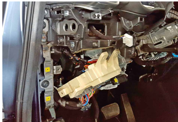
Фото 3.4. Монтажный блок предохранителей снят
