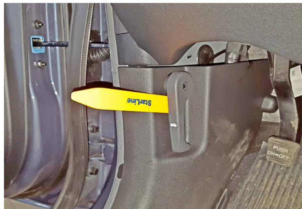
Фото 1.2. Снять ручку отпирания капота
