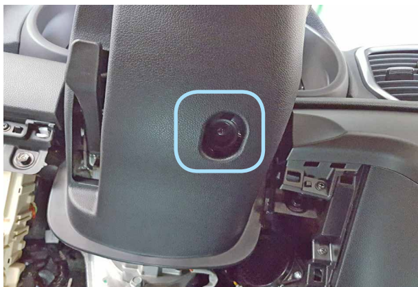
Фото 2.5. Саморез крепления нижней части кожуа рулевого вала снизу
