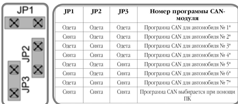
Рис. 1: Перемычки под крышкой центрального блока
