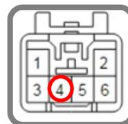
Разъём антенны иммобилайзера (вид со стороны контактов) (а/м без функции SmartKey)
