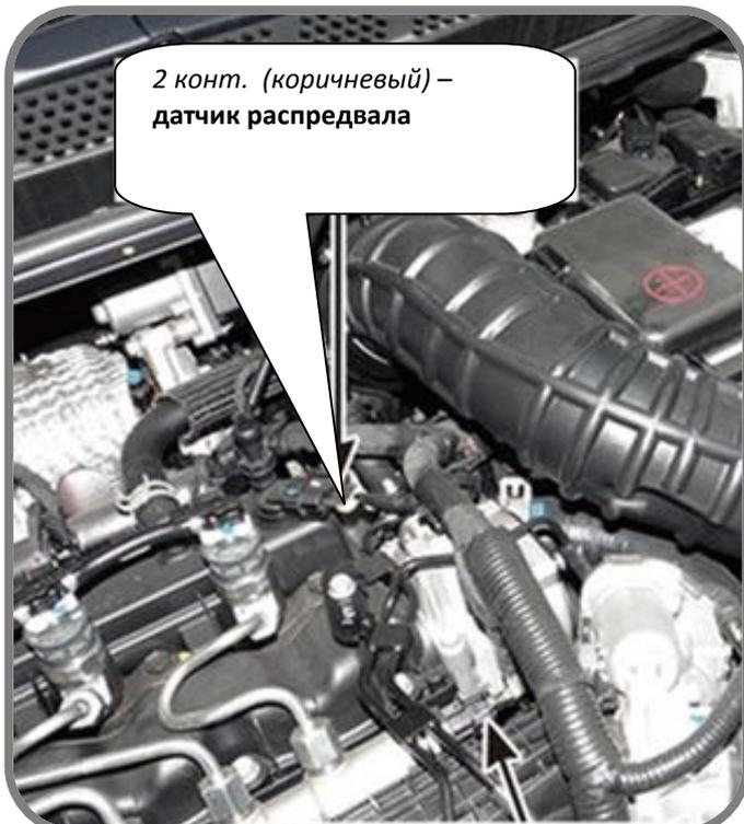
Разъём «C313» датчика распредвала (под капотом автомобиля):
