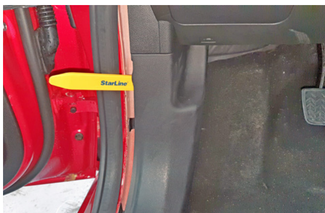
Фото 1.5. Снять накладку левой кик-панели
