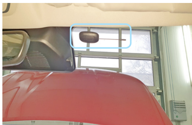
Фото 2.1. Возможное место установки антенного модуля
