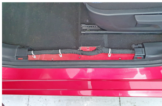
Фото 1.4. Накладка порога двери водителя снята
