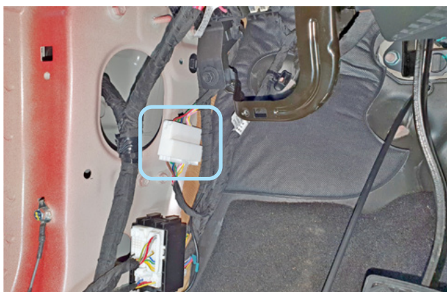
Фото 3.2. Местоположение разъёма P34
