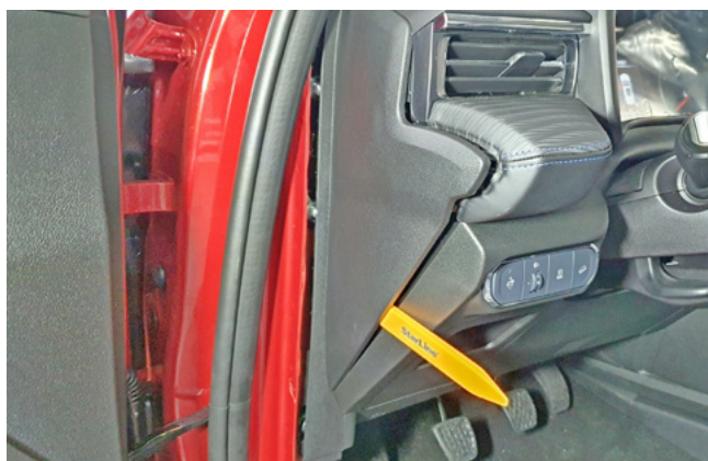
Фото 1.7. Снять боковую накладку передней панели
