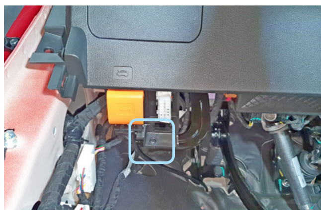
Фото 1.9. Саморез в нижней части накладки
