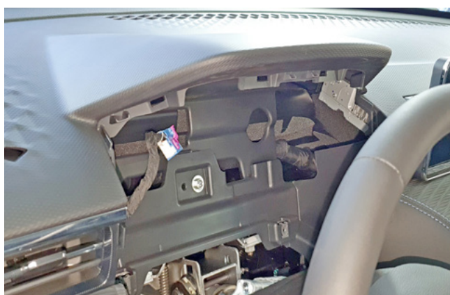
Фото 1.15. Панель приборов снята
