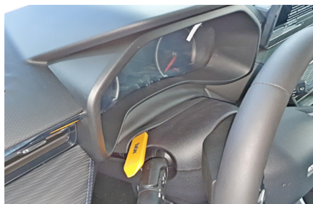
Фото 1.12. Снять пылезащитный кожух рулевой колонки
