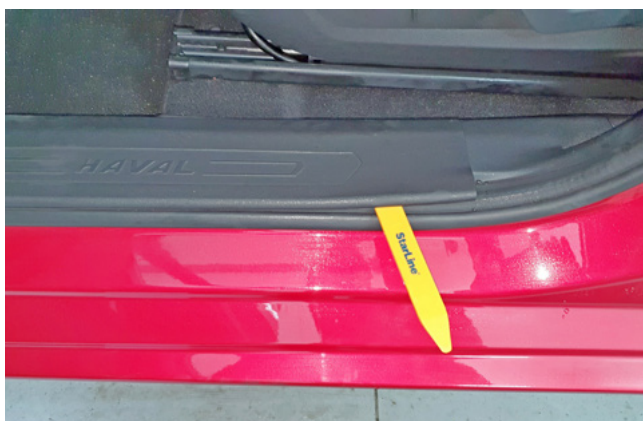
Фото 1.3. Снять накладку порога двери водителя
