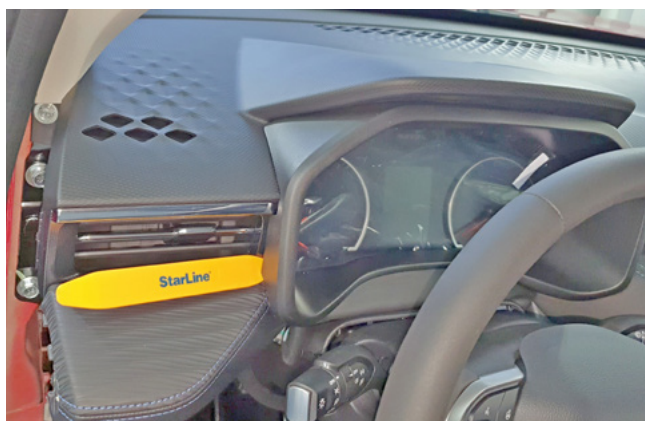
Фото 1.13. Снять декоративную накладку панели приборов
