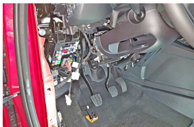
Фото 1.10. Пластиковая накладка под рулевой колонкой снята
