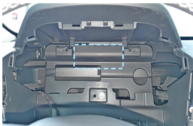
Фото 2.7. Пример расположения центрального блока охранно-телематического комплекса
