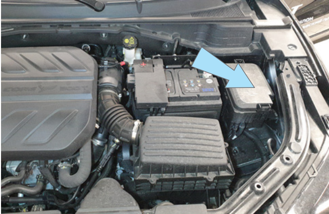
Фото 2.8. Возможное место установки подкапотного блока R6
