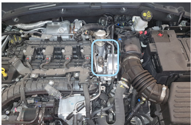
Фото 2.4. Место установки датчика температуры двигателя
