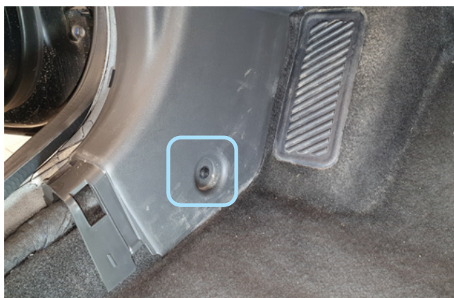
Фото 1.6. Саморез крепления накладки левой кик-панели
