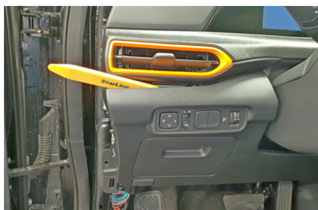
Фото 1.9. Снять пластиковую накладку под рулевой колонкой
