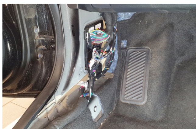
Фото 1.8. Накладка левой кик-панели снята
