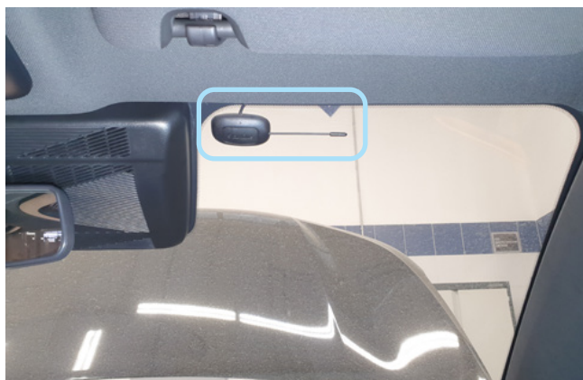
Фото 2.1. Возможное место установки антенного модуля
