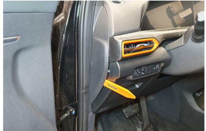
Фото 1.2. Снять боковую накладку передней панели
