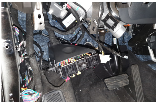
Фото 1.14. Монтажный блок предохранителей снят
