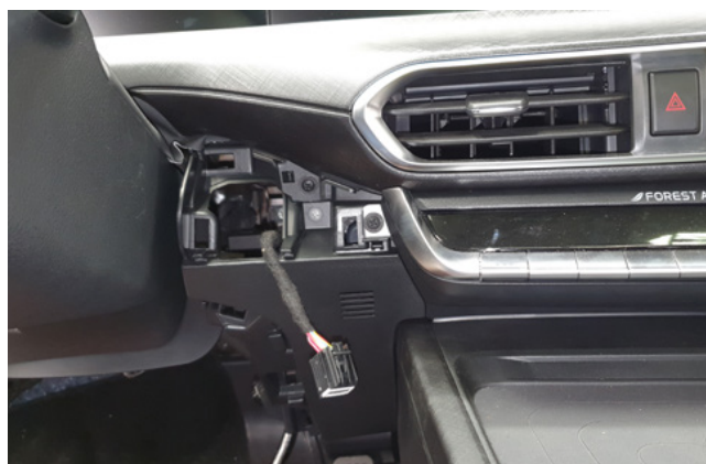
Фото 1.12. Накладка с кнопкой Старт-Стоп снята
