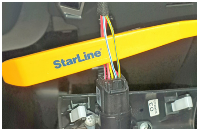
Фото 3.8. Управление кнопкой Старт-Стоп (жёлто-синий и бело-синий)
