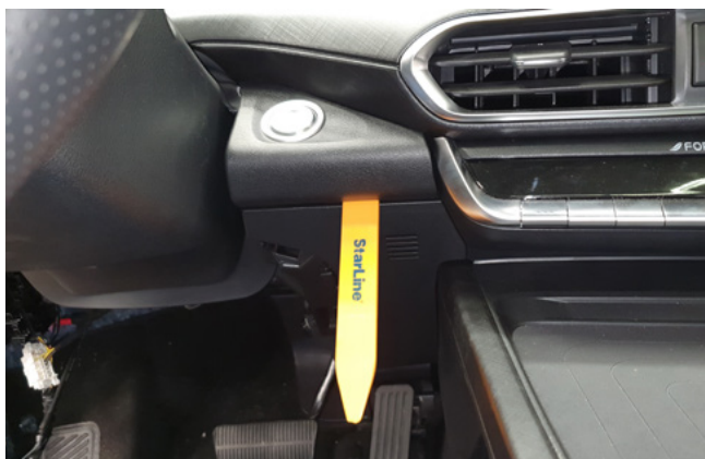
Фото 1.11. Снять накладку с кнопкой Старт-Стоп
