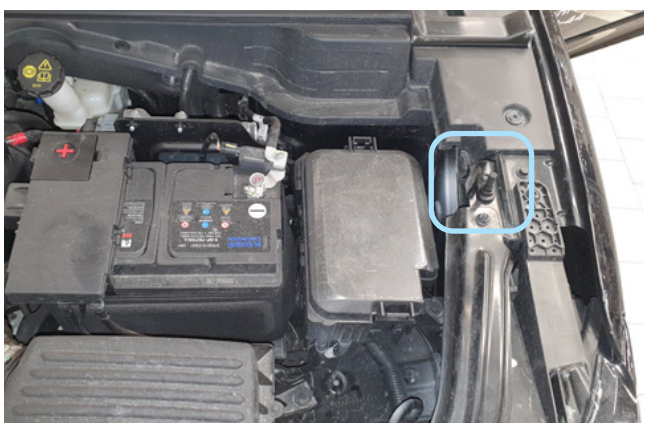
Фото 2.6. Возможное место установки концевика капота
