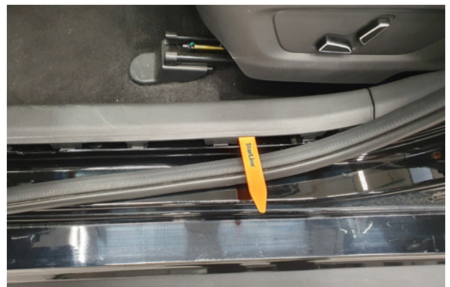
Фото 1.4. Снять накладку порога двери водителя
