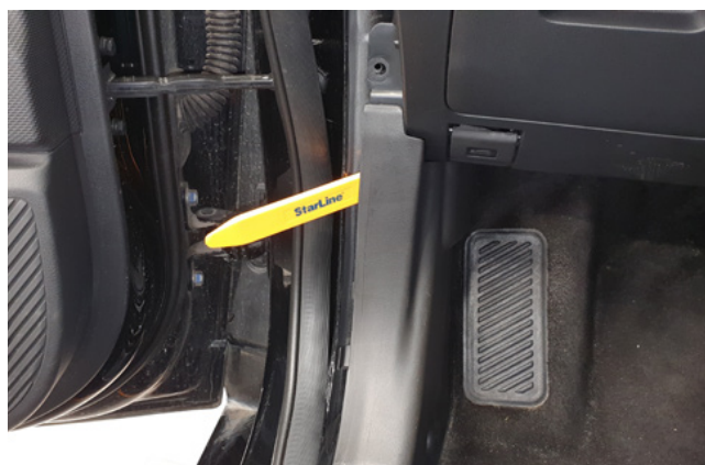
Фото 1.7. Снять накладку левой кик-панели
