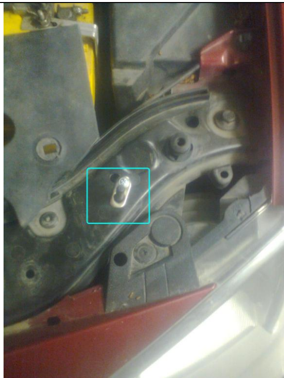
Фото 2.12. Концевик капота устанавливаем в имеющееся место на планке за левой фарой (по ходу движения).
