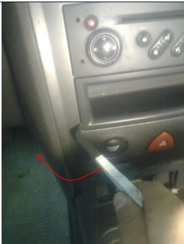
Фото 1.15. Вытаскиваем вкладыш-кармашек, подцепив его сбоку.
