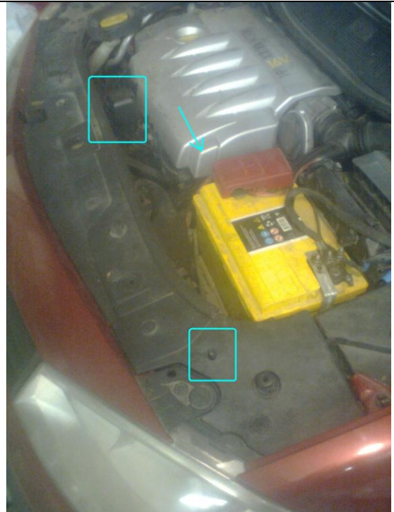
Фото 2.14. Окончательно вид на концевик и сирену (стрелочкой указано место, где находится датчик температуры).
