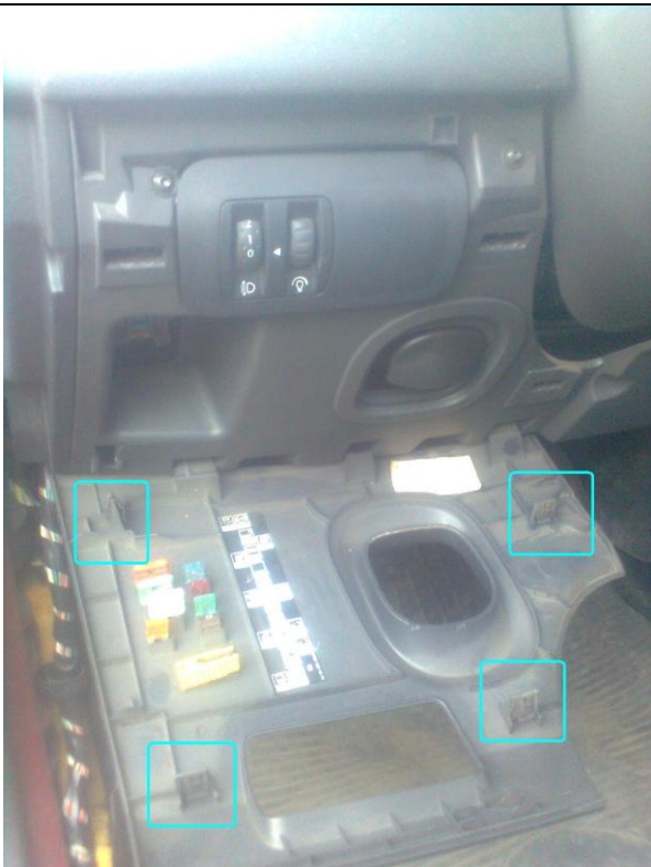
Фото 1.3. После этого откидываем крышку подторпедника, удерживаемую клипсами .
