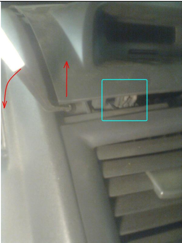
Фото 1.13. Снимаем центральную накладку панели над воздуховодами. Клипсы по периметру. Поднимать начинаем над воздуховодами.
