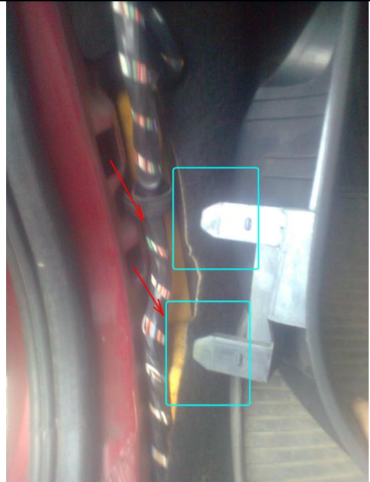
Фото 1.2. Снимаем накладку левой КИК-панели - зацепы.
