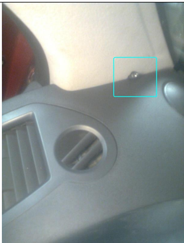
Фото 2.17. Устанавливаем светодиод в левой накладке стойки лобового стекла.
