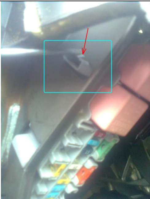
Фото 1.23. Отжимаем упор зацепа крепления блока предохранителей и реле в салоне слева в подторпеднике, выводим его из зацепления и откидываем вниз насколько позволят провода.
