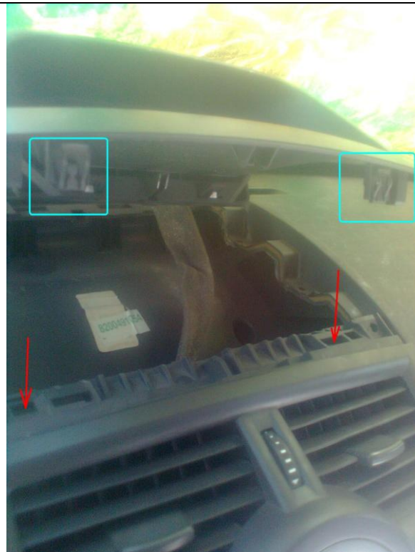
Фото 1.14. Накладка с полностью расцепленными клипсами и зацепами. Видны только передние, есть еще по бокам.
