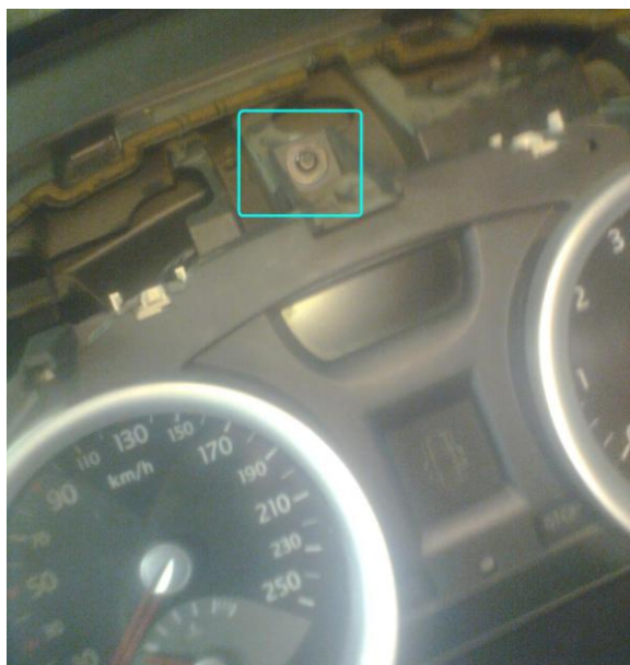
Фото 1.11. Выкручиваем саморез крепления приборной доски головкой TORX-T20.
