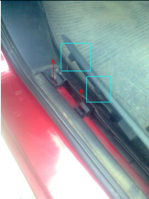
Фото1.1. Разборку начинаем с приподнятия накладки порога в проеме двери водителя для снятия левой накладки КИК-панели. Крепление – клипсы и зацепы.
