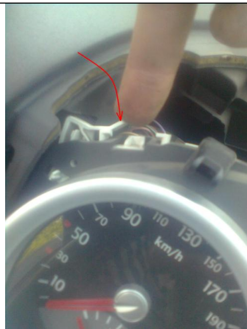
Фото 1.12. Для извлечения приборной доски нажимаем на усики с двух сторон одновременно, чтобы вывести упоры из зацепления и тянем доску вверх.
