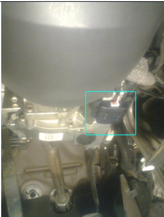
Фото 2.15. Датчик удара крепим на плоскости усилителя руля, приклеив его на скотч и зафиксировав хомутом-стяжкой.
