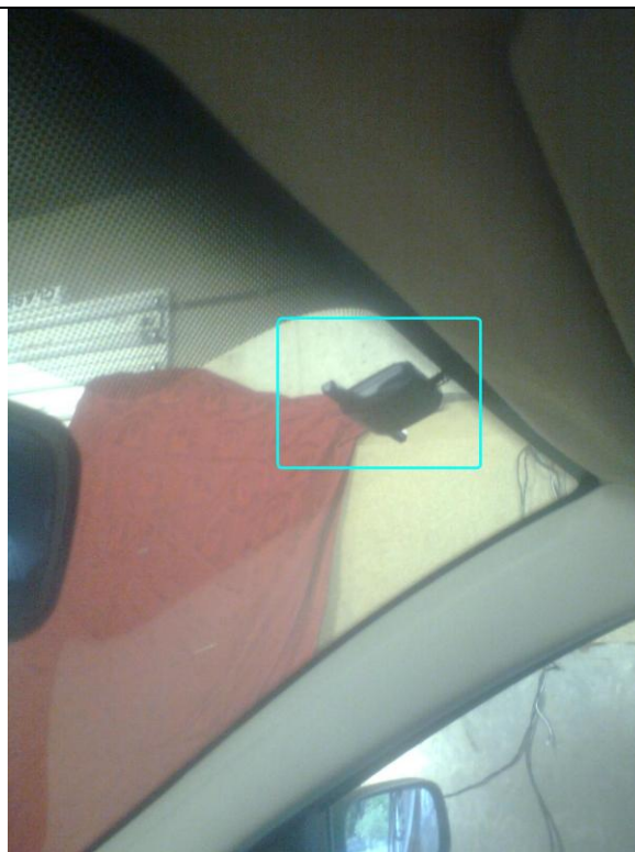
Фото 2.18. Модуль приемо-передатчика приклеиваем на чистый участок (без шелкографии) лобового стекла.
