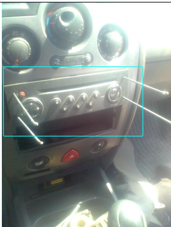
Фото 1.17. Вытаскиваем магнитолу, для выжима упоров-зацепов вставляем в отверстия круглые штыри-съемники. Идеально подходят тяги от электроприводов замков.
