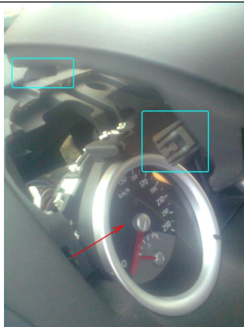
Фото 1.10. Сдергиваем козырек доски приборов. В передней части клипсы. Со стороны лобового стекла – зацепы.
