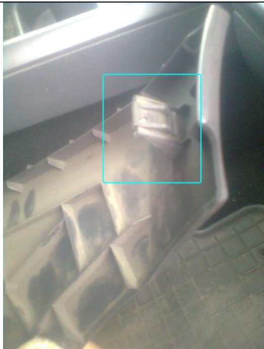
Фото 1.7. на правом верхнем углу панели подторпедника – жесткая клипса. Тянем этот угол осторожно.
