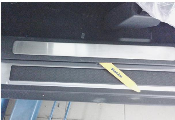
Фото 2.1. Снять накладку порога водительской двери
