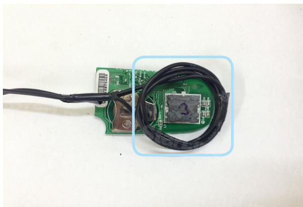
Фото 10.1. Расположение антенны модуля ВР-03 на ключе
