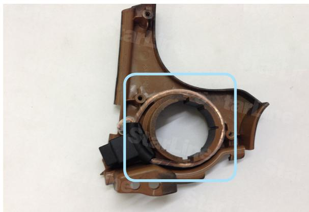
Фото 10.2. Расположение антенны модуля ВР-03 на кнопке Старт-Стоп
