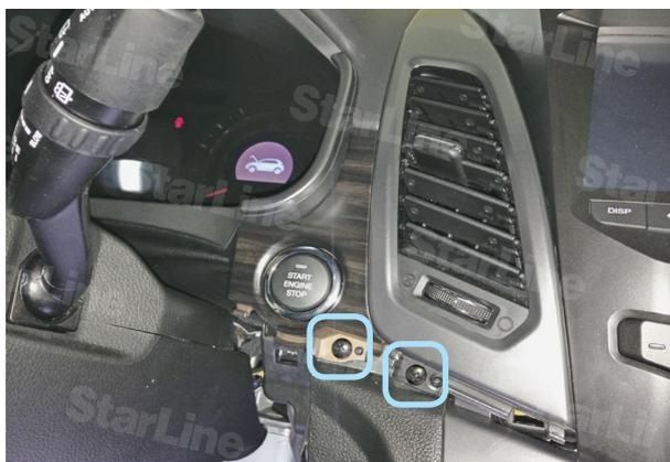
Фото 3.4. Декоративная накладка снята. Саморезы
