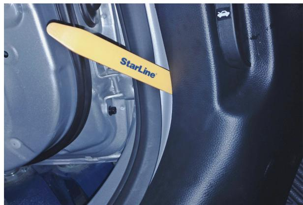
Фото 2.2. Снять пластиковую накладку кик-панели
