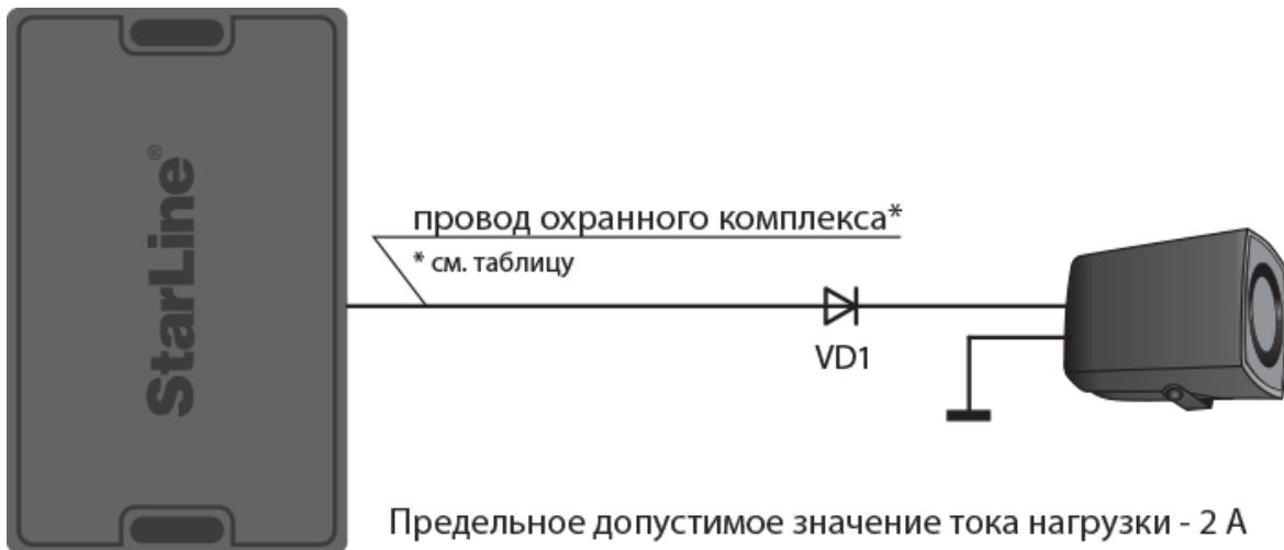
Схема подключения автомобильной сирены
