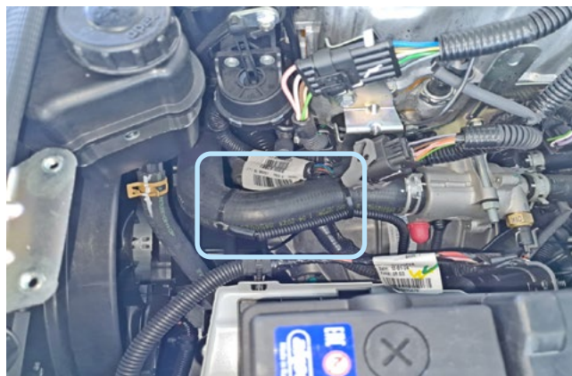
Фото 2.6. Крепление датчика температуры двигателя
