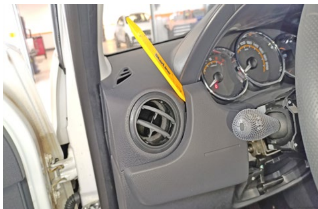
Фото 1.6. Снять пластиковую накладку слева от рулевой колонки
