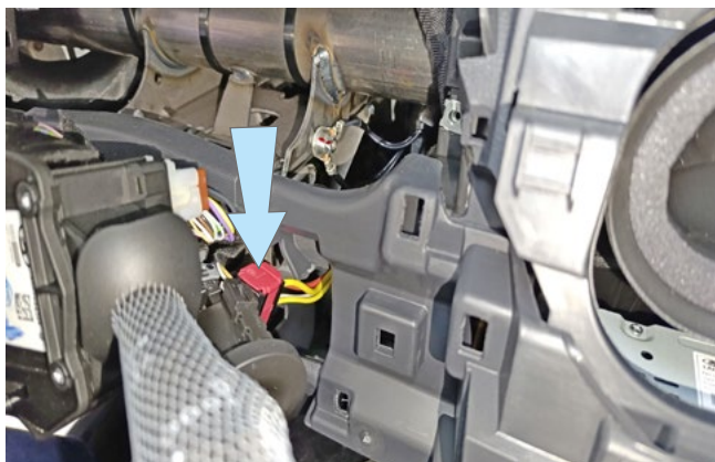
Фото 3.10. Местоположение разъёма замка зажигания
