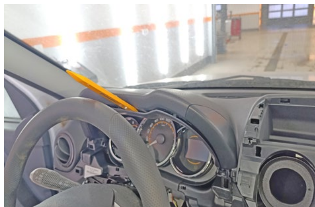
Фото 1.14. Снять декоративную накладку панели приборов
