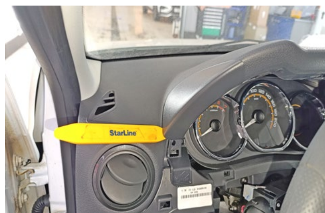
Фото 1.16. Снять накладку слева от панели приборов
