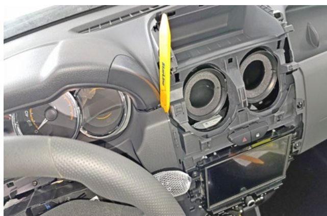
Фото 1.12. Снять пластиковую накладку справа от рулевой колонки
