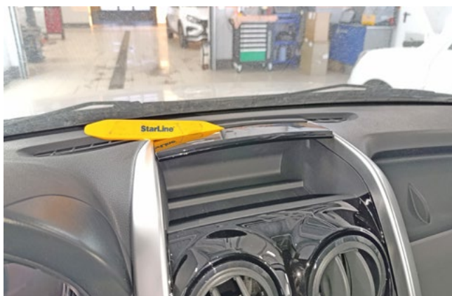
Фото 1.9. Снять пластиковую накладку в верхней части центральной консоли
