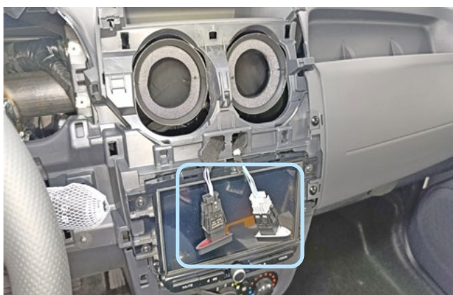
Фото 3.4. Местоположение кнопок управления центральным замком и аварийной сигнализацией
