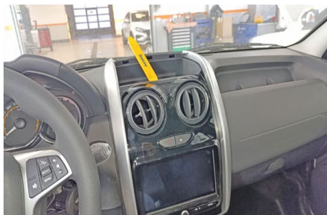
Фото 1.10. Снять декоративную накладку центральной консоли
