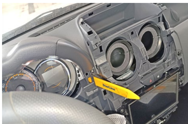
Фото 1.18. Снять накладку справа от панели приборов
