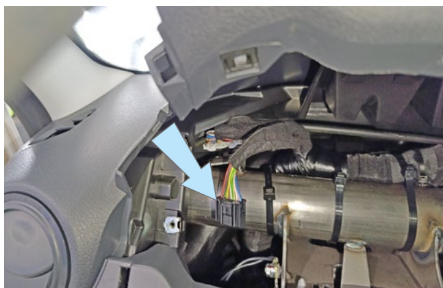
Фото 3.2. Местоположение разъёма панели приборов
