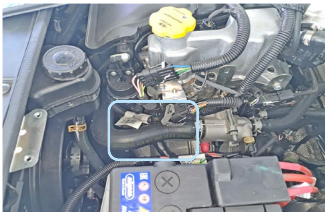
Фото 2.5. Место установки датчика температуры двигателя
