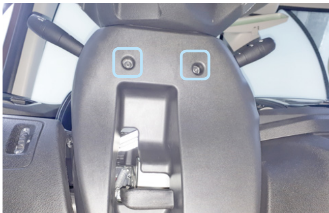
Фото 1.1. Саморезы крепления нижней части кожуха
