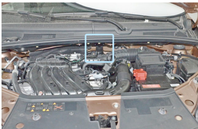
Фото 2.2. Возможное место установки сирены
