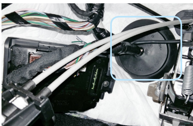
Фото 2.6. Штатный уплотнитель. Вид со стороны салона
