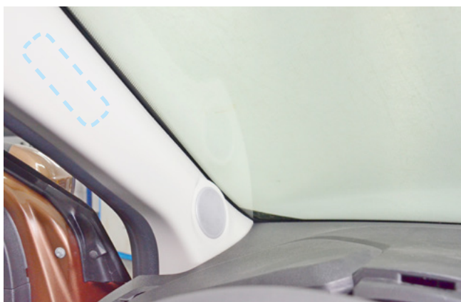
Фото 2.1. Возможное место установки антенного модуля
