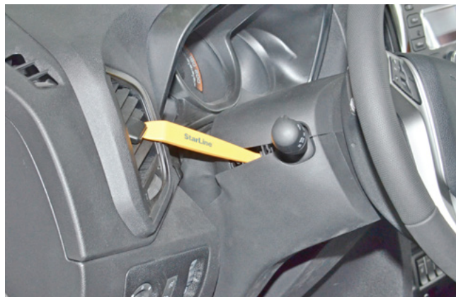
Фото 1.2. Снять кожух рулевого вала
