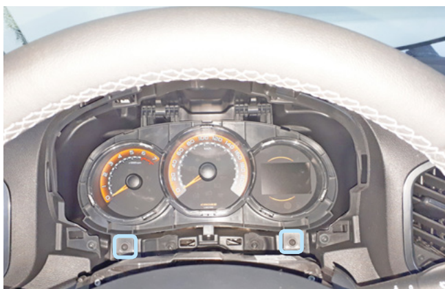
Фото 1.5. Саморезы крепления панели приборов
