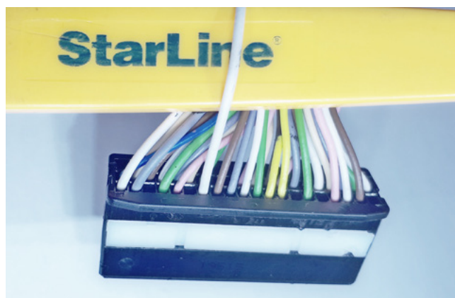
Фото 3.18. Управление подогревом заднего стекла и боковых зеркал (белый)
