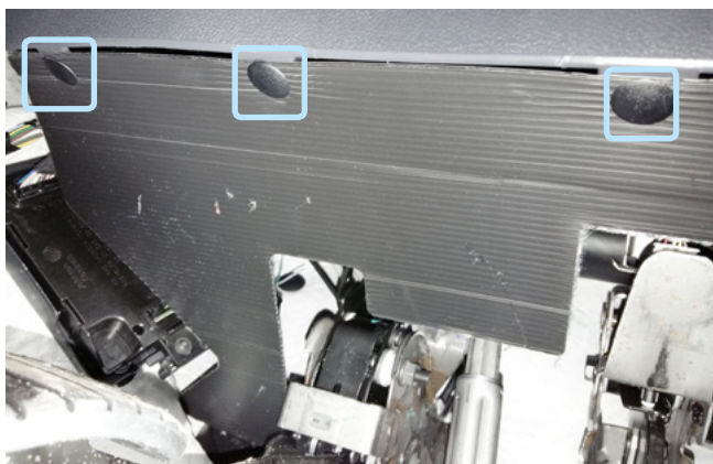
Фото 1.7 Клипсы крепления декоративной накладки педального узла
