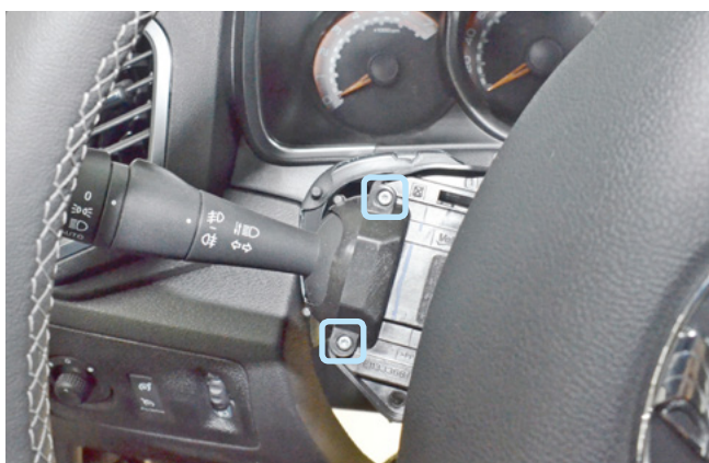
Фото 1.3. Саморезы крепления ручки управления
