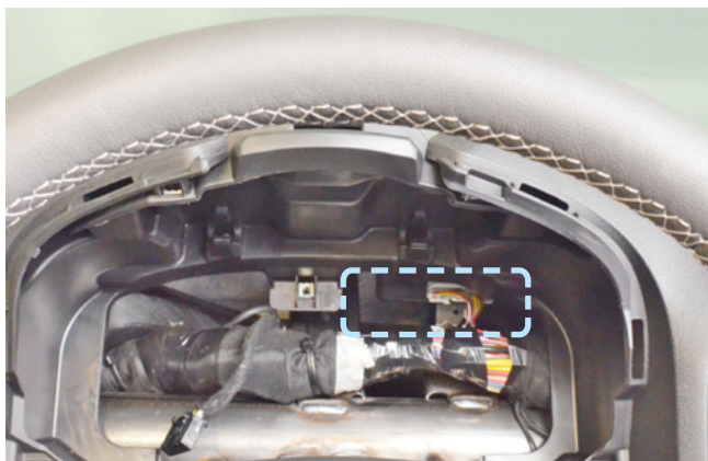
Фото 2.8. Пример расположения центрального блока охранно-телематического комплекса
