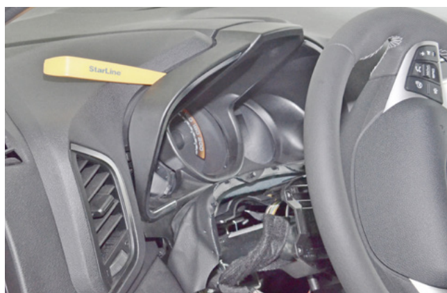
Фото 1.4. Снять накладку панели приборов
