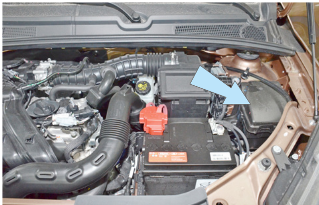
Фото 2.7. Возможное место установки подкапотного блока R6
