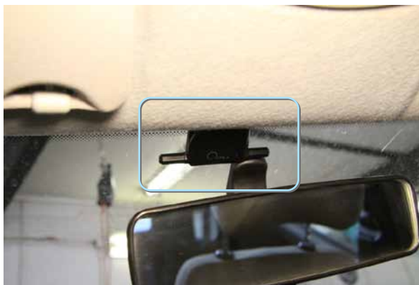
Фото 3.3. Антенна на лобовом стекле
