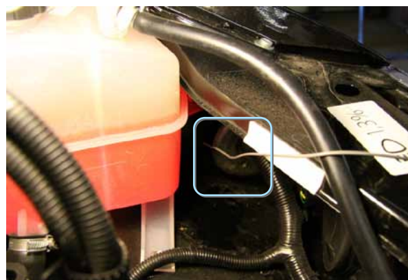
Фото 5.2. Выход проводов под капотом
