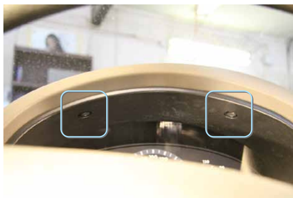
Фото 2.1. Крепление облицовки приборного щитка
