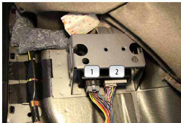
Фото 10.2. БУС. Нумерация разъемов заводская
