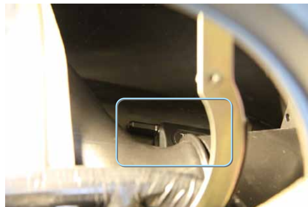
Фото 3.4. Антенна за приборным щитком
