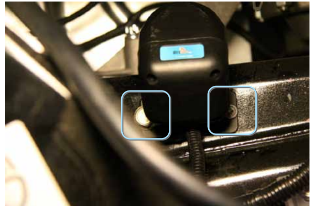
Фото 4.2. Сирена. Крепление на болт М8 и саморез
