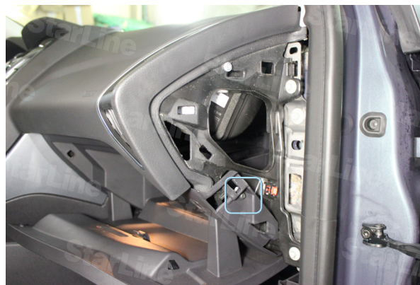
Фото 3.2. Накладка торпеды снята, саморез
