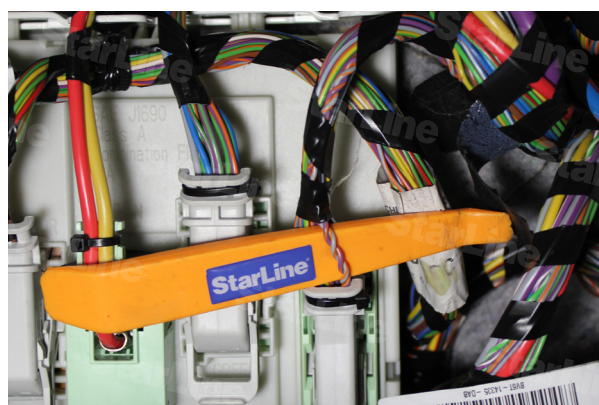
Фото 9. CAN-шина (CAN-H серо-оранжевый; CAN-L фиолетово-оранжевый)
