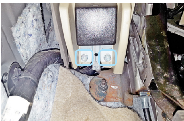
Фото 1.3. Болты крепления ручки отпирания капота
