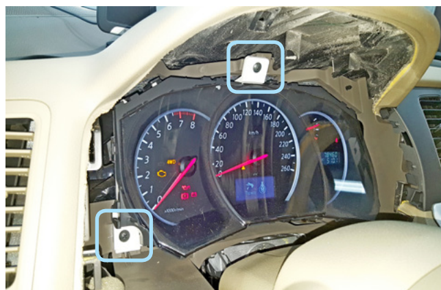
Фото 1.7. Саморезы крепления панели приборов
