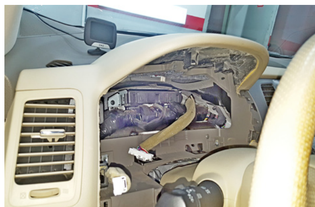
Фото 1.9. Панель приборов снята
