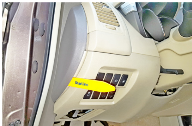
Фото 1.2. Снять боковую накладку передней панели
