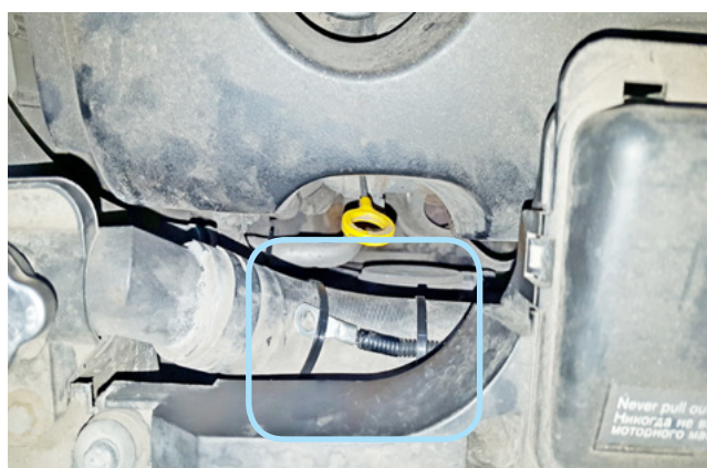
Фото 2.4. Крепление датчика температуры двигателя
