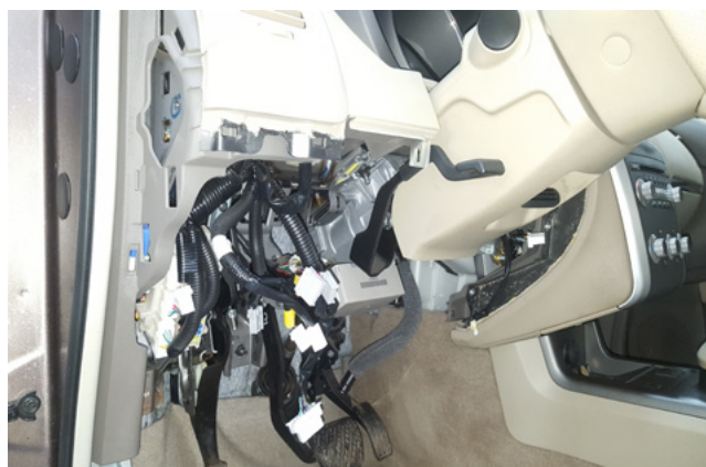
Фото 1.4. Пластиковая накладка под рулевой колонкой снята
