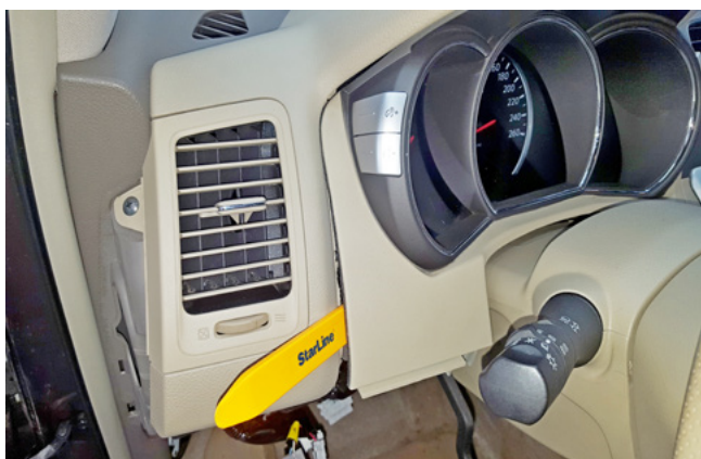
Фото 1.6. Снять декоративную накладку панели приборов
