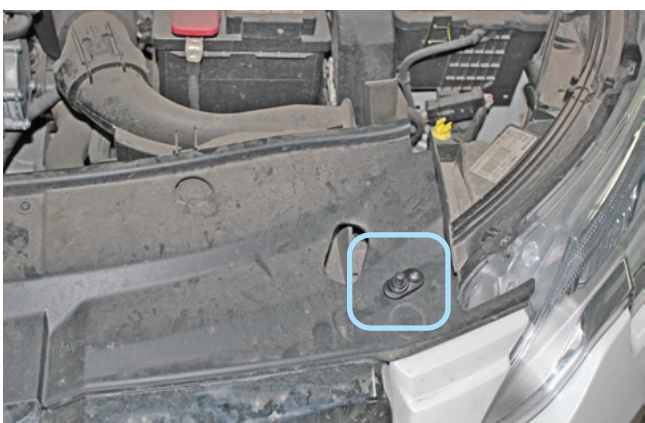
Фото 2.6. Возможное место установки концевика капота
