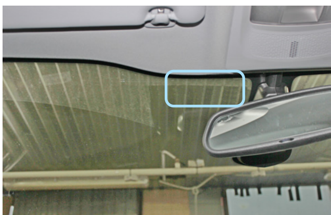
Фото 2.1. Возможное место установки антенного модуля
