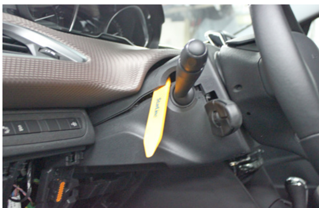
Фото 1.6. Снять верхнюю часть кожуха
