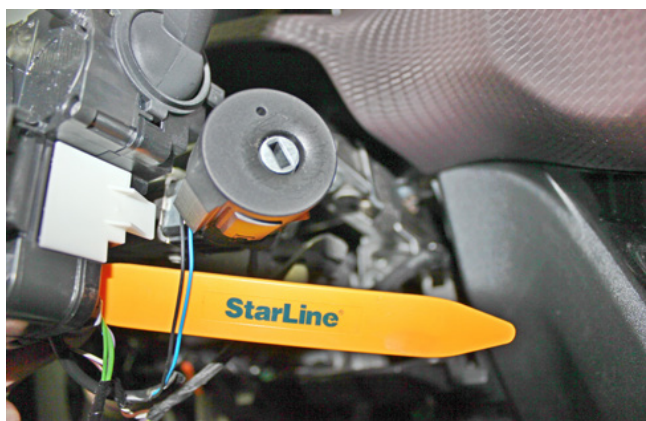
Фото 3.14. Провода антенны штатного иммобилайзера (чёрный и синий)
