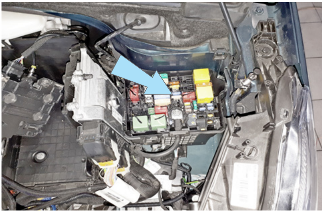
Фото 2.8. Возможное место установки подкапотного блока R6
