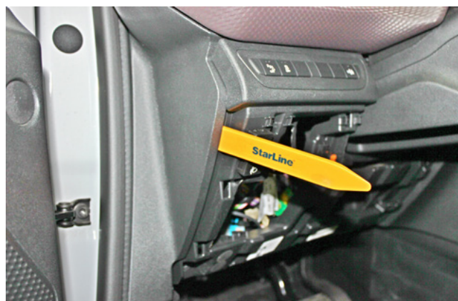
Фото 1.2. Снять боковую накладку передней панели
