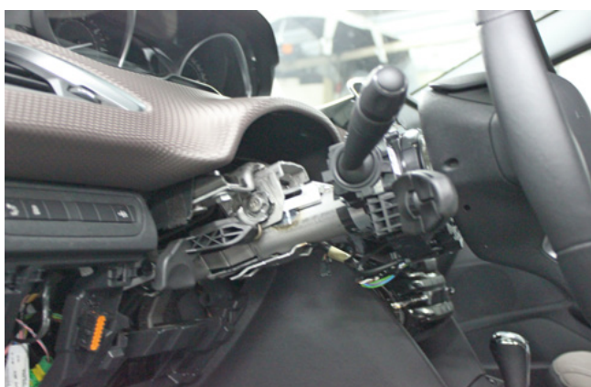
Фото 1.8. Кожух рулевого вала снят
