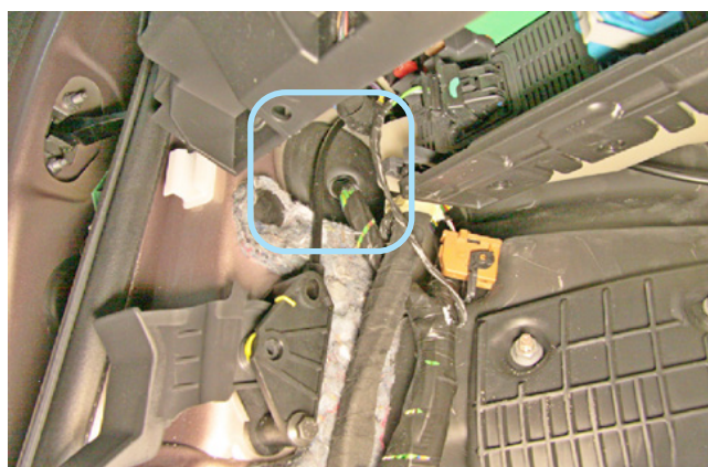
Фото 2.7. Штатный уплотнитель. Вид со стороны салона
