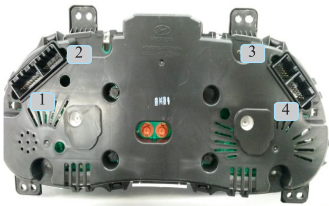
Фото 3.2. Условная нумерация разъёмов панели приборов
