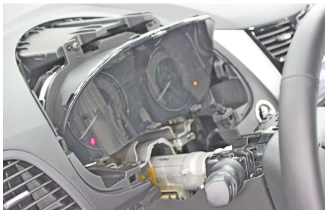
Фото 1.9. Накладка панели приборов снята
