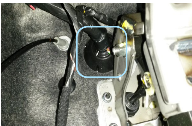
Фото 2.6. Штатный уплотнитель. Вид со стороны салона
