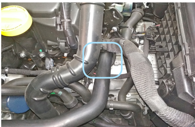
Фото 2.3. Место установки датчика температуры двигателя
