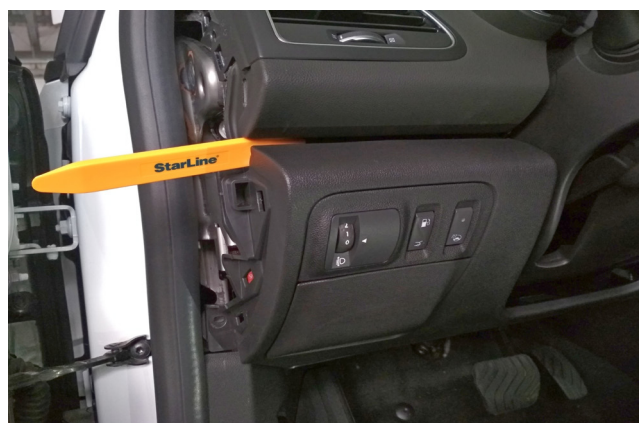
Фото 1.4. Снять пластиковую накладку под рулевой колонкой
