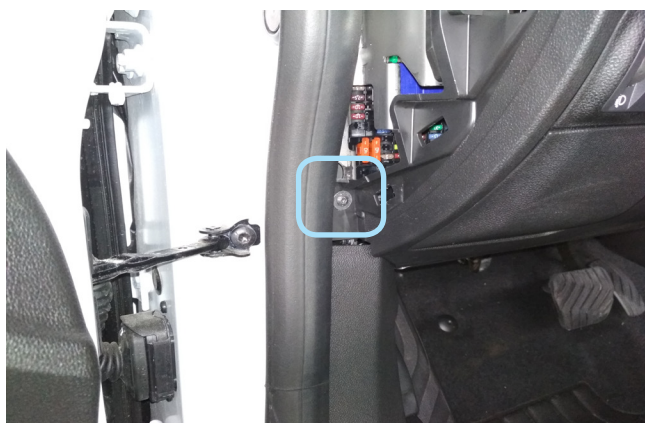
Фото 1.3. Накладка снята. Саморез крепления пластиковой накладки под рулевой колонкой
