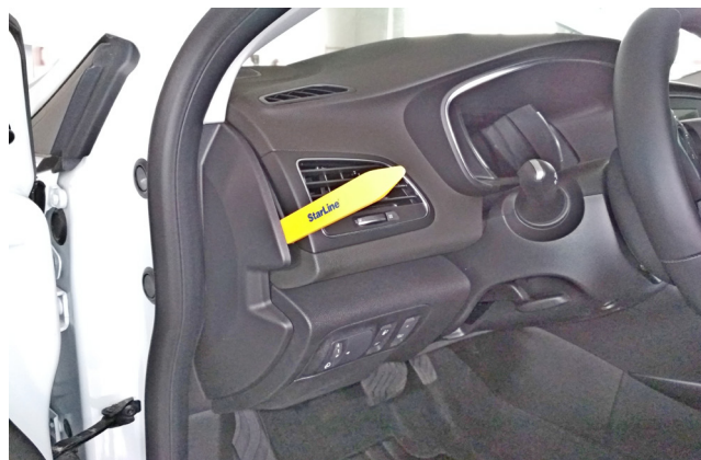
Фото 1.2. Снять боковую накладку передней панели
