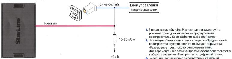
Подключение предпусковых подогревателей Webasto с управлением по цифровой шине
