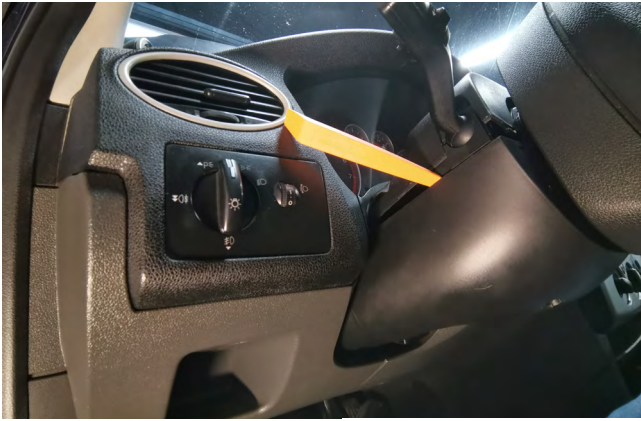
Фото 1.7. Снять нижнюю часть кожуха рулевой колонки
