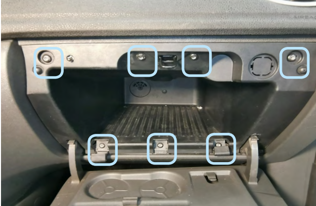
Фото 1.1. Саморезы крепления перчаточного ящика.
