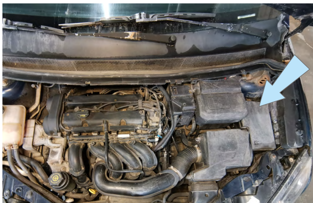
Фото 2.7. Возможное место установки подкапотного блока R6
