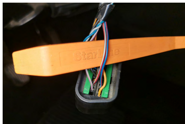
Фото 3.5. Шина CAN-B (серо-красный и сине-красный)
