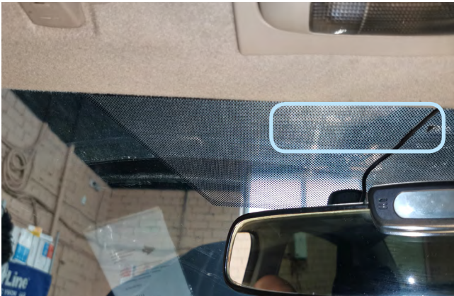
Фото 2.1. Возможное место установки антенного модуля.
