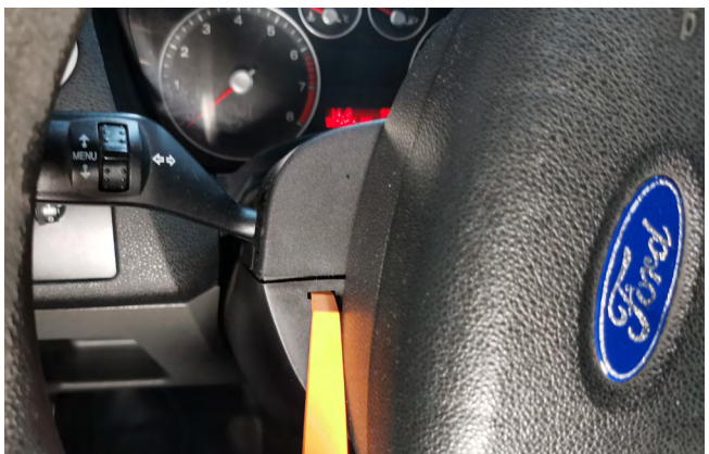
Фото 1.6. Снять верхнюю кожуха рулевой колонки.
