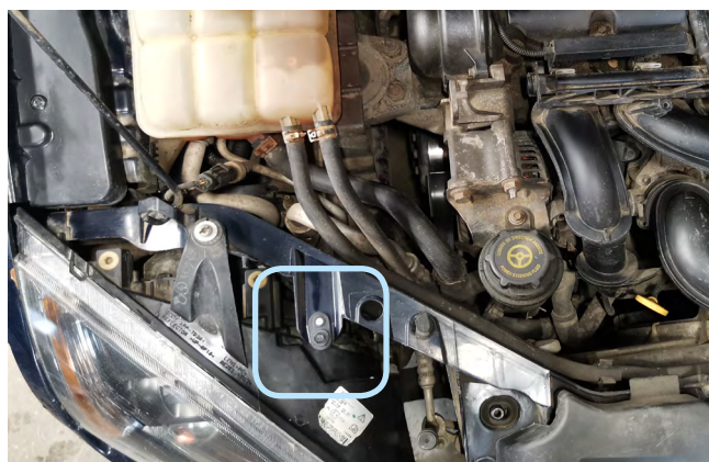
Фото 2.6. Возможное место установки концевика капота
