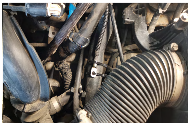
Фото 2.5. Крепление датчика температуры двигателя
