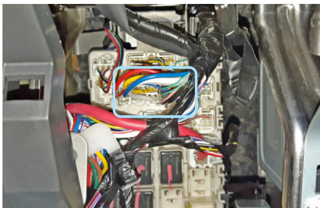
Фото 3.6. Местоположение разъёма на блоке ETACS
