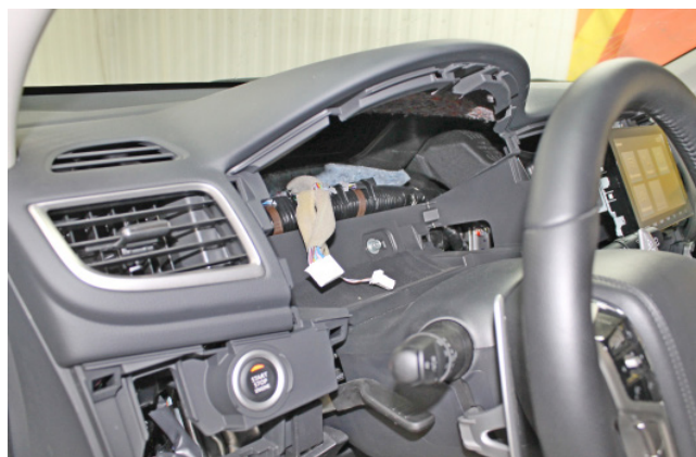
Фото 1.20. Панель приборов снята
