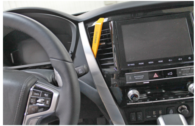
Фото 1.14. Снять декоративную накладку
