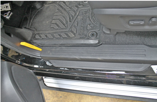
Фото 1.7. Снять пластиковую накладку порога двери водителя
