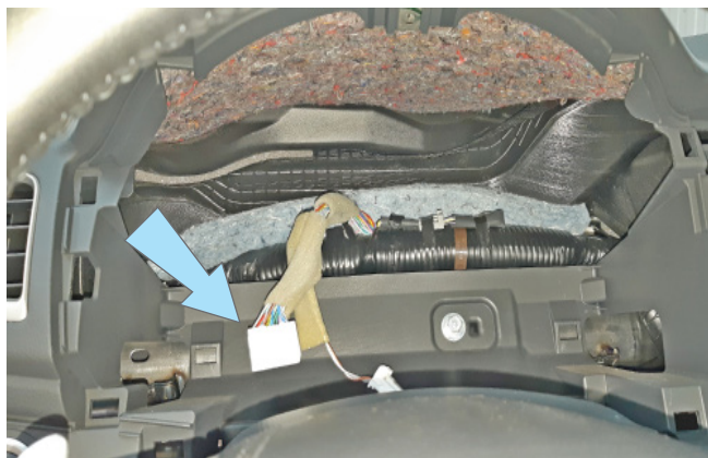
Фото 3.2. Местоположение разъёма панели приборов
