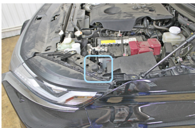
Фото 2.6. Возможное место установки концевика капота
