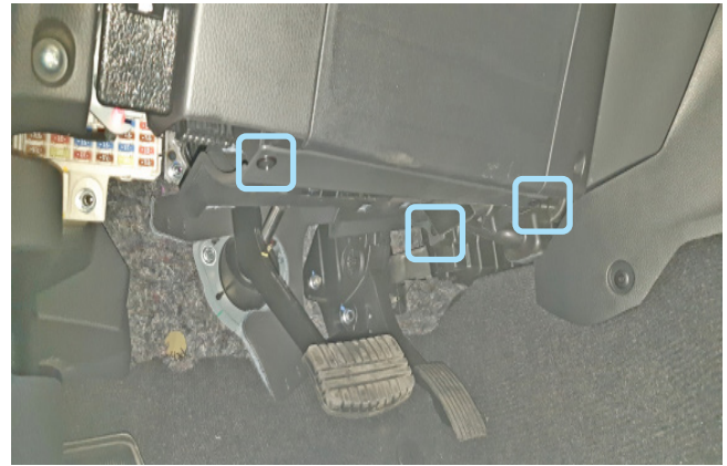
Фото 1.2. Клипсы крепления декоративной накладки педального узла
