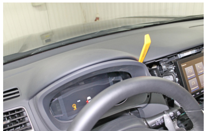
Фото 1.18. Снять декоративную накладку панели приборов
