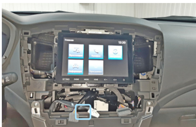
Фото 3.4. Местоположение белого разъёма блока климатической системы
