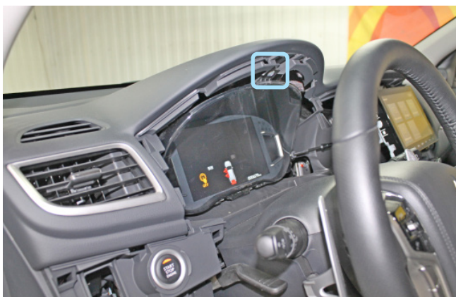
Фото 1.19. Накладка панели приборов снята. Саморез крепления панели приборов
