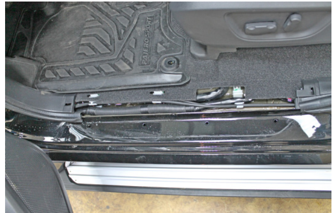
Фото 1.8. Пластиковая накладка порога двери водителя снята
