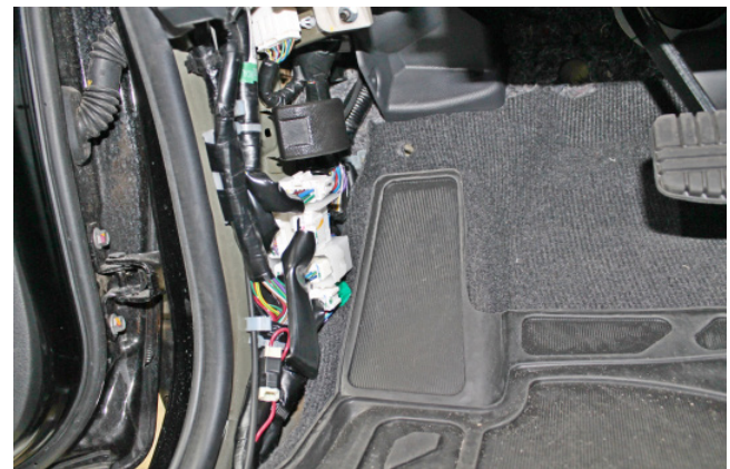
Фото 1.10. Пластиковая накладка левой кик-панели снята
