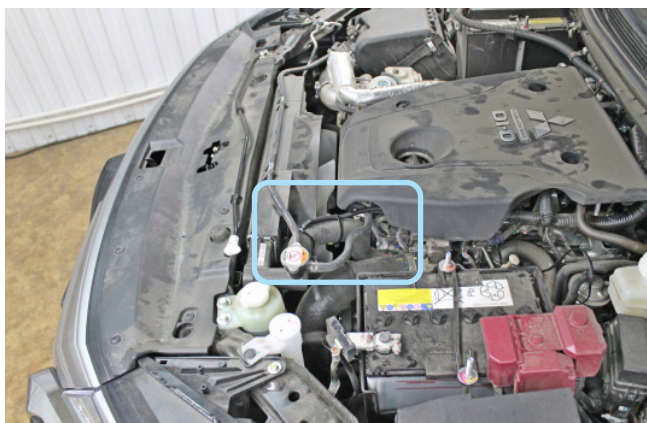
Фото 2.4. Место установки датчика температуры двигателя
