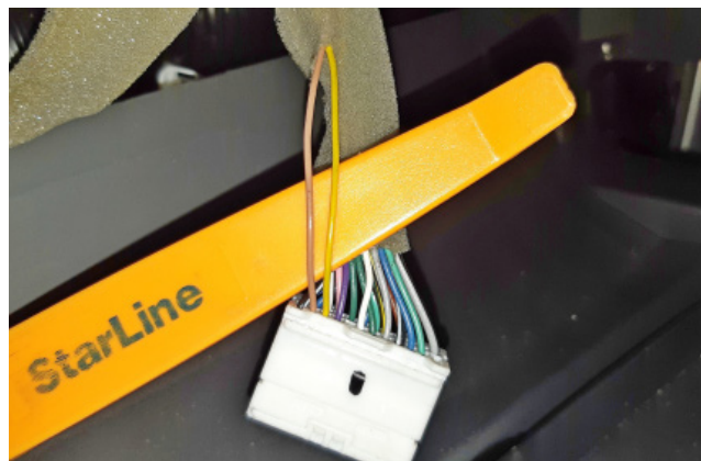
Фото 3.3. Шина CAN-A (коричневый и жёлтый)
