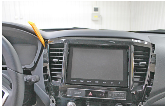
Фото 1.16. Снять блок управления климатической системой
