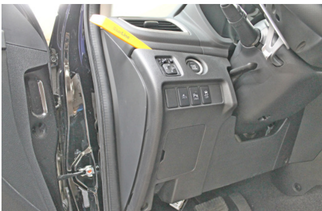
Фото 1.5. Снять пластиковую накладку слева от рулевой колонки
