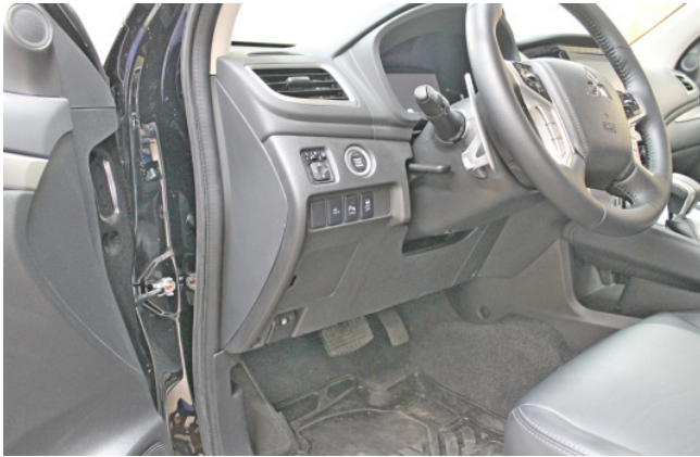
Фото 1.1. Пластиковая накладка слева от рулевой колонки
