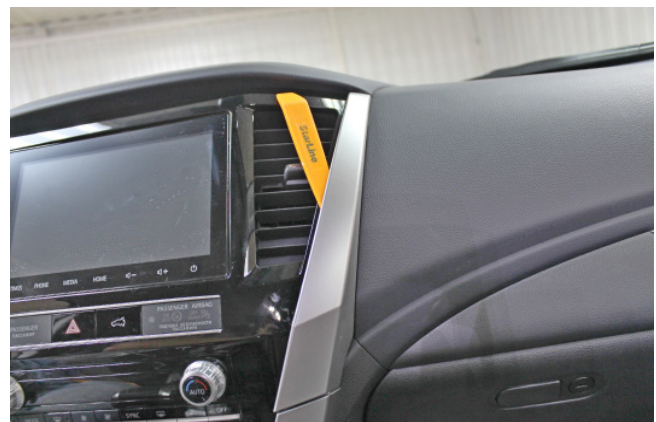
Фото 1.12. Снять декоративную накладку
