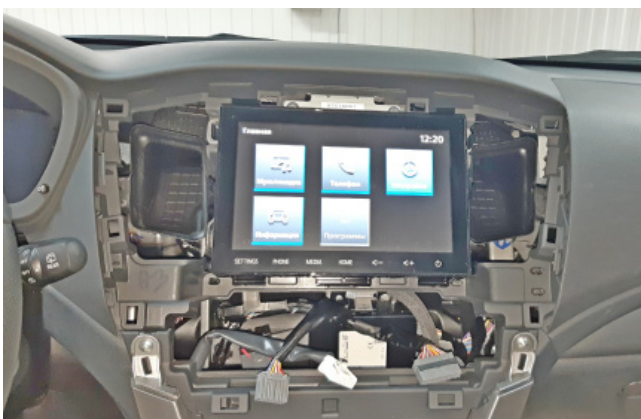
Фото 1.17. Блок управления климатической системой снят
