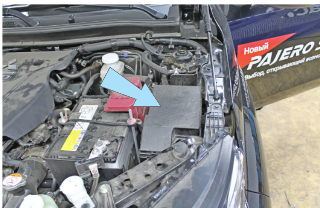
Фото 2.8. Возможное место установки подкапотного блока R6
