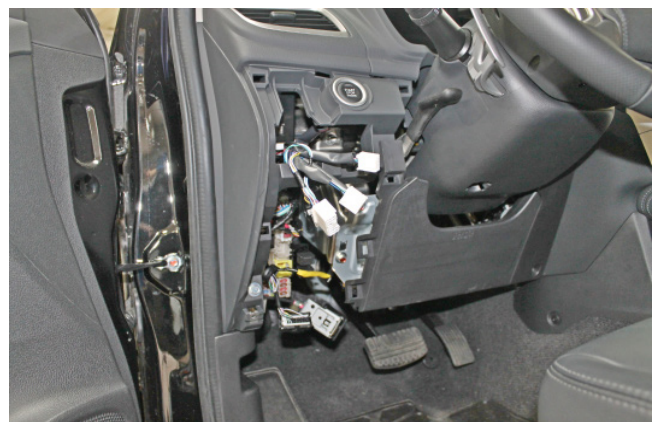
Фото 1.6. Пластиковая накладка слева от рулевой колонки снята
