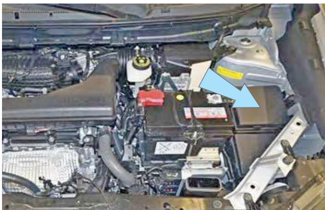
Фото 2.11. Возможное место установки подкапотного блока R6
