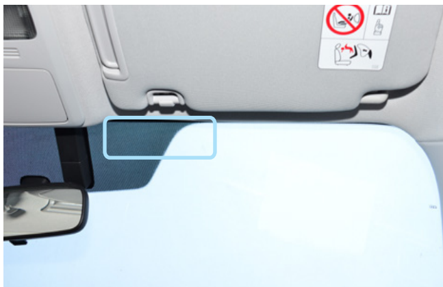
Фото 2.1. Возможное место установки антенного модуля
