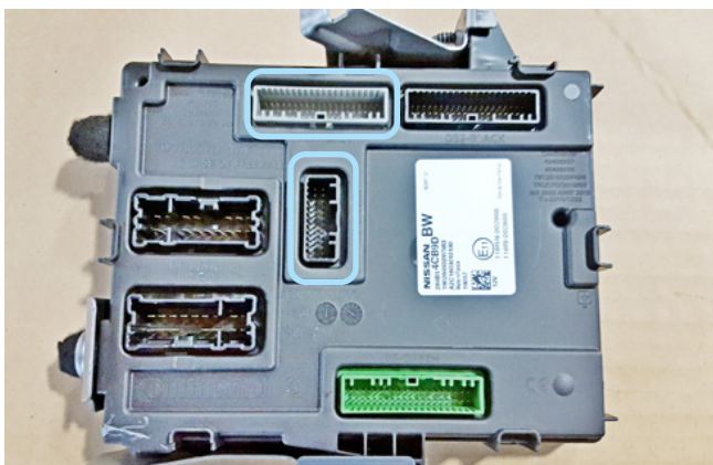
Фото 3.7. Местоположение разъёмов на блоке BCM
