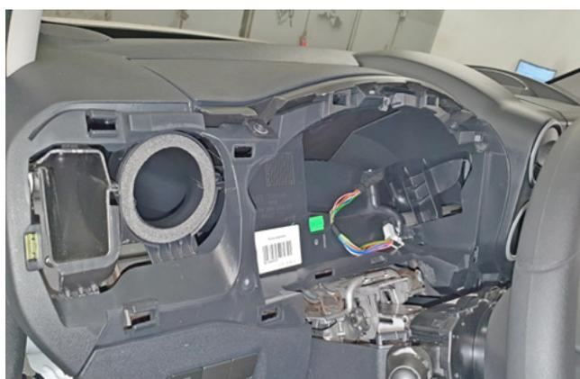
Фото 1.17. Панель приборов снята
