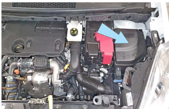
Фото 2.9. Возможное место установки подкапотного блока R6
