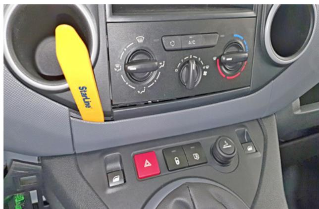
Фото 1.13. Снять нижнюю накладку центральной консоли
