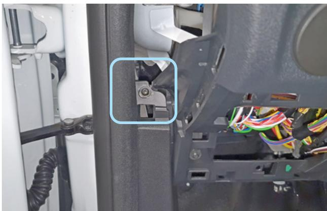
Фото 1.6. Саморез крепления накладки левой кик-панели
