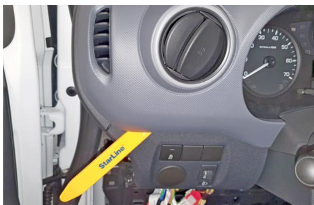
Фото 1.14. Снять декоративную накладку панели приборов
