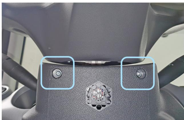
Фото 1.11. Саморезы крепления нижней части кожуха рулевого вала
