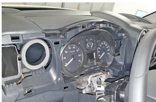
Фото 1.15. Декоративная накладка панели приборов снята
