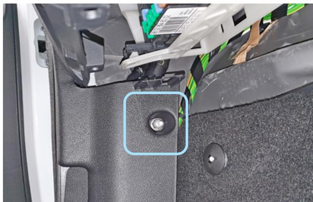
Фото 1.7. Гайка крепления накладки левой кик-панели
