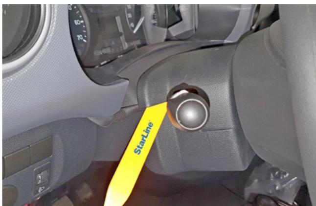
Фото 1.12. Снять верхнюю часть кожану рулевого вала
