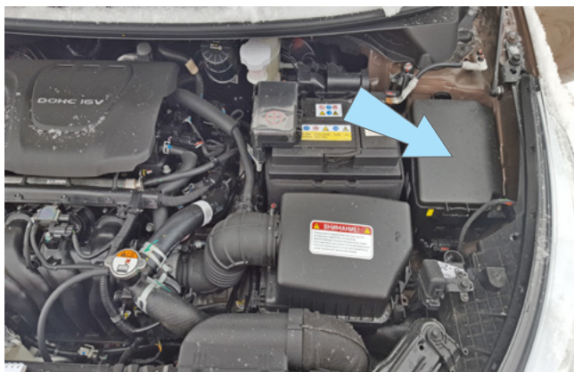
Фото 2.6. Возможное место установки подкапотного блока R6
