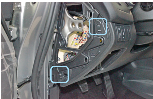
Фото 1.3. Накладка снята. Саморезы
