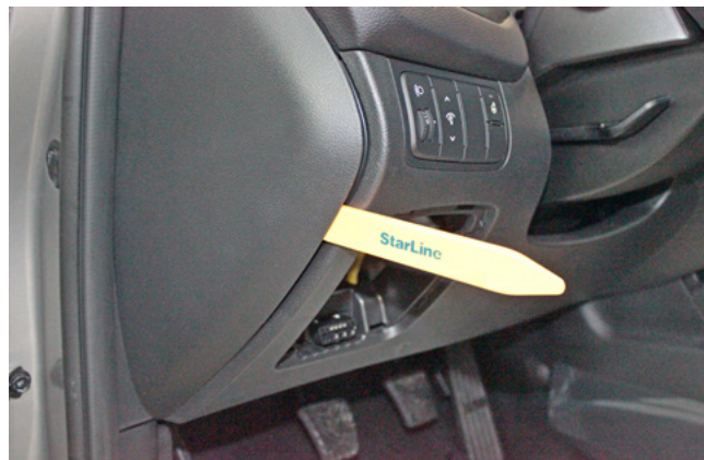
Фото 1.2. Снять левую накладку передней панели
