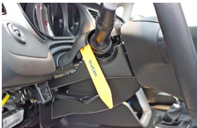
Фото 1.13. Снять верхнюю часть кожуха рулевого вала
