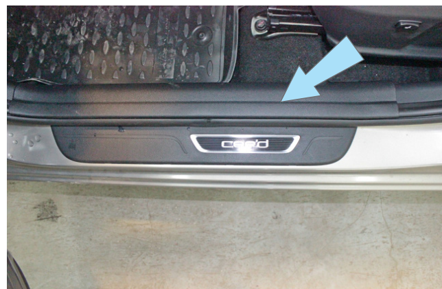
Фото 1.6. Накладка порога двери водителя
