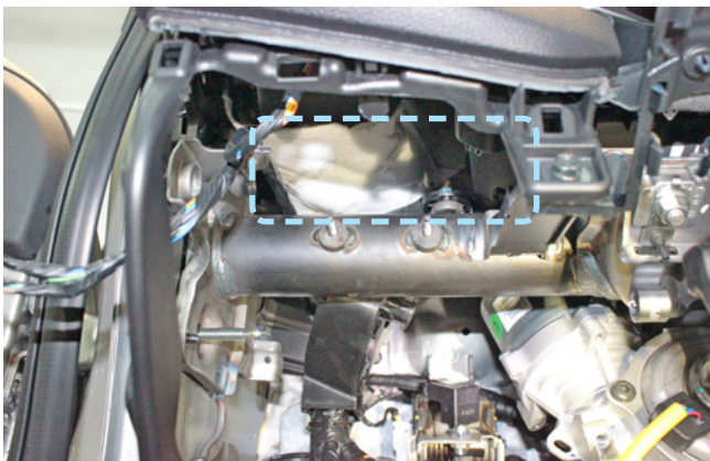
Фото 2.7. Пример расположения центрального блока охранно-телематического комплекса
