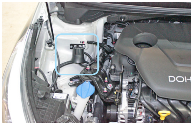
Фото 2.1. Возможное место установки сирены
