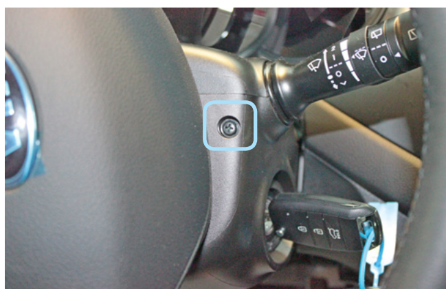
Фото 1.11. Саморез крепления кожуха рулевого вала справа
