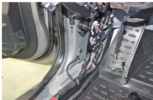
Фото 1.8. Накладка кик-панели снята
