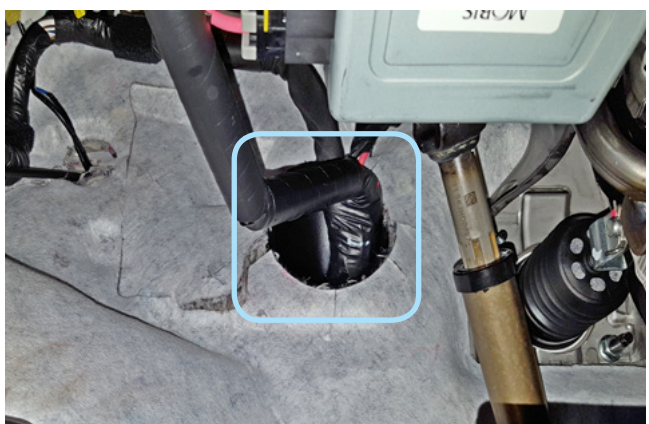
Фото 2.5. Штатный уплотнитель. Вид со стороны салона
