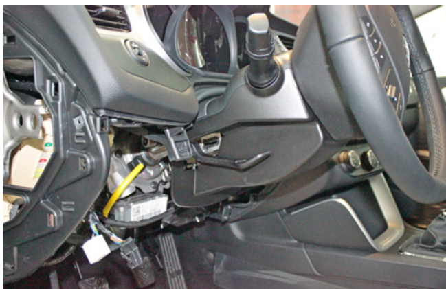
Фото 1.9. Кожух рулевого вала. Общий вид
