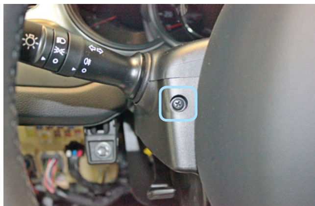
Фото 1.10. Саморез крепления кожуха рулевого вала слева
