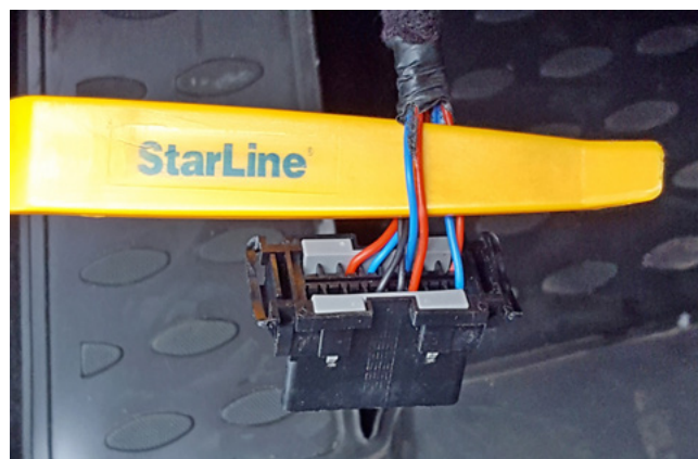
Фото 3.5. Шина CAN-B (красный и синий)
