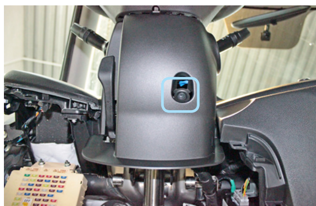
Фото 1.12. Саморез крепления кожуха рулевого вала снизу
