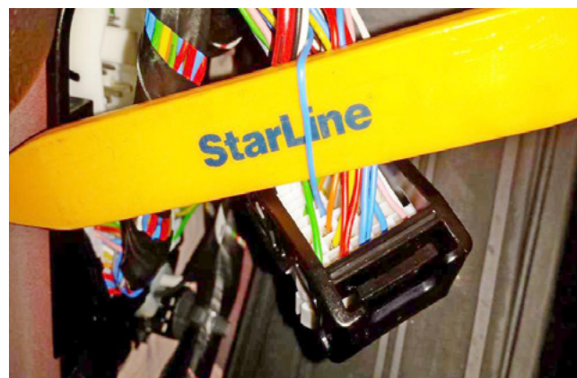
Фото 3.7. Шина данных штатного иммобилайзера (синий)
