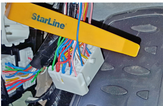
Фото 3.8. Контроль работы двигателя (синий)
