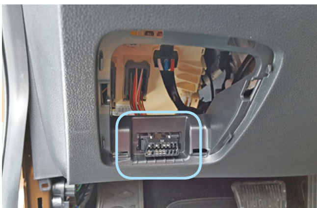
Фото 3.4. Местоположение диагностического разъёма
