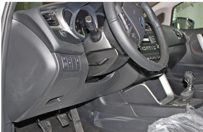
Фото 1.1. Пластиковая накладка под рулевой колонкой. Общий вид
