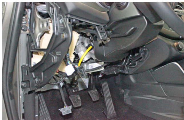
Фото 1.4. Пластиковая накладка под рулевой колонкой снята
