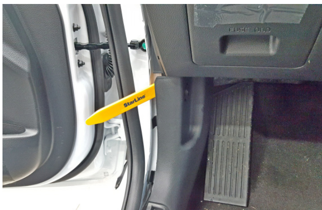
Фото 1.5. Снять накладку левой кик-панели
