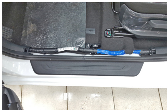
Фото 1.4. Накладка порога двери водителя снята
