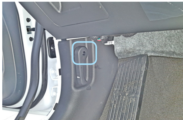
Фото 1.2. Крепление ручки отпирания капота
