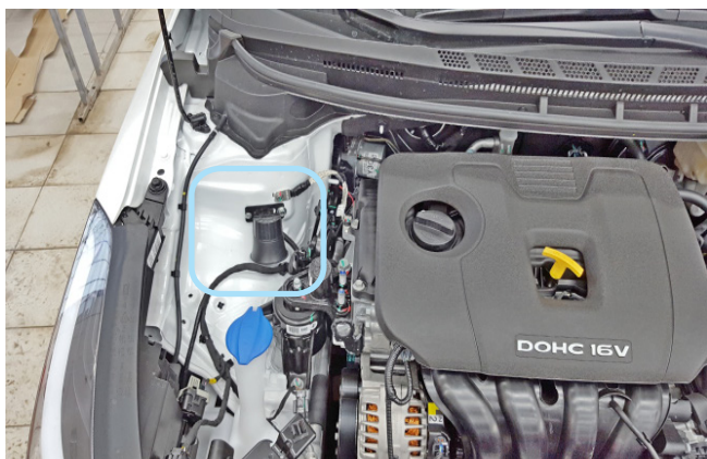
Фото 2.3. Возможное место установки сирены
