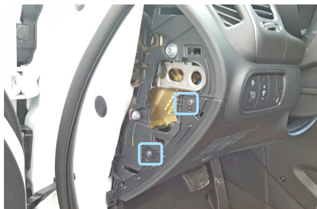
Фото 1.8. Накладка снята. Саморезы
