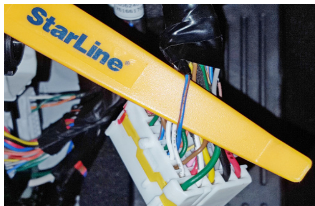
Фото 3.7. Шина данных штатного иммобилайзера (сине-оранжевый)
