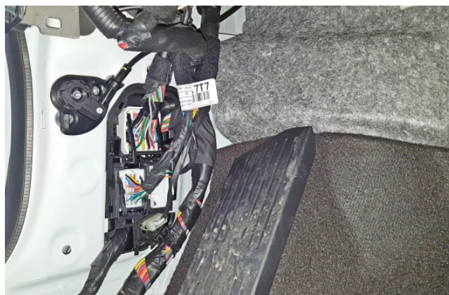
Фото 1.6. Накладка левой кик-панели снята
