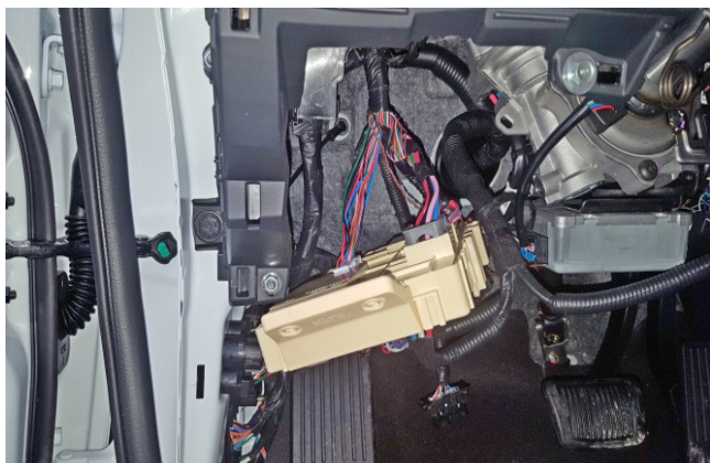
Фото 1.13. Монтажный блок предохранителей снят
