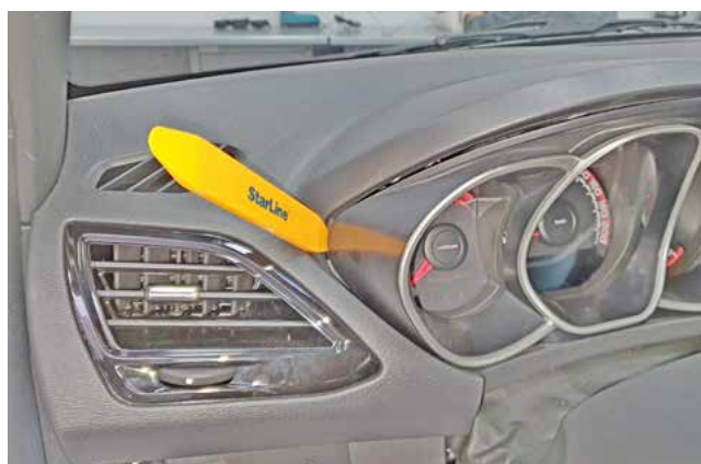
Фото 1.6. Снять накладку панели приборов
