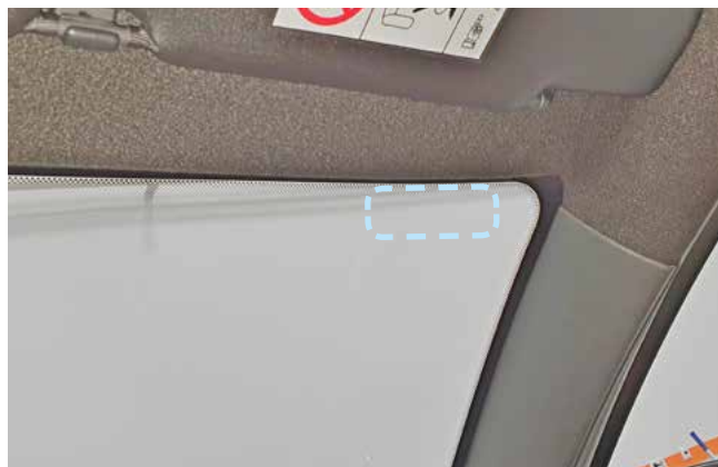
Фото 2.1. Возможное место установки антенного модуля
