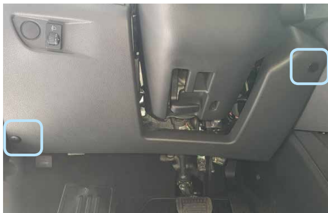
Фото 1.1. Клипсы крепления накладки под рулевой колонкой
