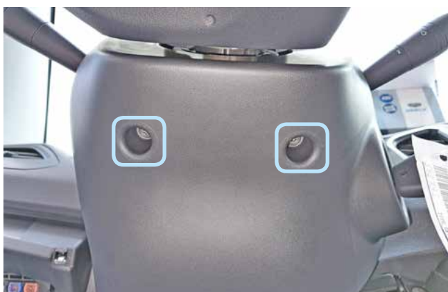
Фото 1.3. Саморезы крепления кожуха рулевого вала
