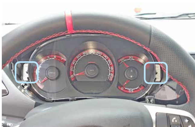
Фото 1.7. Саморезы крепления панели приборов
