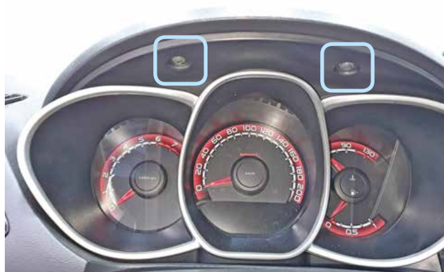
Фото 1.5. Саморезы крепления накладки панели приборов
