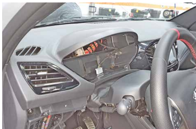
Фото 1.8. Панель приборов снята
