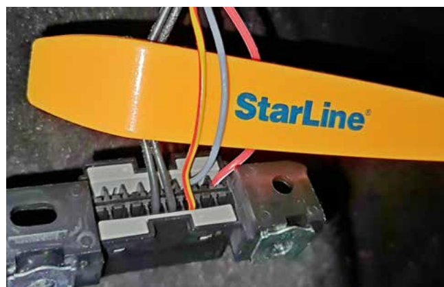
Фото 3.4. Шина CAN-A (жёлто-красный и серый)
