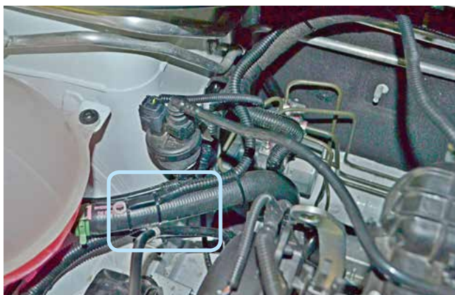
Фото 2.4. Место установки датчика температуры двигателя
