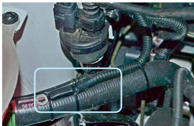
Фото 2.5. Крепление датчика температуры двигателя
