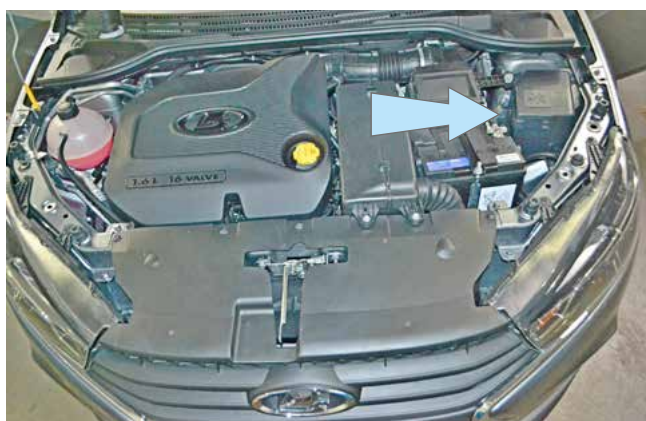
Фото 2.7. Возможное место установки подкапотного блока R6
