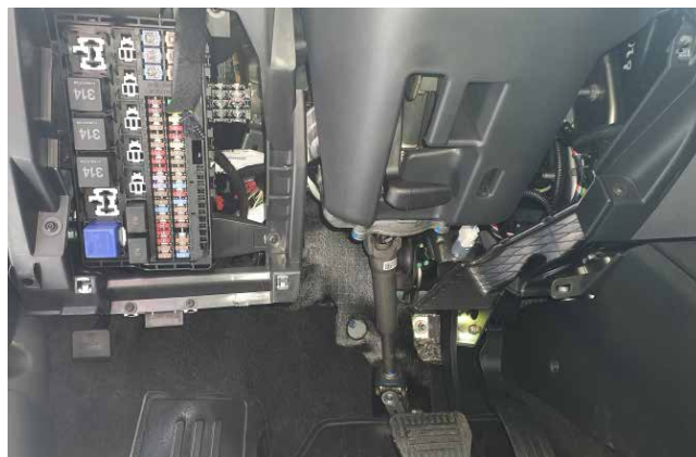
Фото 1.2. Накладка под рулевой колонкой снята
