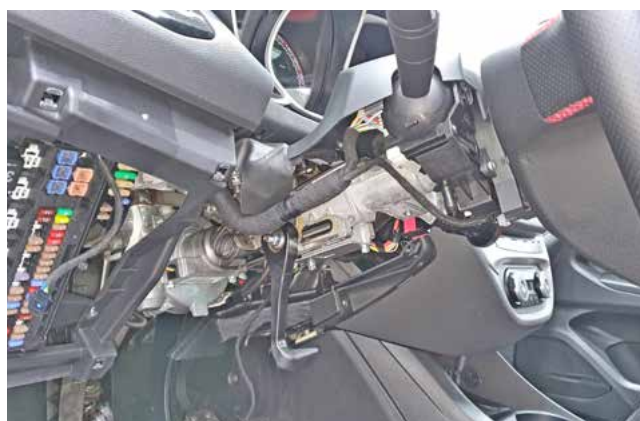
Фото 1.4. Нижняя часть кожуха рулевого вала снята
