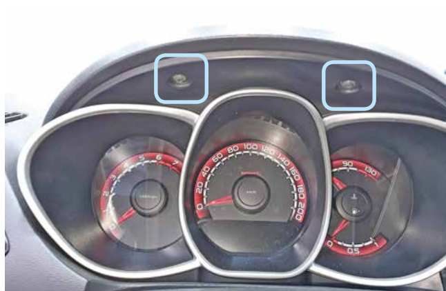
Фото 1.5. Саморезы крепления накладки панели приборов
