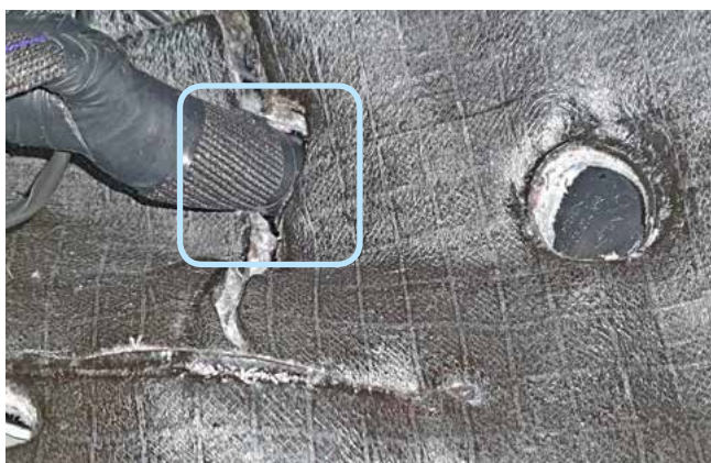
Фото 2.6. Штатный уплотнитель. Вид со стороны салона
