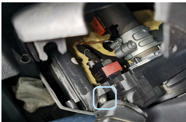
Фото 1.11. Саморез крепления нижней накладки
