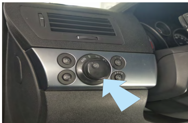
Фото 1.2. Блок переключателя света
