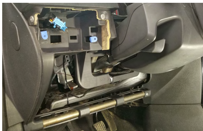
Фото 1.5. Пластиковая накладка под рулевой колонкой снята
