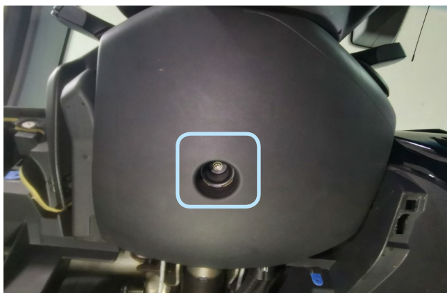
Фото 1.13. Саморез крепления нижней накладки
