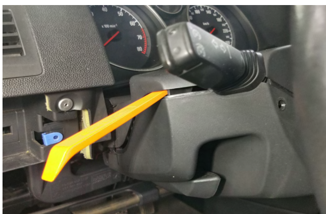
Фото 1.9. Снять верхнюю накладку рулевого кожуха
