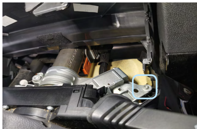
Фото 1.12. Саморез крепления нижней накладки
