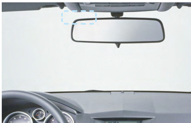
Фото 2.1. Возможное место установки антенного модуля
