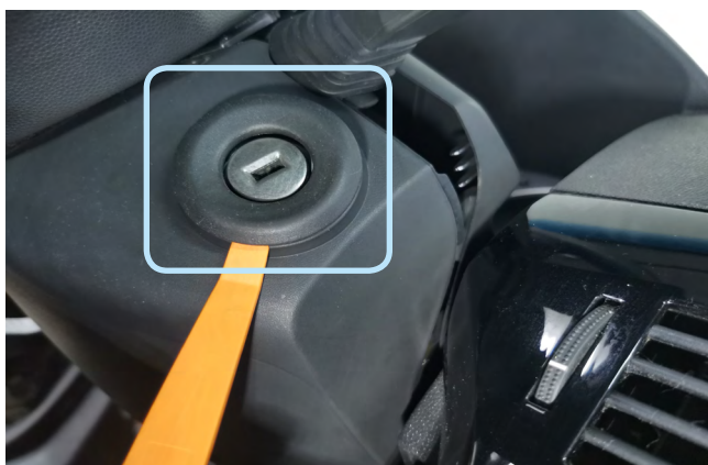
Фото 1.10. Снять накладку замка зажигания
