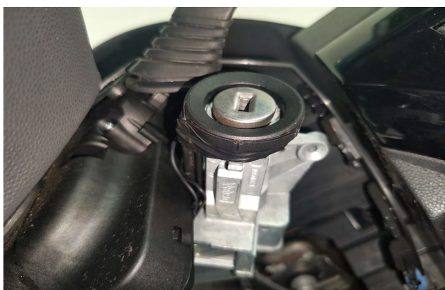
Фото 3.11. Расположение антенны модуля BP-03/04 на замке зажигания
