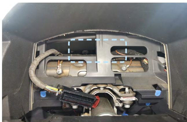
Фото 2.8. Пример расположения центрального блока охранно-телематического комплекса
