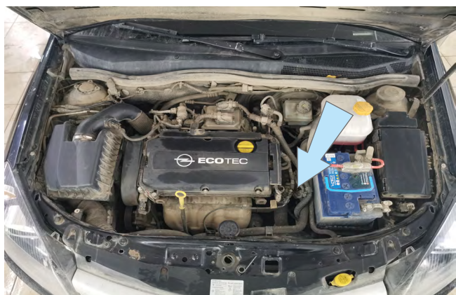
Фото 2.4. Место установки датчика температуры двигателя
