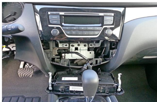
Фото 1.13. Блок управления климат-контролем снят
