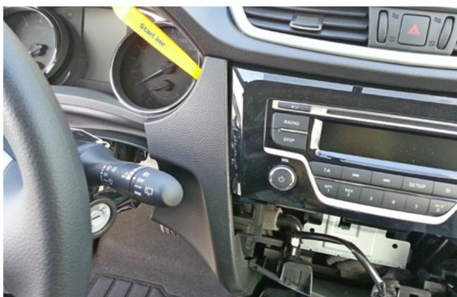
Фото 1.14. Снять правую декоративную накладку панели
