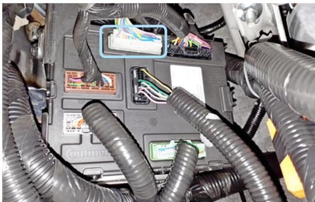
Фото 3.4. Местоположение разъёма DS1
