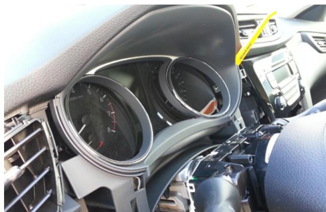
Фото 1.15. Снять декоративную накладку панели приборов
