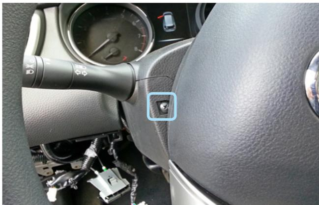
Фото 1.6. Саморез крепления кожуха рулевого вала слева
