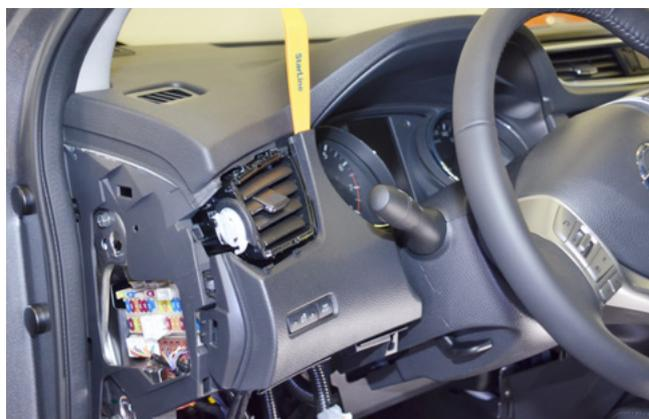
Фото 1.11. Снять левую накладку
