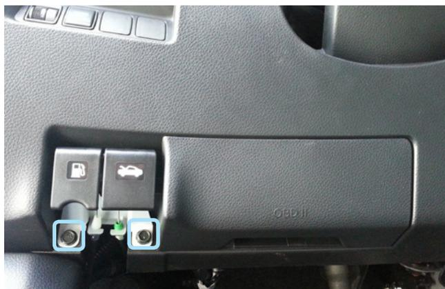
Фото 1.2. Болты крепления ручки отпирания капота
