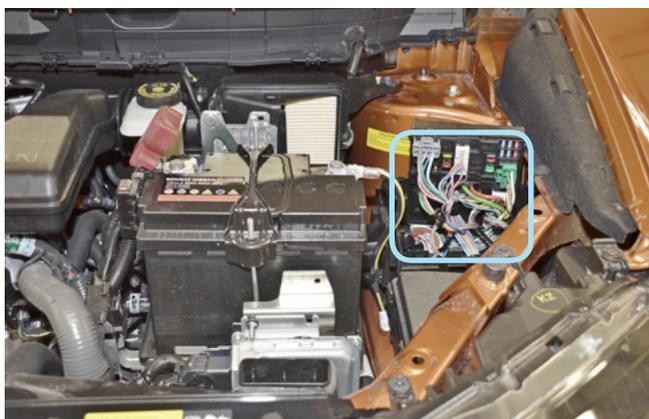
Фото 2.11. Возможное место установки подкапотного блока R6
