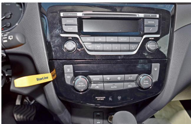
Фото 1.12. Снять блок управления климат-контролем
