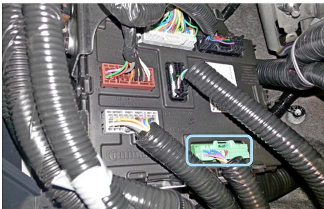
Фото 3.2. Местоположение разъёма BS
