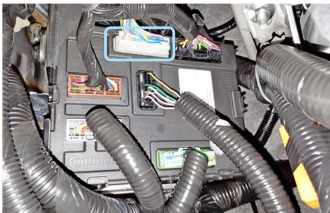
Фото 3.6. Местоположение разъёма DS1
