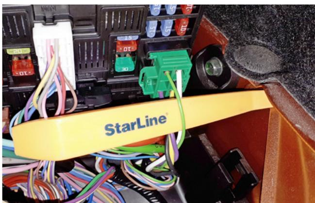
Фото 2.13. Подключение цепи зажигания (зелёный)
