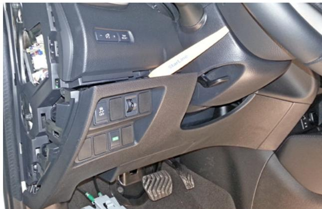
Фото 1.4. Снять пластиковую накладка под рулевой колонкой
