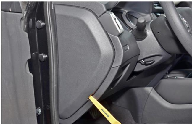
Фото 1.3. Снять накладку с левой стороны передней панели
