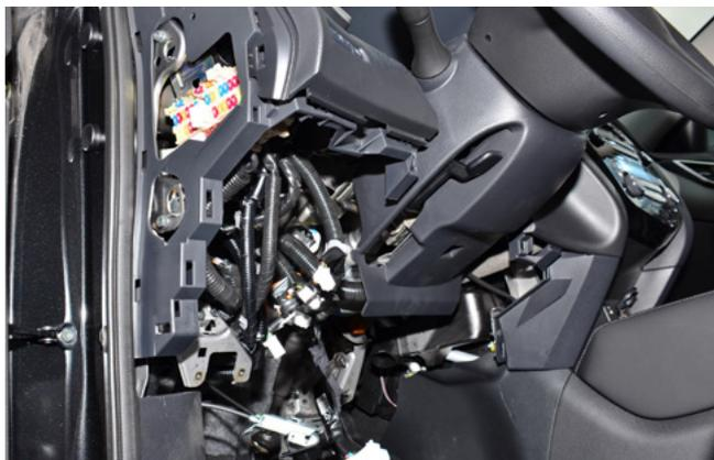
Фото 1.5. Пластиковая накладка под рулевой колонкой снята
