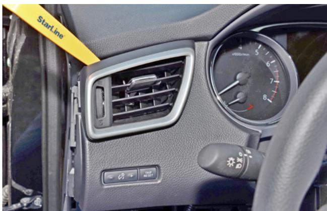
Фото 1.10. Снять левую декоративную накладку воздуховода
