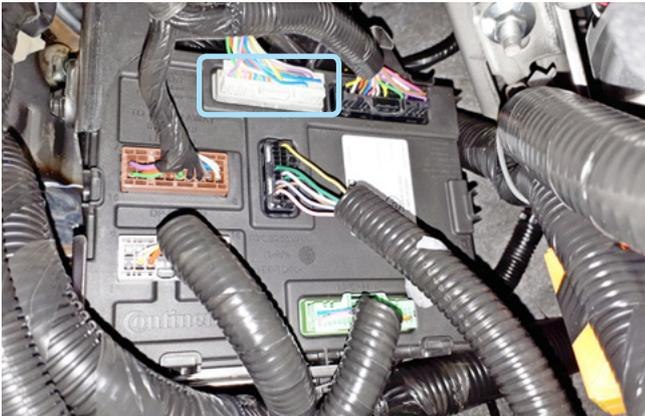
Фото 3.8. Местоположение разъёма DS1
