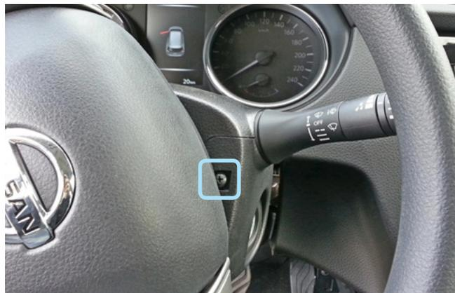
Фото 1.7. Саморез крепления кожуха рулевого вала справа
