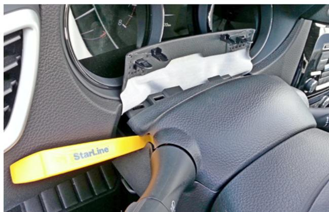
Фото 1.9. Снять кожух рулевого вала
