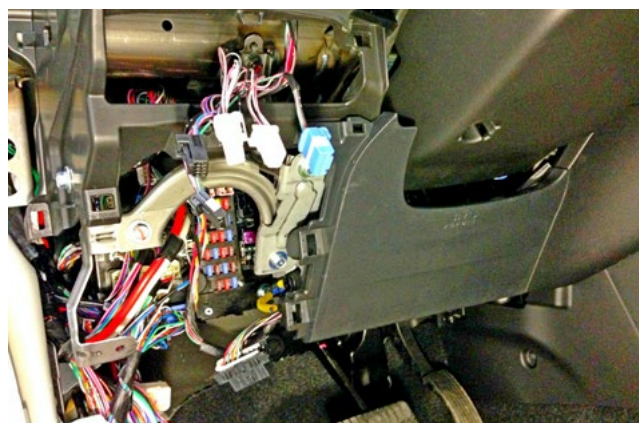
Фото 1.8. Декоративная накладка слева от рулевой колонки снята
