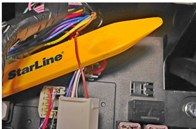
Фото 3.7. Разъём 1, зажигание (коричнево-красный)
