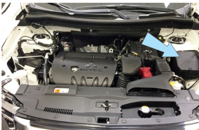
Фото 2.7. Возможное место установки подкапотного блока R6
