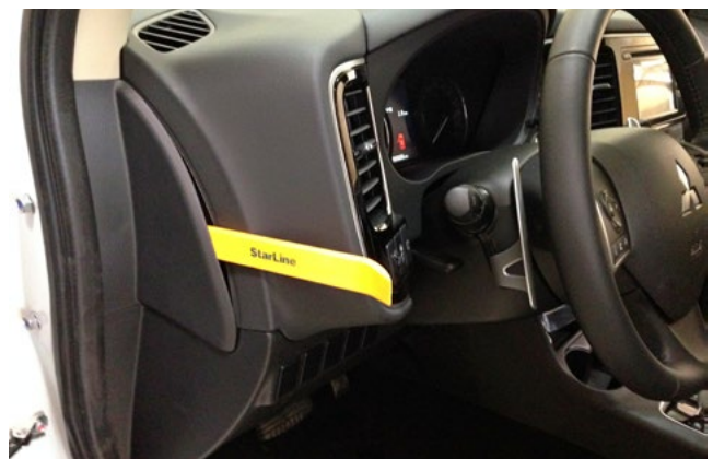
Фото 1.6. Снять левую боковую накладку передней панели
