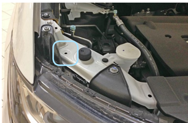
Фото 2.5. Возможное место установки концевика капота
