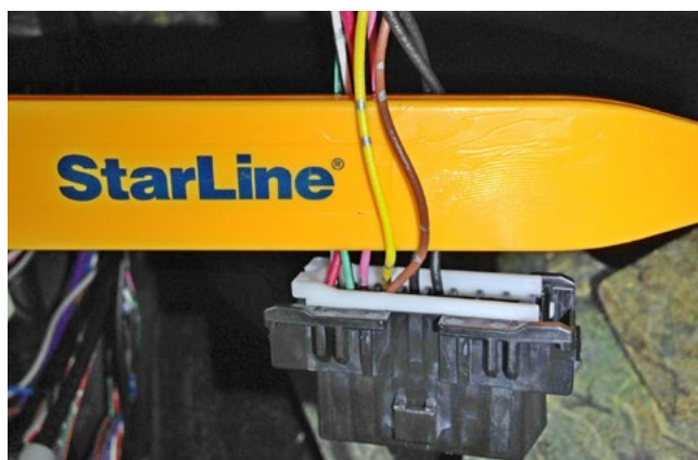
Фото 3.5. Шина CAN-B (коричневый и жёлтый)
