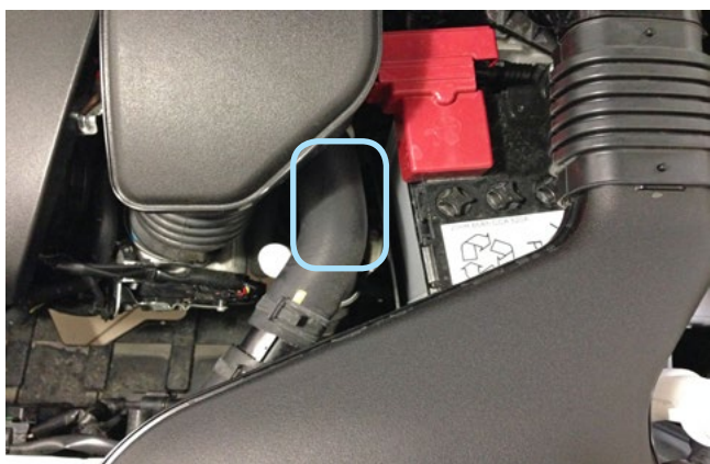
Фото 2.3. Место установки датчика температуры двигателя
