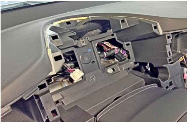
Фото 1.15. Панель приборов снята
