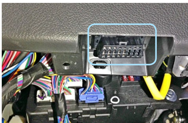
Фото 3.4. Местоположение разъёма OBD-II
