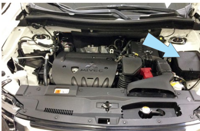
Фото 2.7. Возможное место установки подкапотного блока R6
