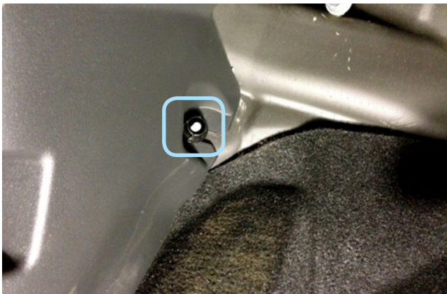
Фото 1.3. Клипса крепления накладки левой кик-панели
