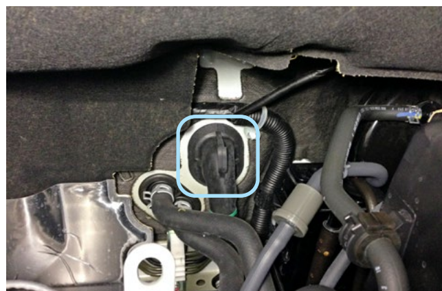
Фото 2.6. Штатный уплотнитель. Вид со стороны капота
