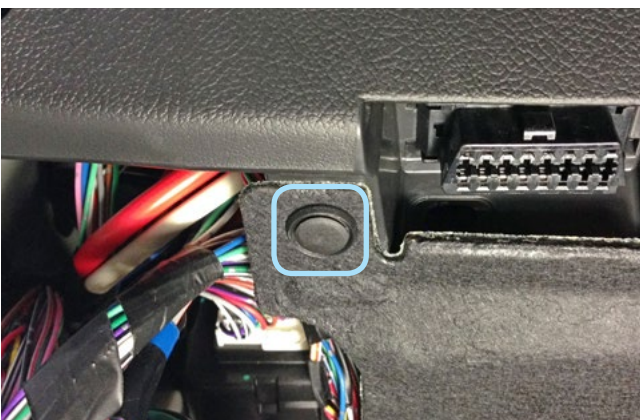
Фото 1.5. Клипса крепления накладки педального узла
