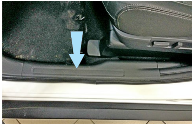
Фото 1.2. Снять накладку порога двери водителя
