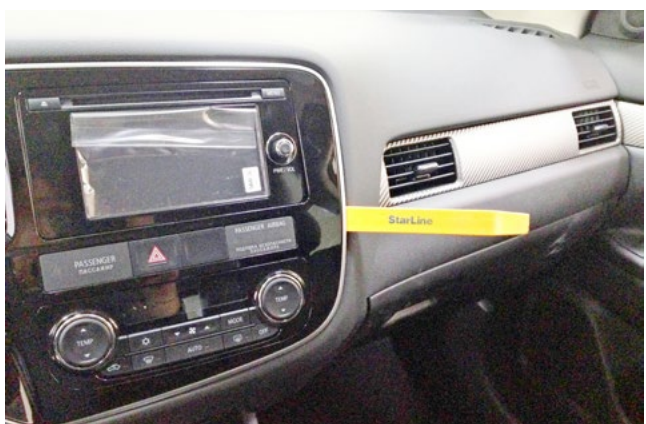
Фото 1.11. Снять декоративную накладку магнитолы
