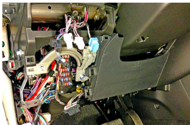
Фото 1.8. Декоративная накладка слева от рулевой колонки снята
