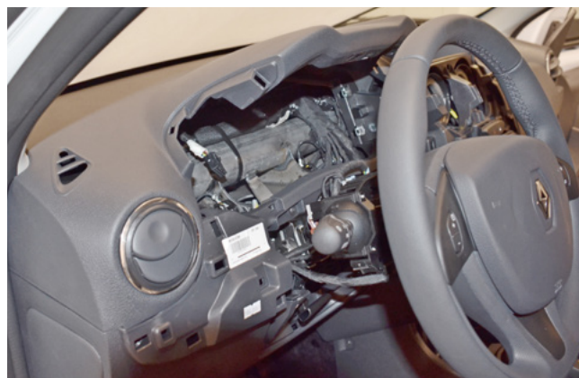
Фото 1.17. Панель приборов снята
