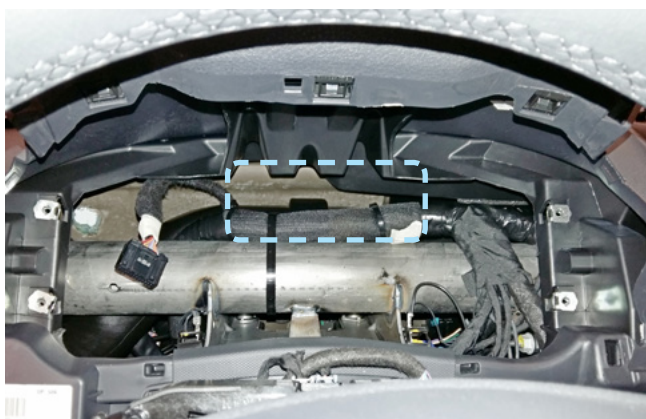
Фото 2.11. Пример расположения центрального блока охранно-телематического комплекса
