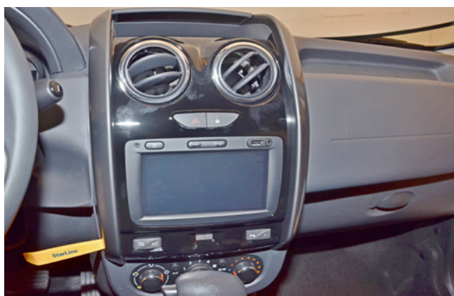
Фото 1.10. Снять накладку центральной консоли
