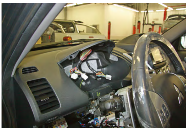
Фото 4.3. Панель приборов снята
