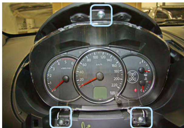
Фото 4.2. Декоративная накладка снята. Саморезы крепления панели приборов
