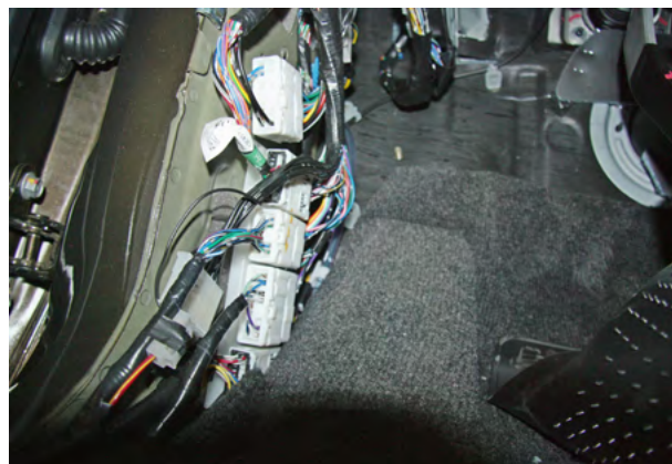
Фото 2.4. накладка кик-панели снята
