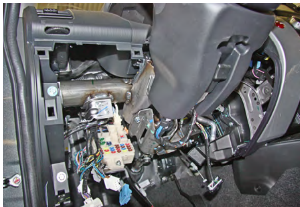
Фото 1.6. Пластиковая накладка снята
