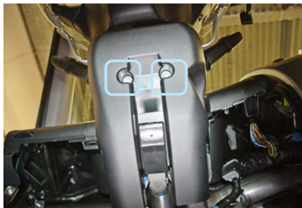
Фото 3.2. Саморезы крепления нижней части кожуха рулевого вала
