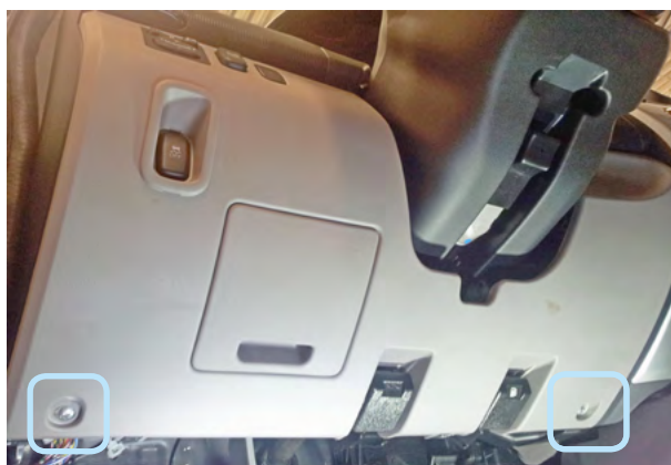
Фото 1.4. Саморезы крепления пластиковой наклейки
