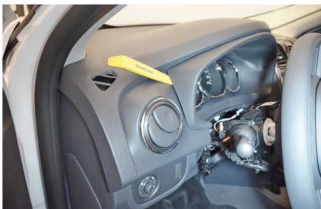
Фото 1.4. Снять накладку панели приборов
