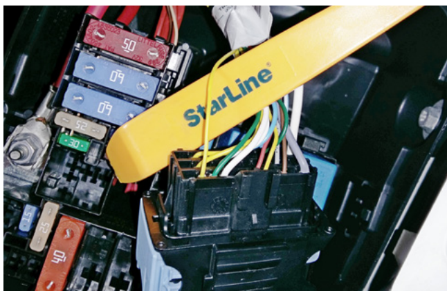
Фото 2.11. Подключение цепи зажигания (жёлтый)
