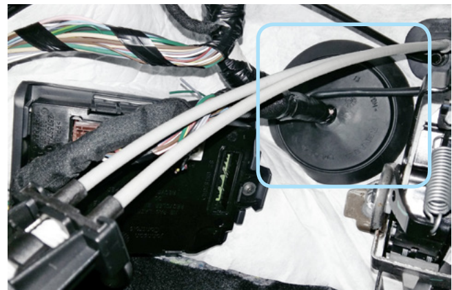
Фото 2.8. Штатный уплотнитель. Вид со стороны салона
