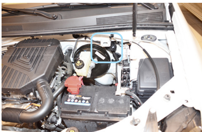
Фото 2.1. Возможное место установки сирены
