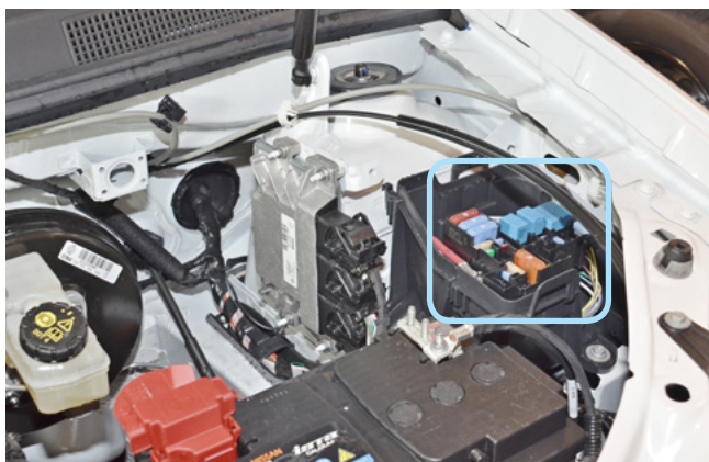
Фото 2.9. Возможное место установки подкапотного блока R6
