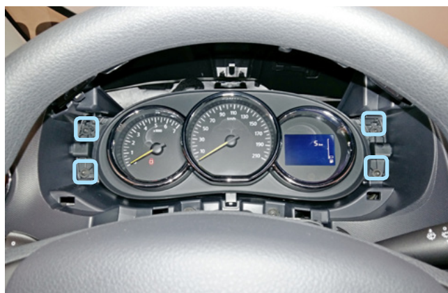
Фото 1.5. Саморезы крепления панели приборов
