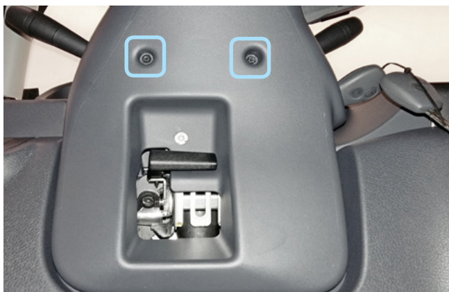
Фото 1.1. Саморезы крепления нижней части кожуха
