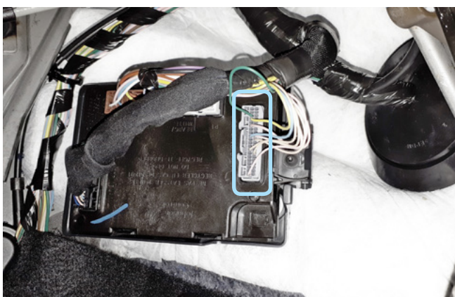
Фото 3.4. Местоположение серого разъёма S2
