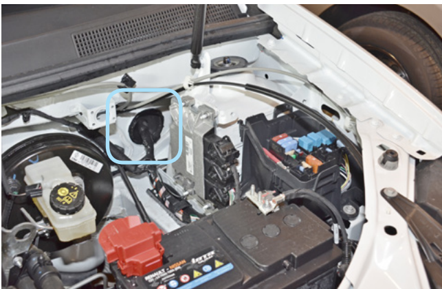
Фото 2.7. Штатный уплотнитель. Вид со стороны капота
