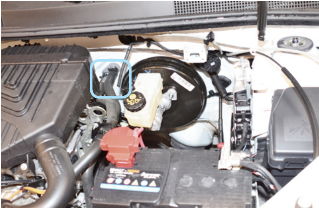
Фото 2.3. Место установки датчика температуры двигателя
