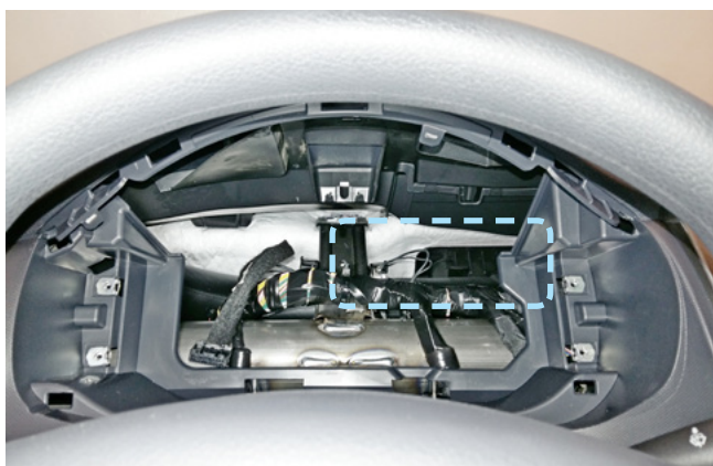
Фото 2.13. Пример расположения центрального блока охранно-телематического комплекса
