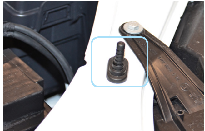
Фото 2.6. Крепление концевика капота
