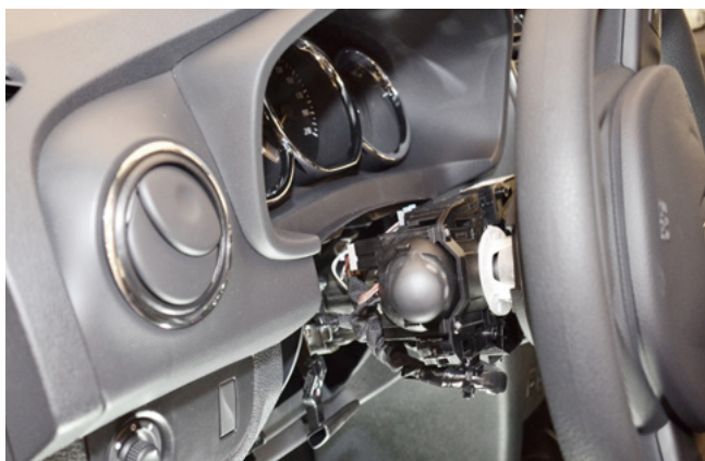
Фото 1.3. Кожух рулевого вала снят
