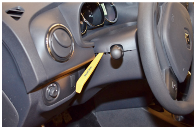
Фото 1.2. Снять верхнюю часть кожуха рулевого вала
