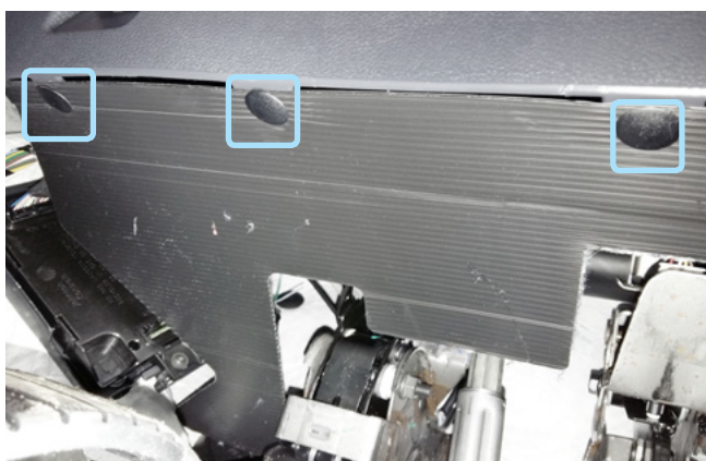
Фото 1.7. Клипсы крепления декоративной накладки педального узла
