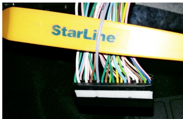
Фото 3.11. Управление подогревом заднего стекла и боковых зеркал (серый)
