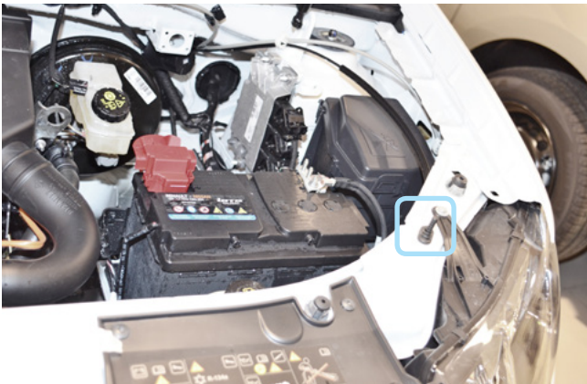
Фото 2.5. Возможное место установки концевика капота
