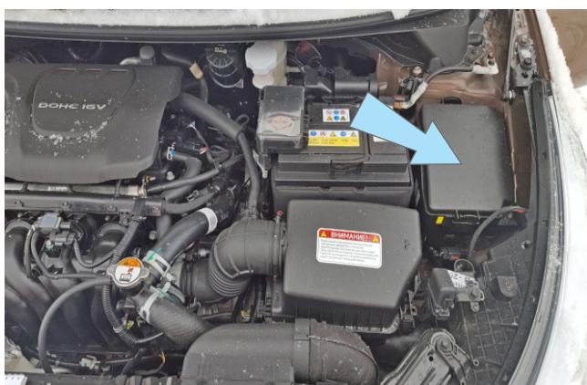
Фото 2.6. Возможное место установки подкапотного блока R6
