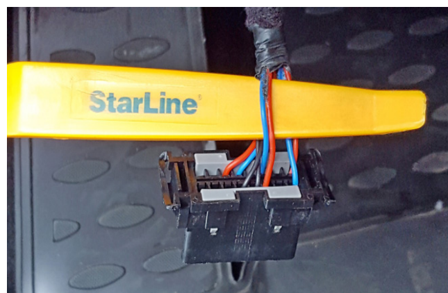
Фото 3.5. Шина CAN-B (красный и синий)
