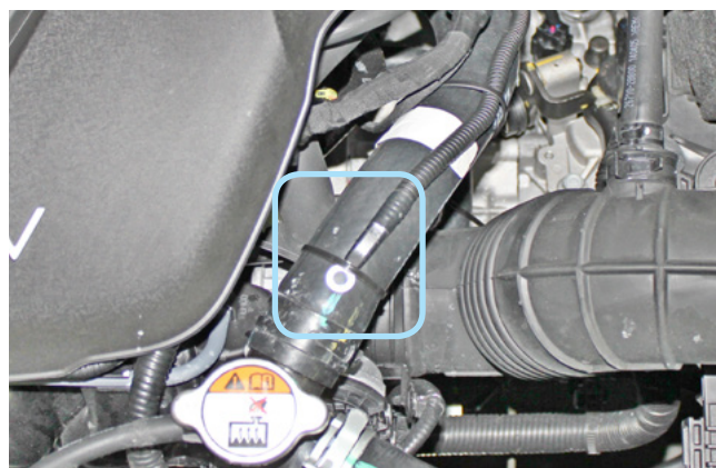
Фото 2.4. Крепление датчика температуры двигателя
