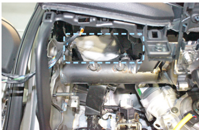
Фото 2.7. Пример расположения центрального блока охранно-телематического комплекса
