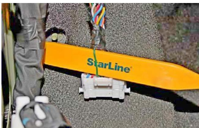
Фото 3.6. Контроль концевика багажника (зелёный)
