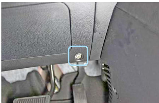
Фото 1.5. Саморез крепления накладки под рулевой колонкой справа
