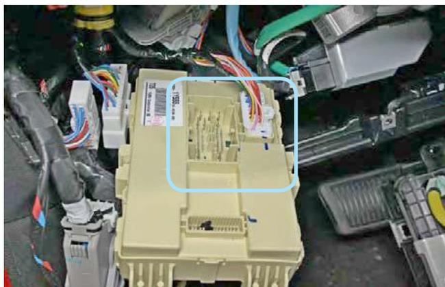
Фото 3.14. Местоположение разъёмов
