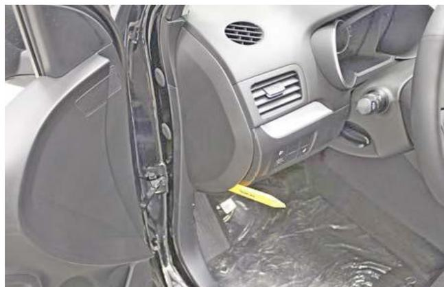
Фото 1.2. Снять левую боковую накладку передней панели
