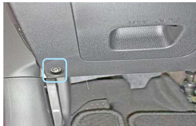
Фото 1.4. Саморез крепления накладки под рулевой колонкой слева
