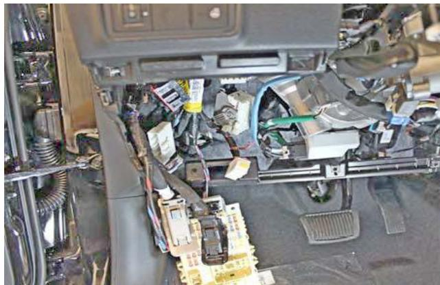
Фото 1.8. Монтажный блок предохранителей снят
