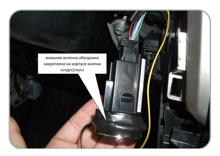
**Красный (+)** провод питания обходчика подключить к +12В. через предохранитель. **Черный (-)** провод обходчика подключается к **жёлтому/белому** проводу разъема **CN4** допканала№4 «отрицательное зажигание».
