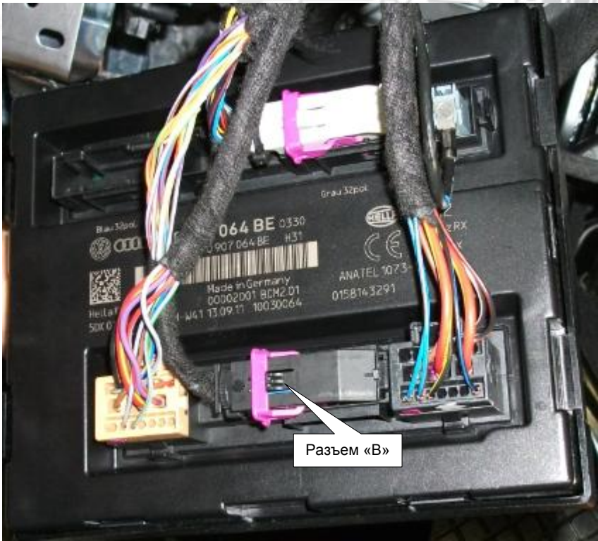
Блок управления систем комфорта J393 (расположен слева от рулевой колонки)
