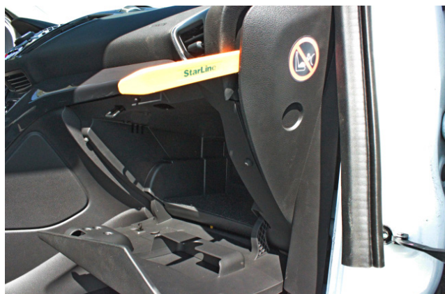
Фото 1.2. Снять боковую накладку передней панели
