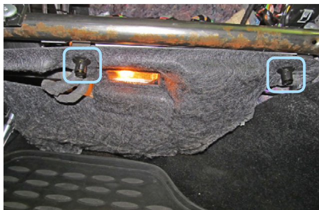
Фото 1.6. Клипсы крепления декоративной накладки под блоком ВСМ
