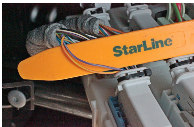
Фото 3.10. Шина данных штатного иммобилайзера (фиолетово-серый и жёлто-оранжевый)
