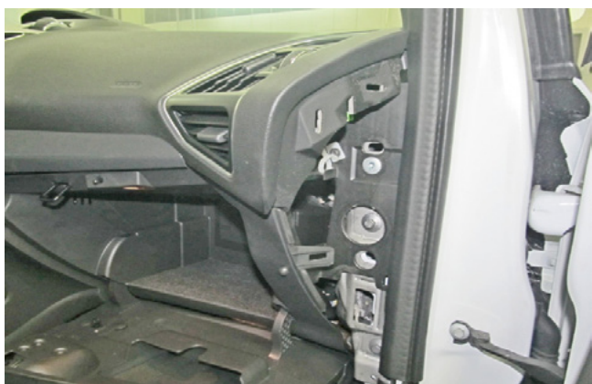
Фото 1.3. Боковая накладка передней панели снята
