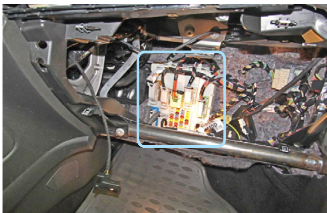
Фото 1.5. Перчаточный ящик снят. Блок ВСМ
