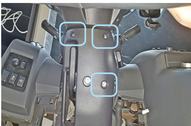
Фото 1.8. Саморезы крепления нижней части кожуха
