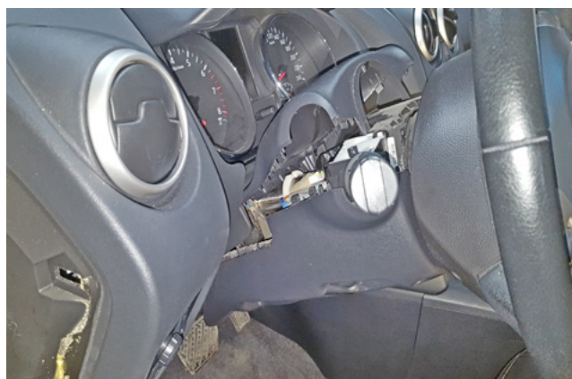
Фото 1.7. Верхняя часть кожуха рулевого вала снята
