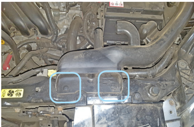
Фото 2.3. Клипсы крепления воздуховода
