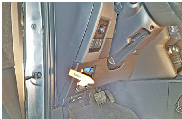
Фото 1.2. Снять боковую накладку передней панели
