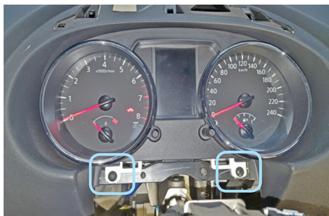
Фото 1.13. Саморезы крепления панели приборов
