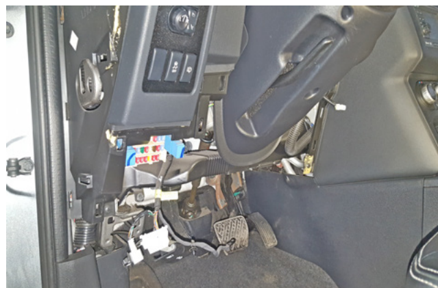
Фото 1.4. Пластиковая накладка под рулевой колонкой снята
