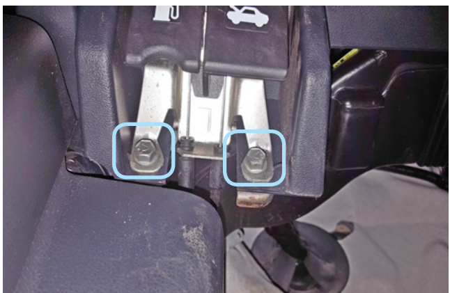
Фото 1.3. Болты крепления ручки отпирания капота
