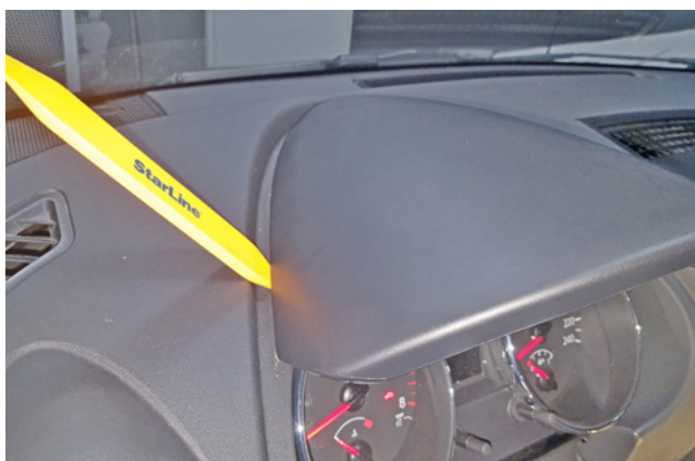
Фото 1.11. Снять солнцезащитный козырёк
