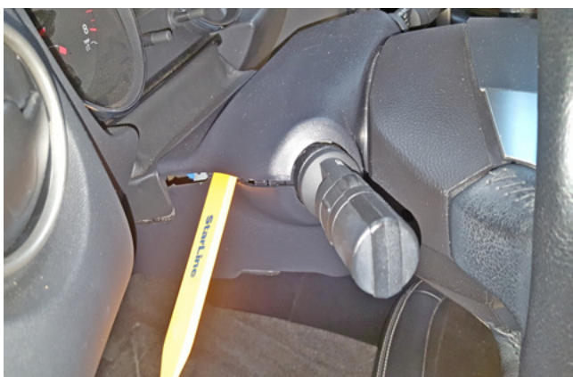
Фото 1.6. Снять верхнюю часть кожуха рулевого вала
