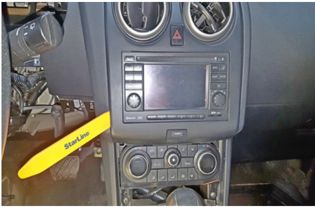
Фото 1.17. Снять верхнюю декоративную накладку центральной консоли
