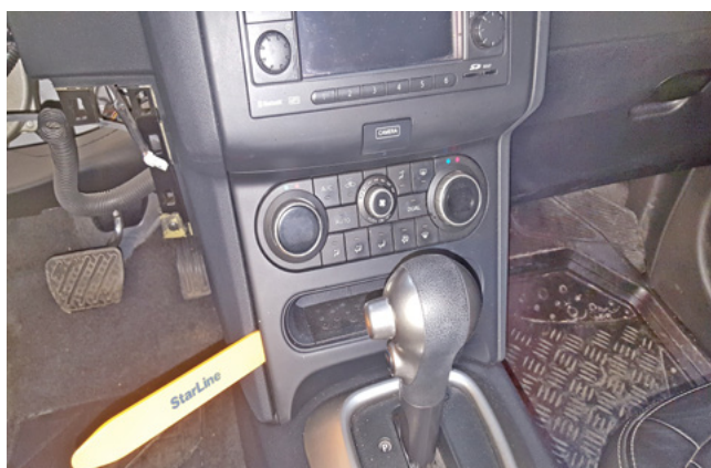
Фото 1.16. Снять нижнюю декоративную накладку центральной консоли
