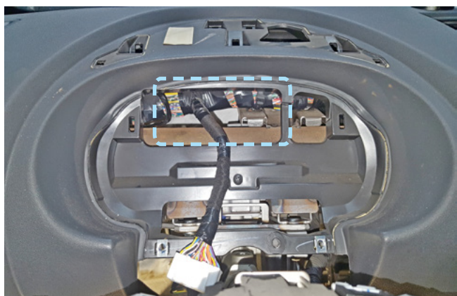
Фото 2.9. Пример расположения центрального блока охранно-телематического комплекса
