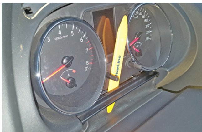
Фото 1.12. Снять нижнюю декоративную накладку
