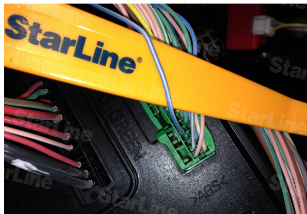
Фото 10.2. Концевик двери водителя (сине-белый, pin 16)
