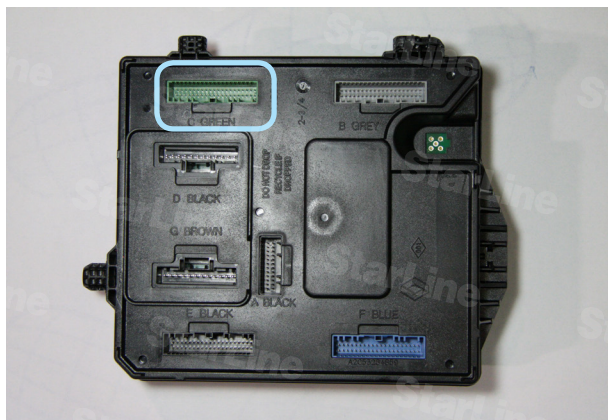
Фото 10.1. Расположение зелёного разъёма (C GREEN)
