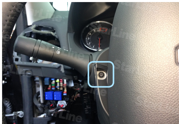
Фото 2.2. Саморез крепления верхней части кожуха
