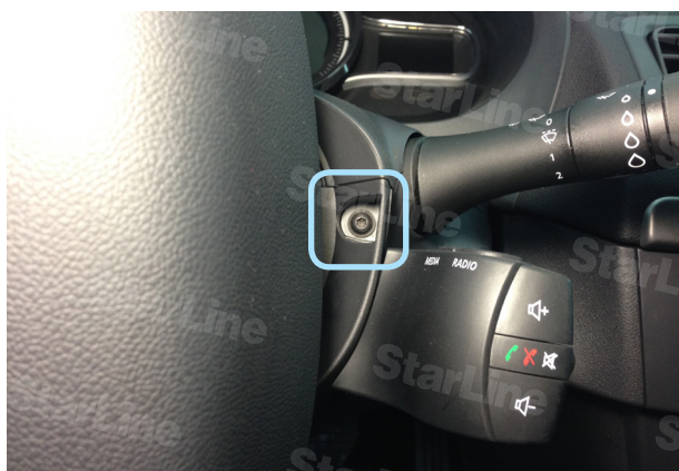
Фото 2.3. Саморез крепления верхней части кожуха
