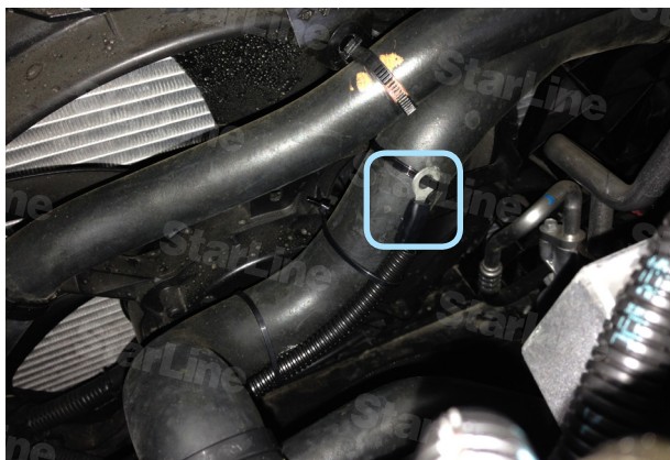
Фото 5.3. Место установки датчика температуры двигателя
