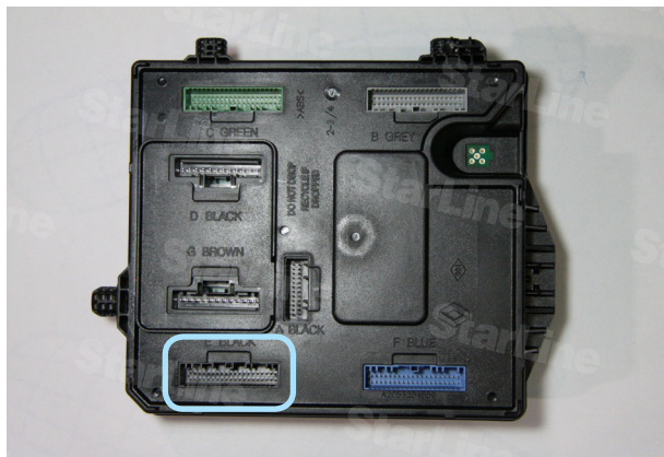
Фото 9.1. Расположение чёрного разъёма (E BLACK)
