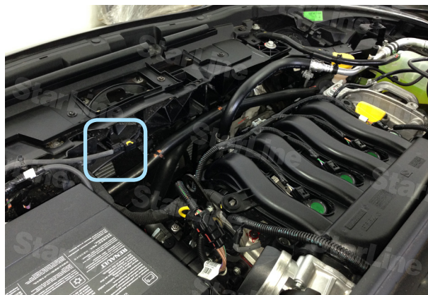
Фото 5.4. Местоположение разъёма штатного концевика капота
