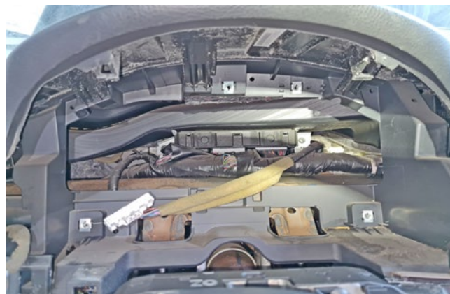
Фото 1.20. Панель приборов снята
