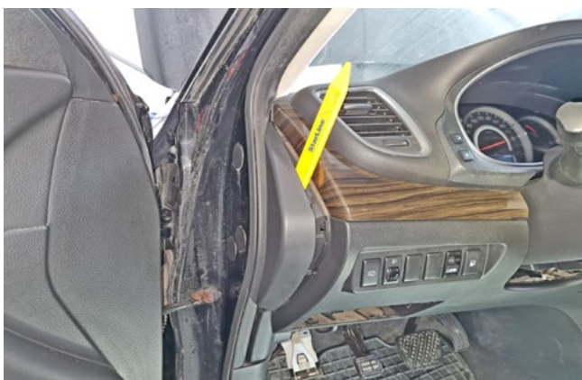
Фото 1.5. Снять боковую накладку передней панели
