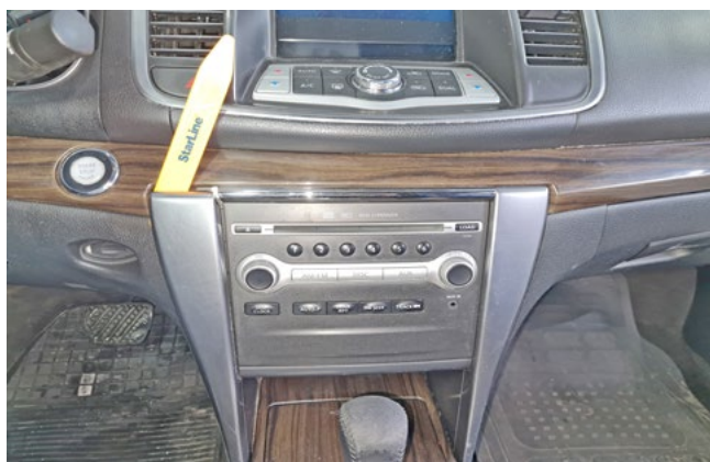
Фото 1.7. Снять левую декоративную накладку мультимедиа
