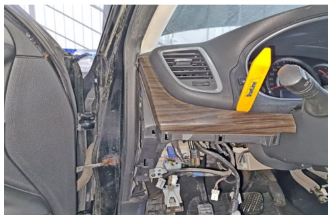
Фото 1.12. Снять левую декоративную накладку передней панели
