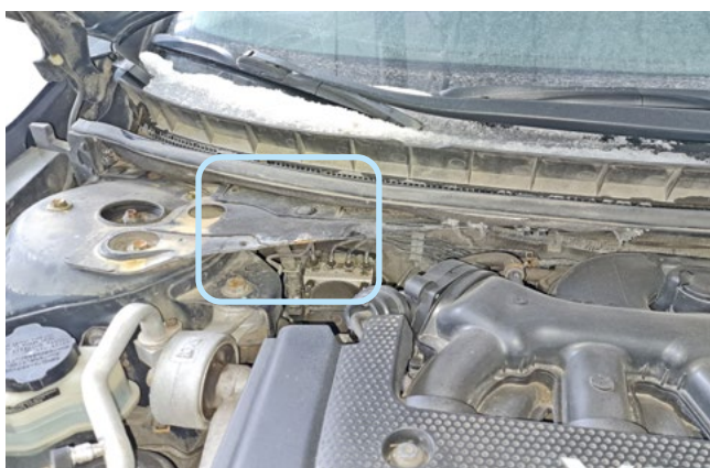
Фото 2.2. Возможное место установки сирены
