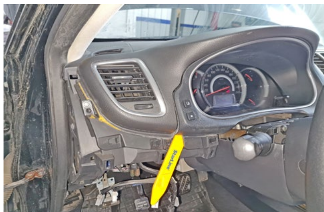
Фото 1.18. Снять декоративную накладку панели приборов
