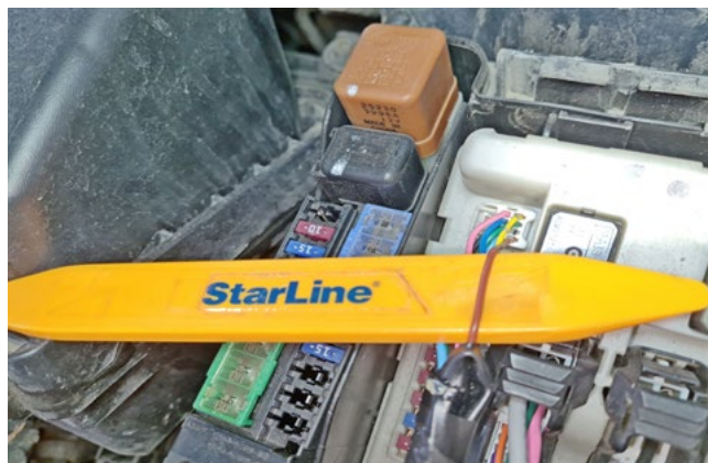
Фото 3.13. Сигнал стартера «-» (коричневый)
