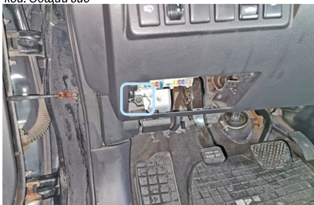
Фото 1.3. Карман для мелочей снят. Саморез крепления
