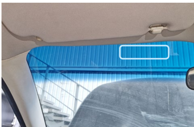
Фото 2.1. Возможное место установки антенного модуля
