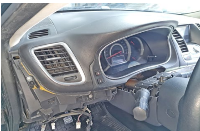
Фото 1.17. Верхняя часть кожуха рулевого вала снята
