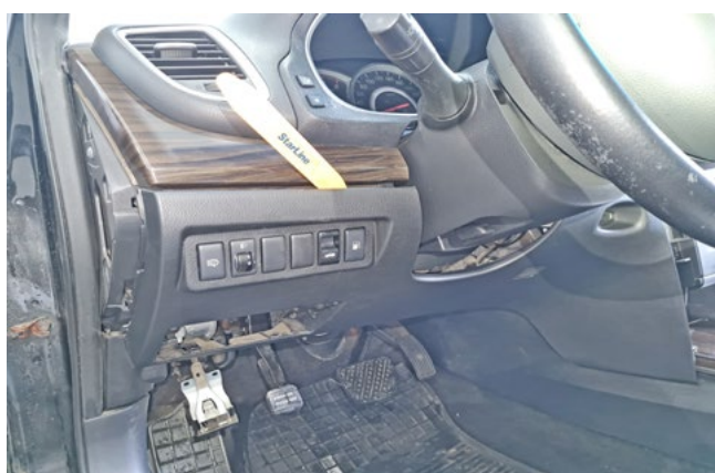
Фото 1.9. Снять пластиковую накладку под рулевой колонкой
