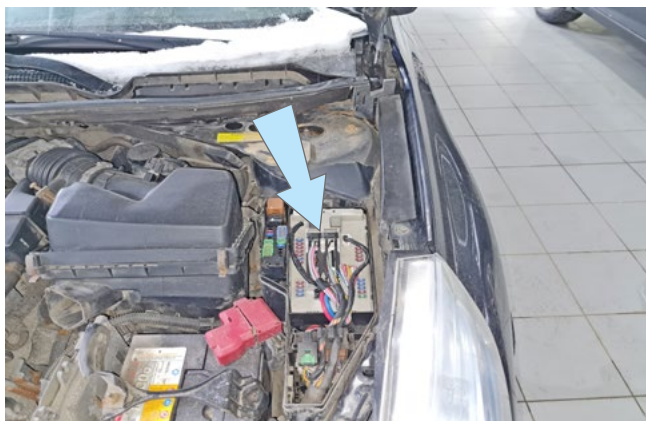
Фото 3.12. Местоположение блока IPDM
