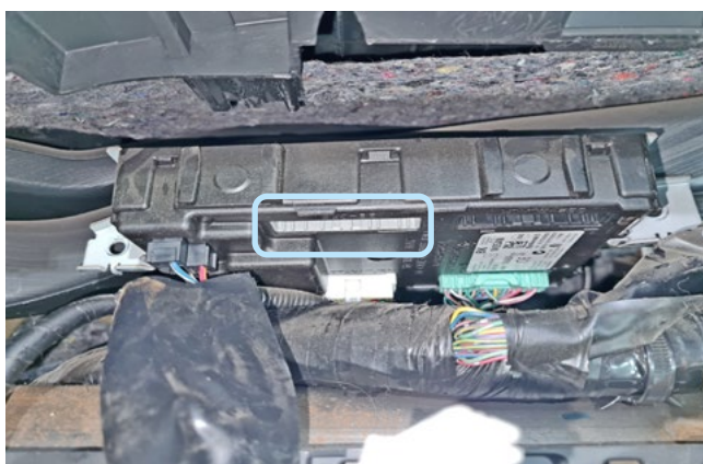
Фото 3.9. Местоположение серого разъёма на блоке BCM
