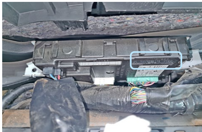
Фото 3.5. Местоположение чёрного разъёма на блоке BCM
