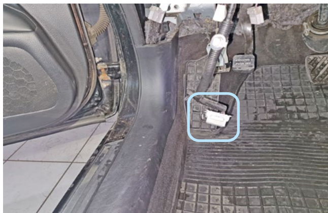
Фото 3.2. Местоположение разъёма OBD-II
