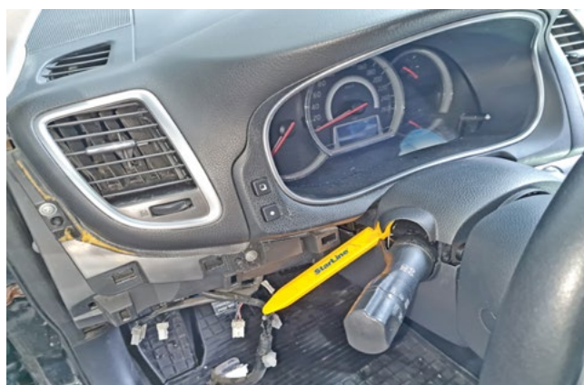
Фото 1.16. Снять верхнюю часть кожуха рулевого вала
