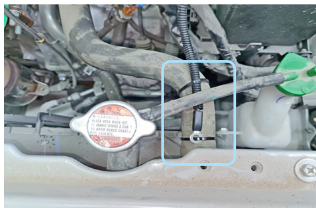
Фото 2.5. Крепление датчика температуры двигателя
