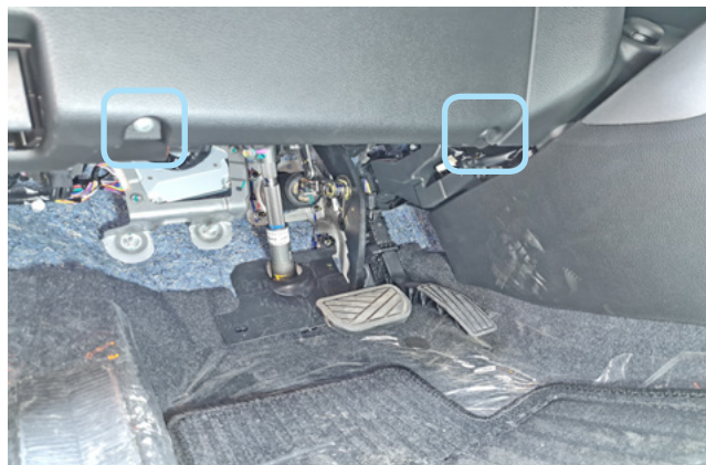
Фото 1.2. Саморезы крепления накладки
