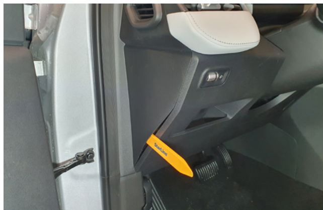
Фото 1.2. Снять боковую накладку передней панели
