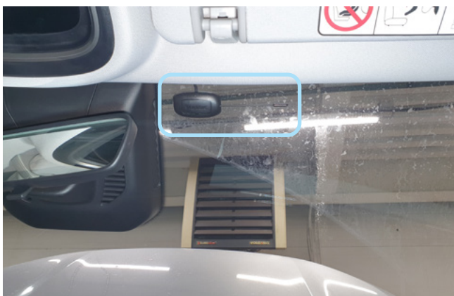
Фото 2.1. Возможное место установки антенного модуля
