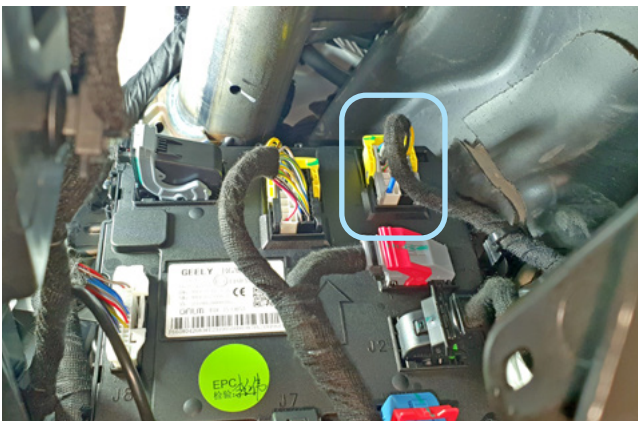
Фото 3.1. Местоположение разъёма J1
