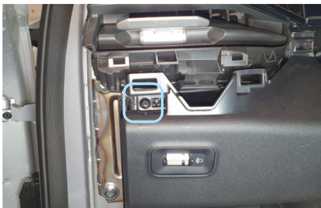
Фото 1.5. Накладка снята. Саморез
