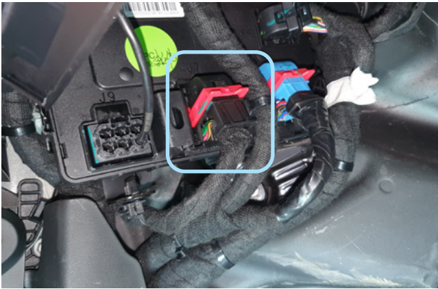
Фото 3.5. Местоположение разъёма J7
