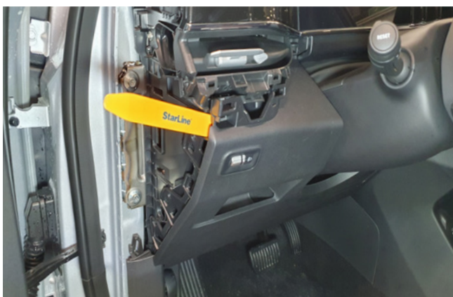
Фото 1.7. Снять пластиковую накладку под рулевой колонкой
