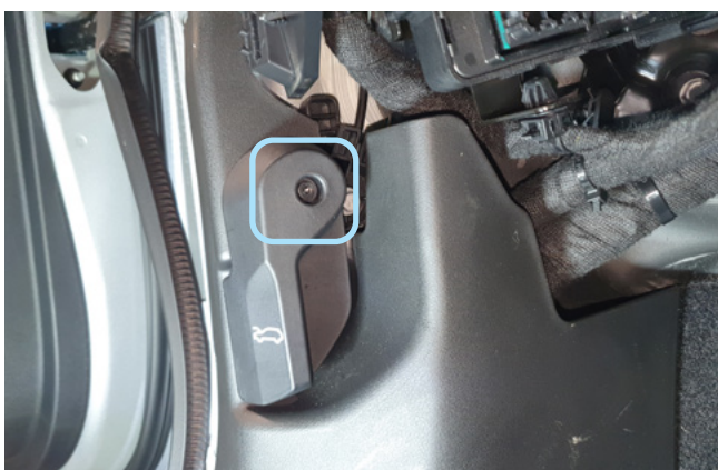
Фото 1.9. Винт крепления ручки отпирания капота
