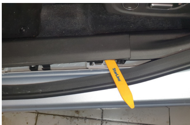
Фото 1.10. Снять накладку порога двери водителя
