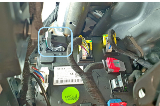
Фото 3.9. Местоположение разъёма J6
