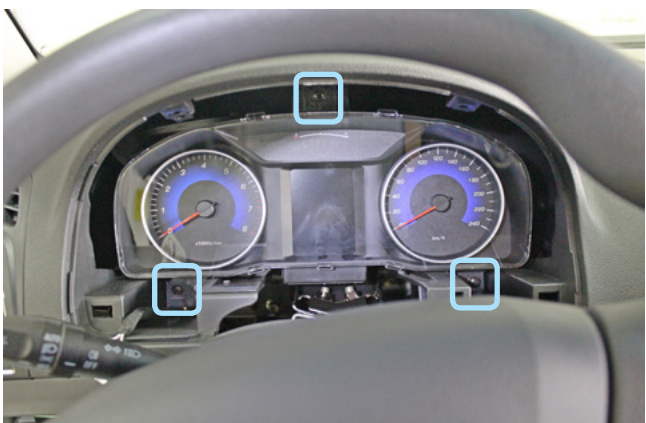
Фото 1.13. Декоративная накладка панели приборов снята. Саморезы крепления панели приборов
