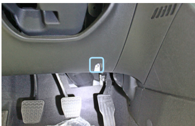
Фото 1.9. Саморез крепления пластиковой накладки под рулевой колонкой снизу
