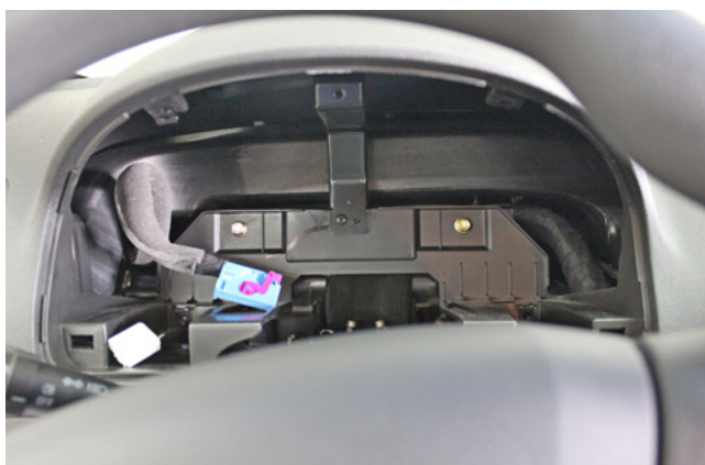
Фото 1.14. Панель приборов снята
