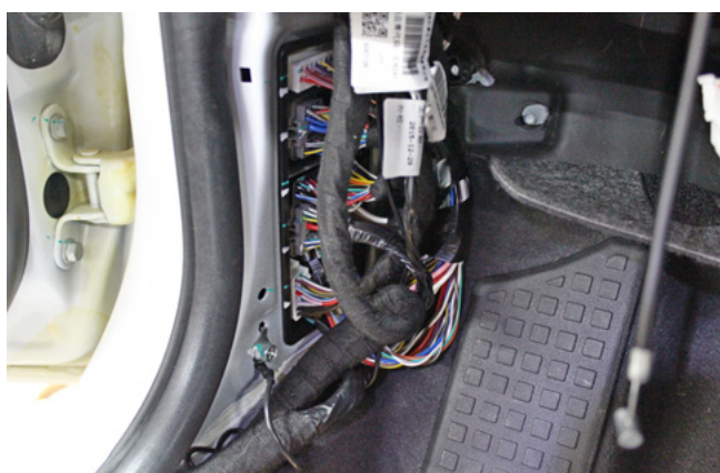
Фото 1.19. Накладка кик-панели снята
