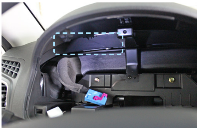
Фото 2.8. Пример расположения центрального блока охранно-телематического комплекса
