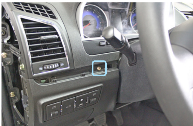
Фото 1.5. Декоративная накладка снята. Саморез
