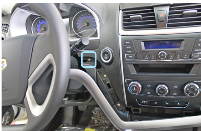
Фото 1.7. Декоративная накладка справа частично снята. Саморез
