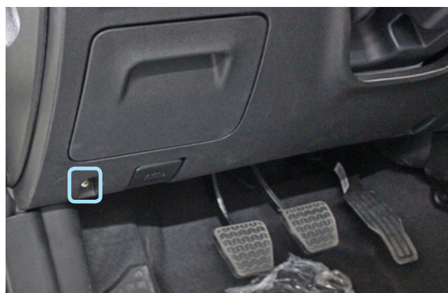
Фото 1.8. Саморез крепления пластиковой накладки под рулевой колонкой снизу
