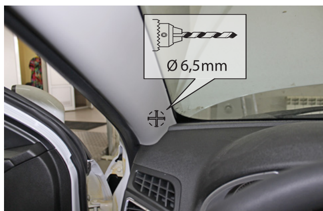
Фото 2.2. Место установки светодиода
