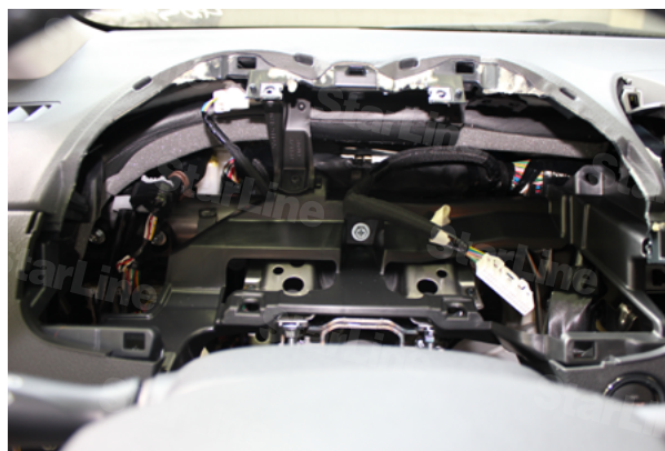
Фото 2.5. Щиток приборов снят
