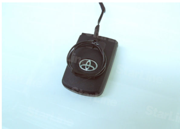
Фото 7.5. Расположение рамки для обхода иммобилайзера на ключе
