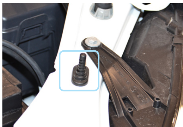
Фото 5.6. Крепление концевика капота
