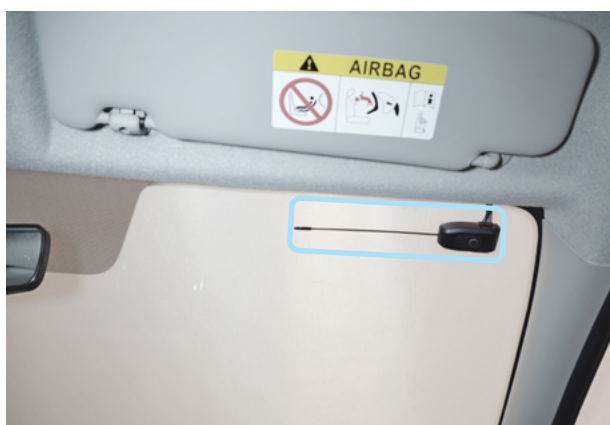
Фото 4.1. Возможное место установки антенного модуля
