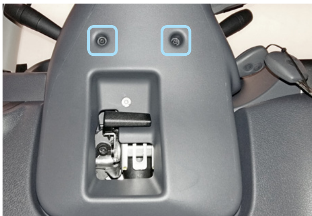
Фото 1.1. Саморезы крепления нижней части кожуха
