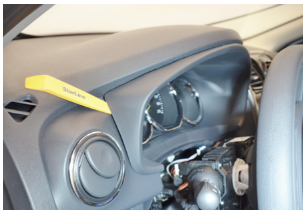
Фото 2.1. Снять накладку панели приборов
