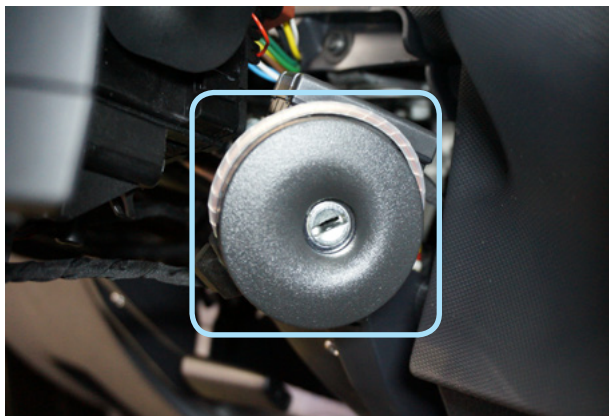
Фото 12. Расположение антенны модуля VP-03 на замке зажигания
