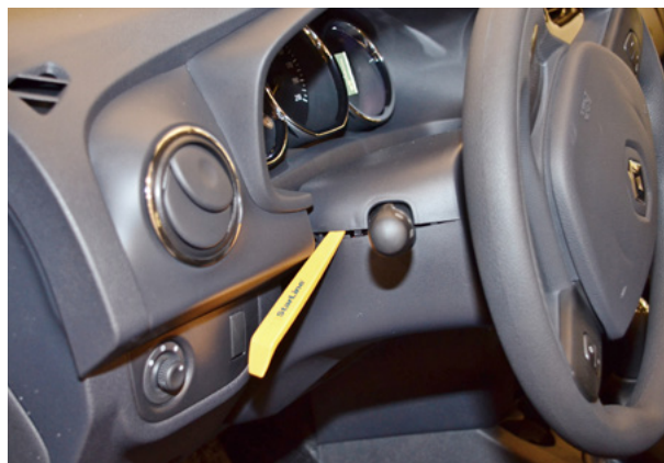
Фото 1.2. Снять верхнюю часть кожуха рулевого вала
