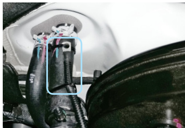
Фото 5.4. Крепление датчика температуры двигателя
