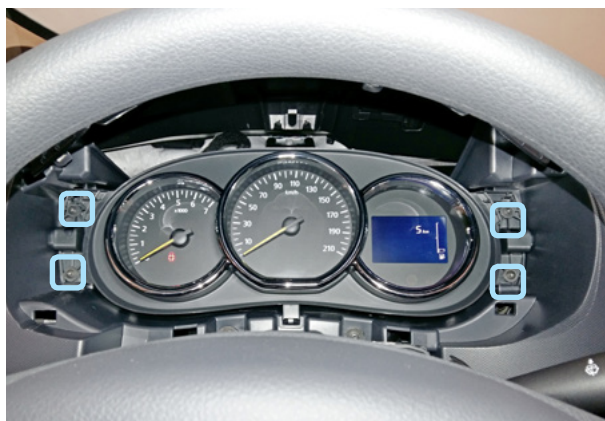
Фото 2.2. Саморезы крепления панели приборов
