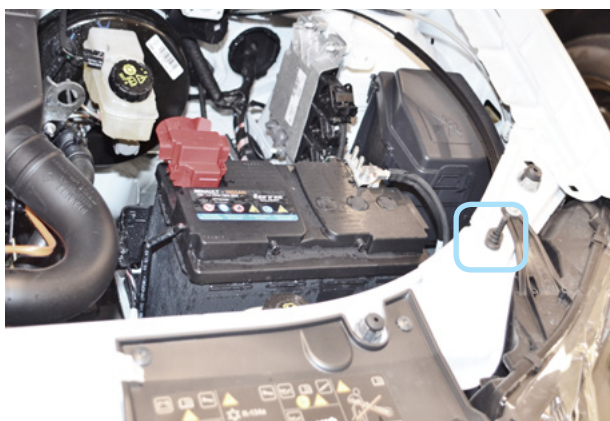
Фото 5.5. Возможное место установки концевика капота
