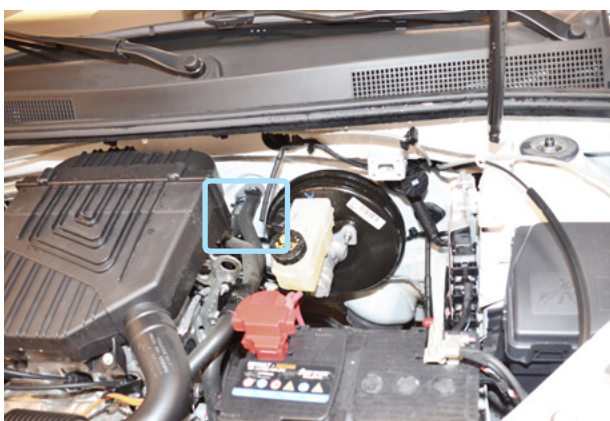
Фото 5.3. Место установки датчика температуры двигателя
