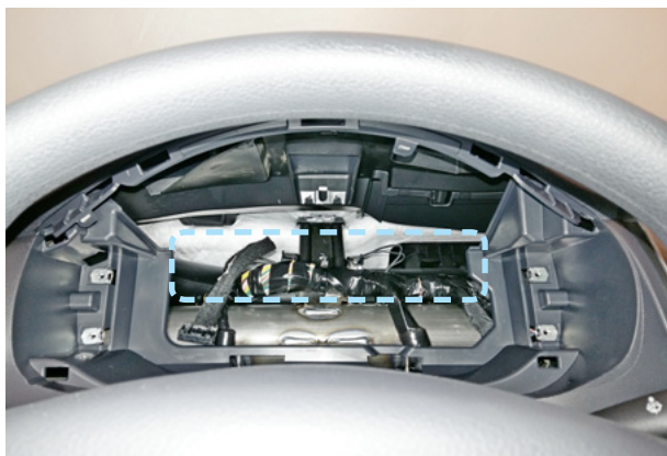
Фото 6. Пример расположения центрального блока охранно-телематического комплекса
