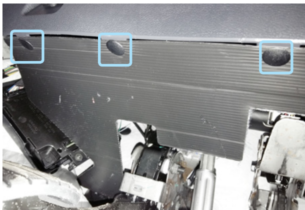
Фото 3. Клипсы крепления декоративной накладки педального узла
