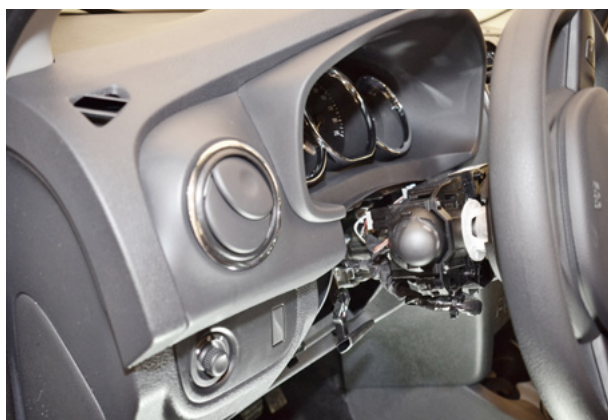
Фото 1.3. Кожух рулевого вала снят
