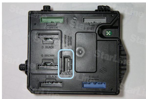
Фото 10.1. Расположение разъема A BLACK на центральном коммуникационном блоке салона
