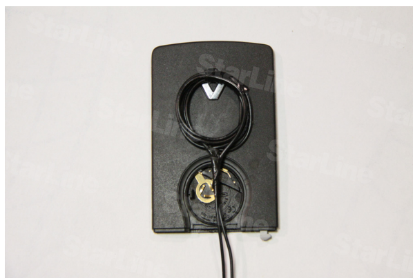
Фото 8.3. Расположение изготовленной рамки обходчика BP-03 на ключ-карте
