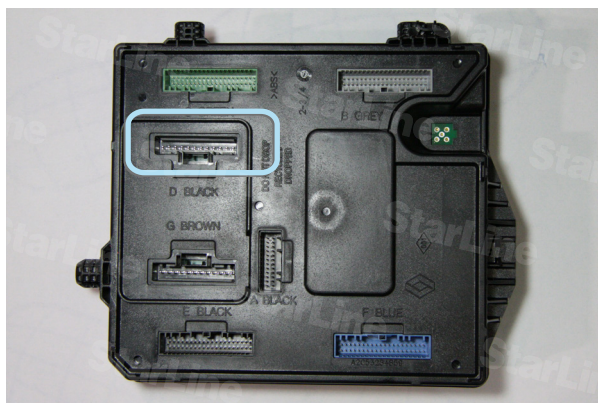
Фото 14.1. Расположение разъема D BLACK на центральном коммуникационном блоке салона
