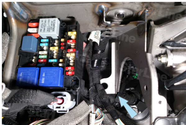
Фото 5. Место установки блока сигнализации
