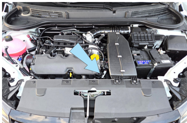
Фото 2.5. Место установки датчика температуры двигателя
