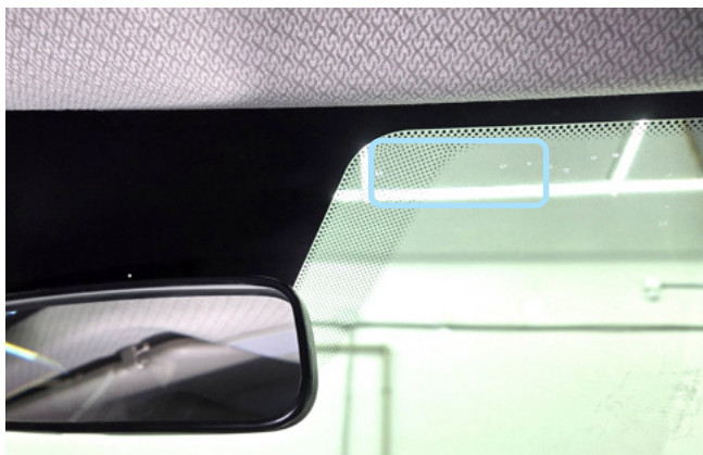
Фото 2.1. Возможное место установки антенны (сервисной кнопки)
