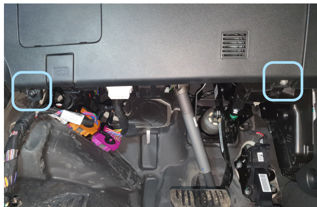
Фото 1.10. Крепление наклейки под рулевой колонкой
