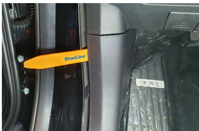
Фото 1.4. Снять накладку левой кик-панели
