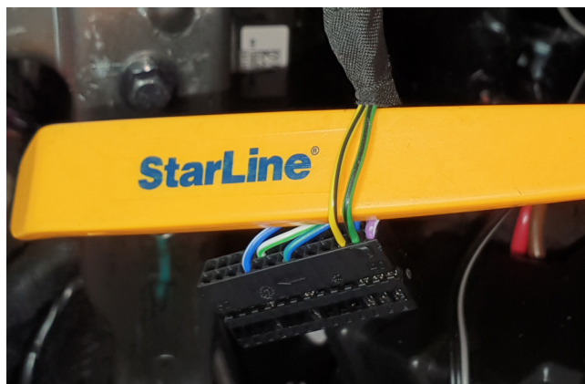
Фото 3.4. Шина CAN-A (жёлто-чёрный, pin 42 и зелёно-чёрный, pin 41)
