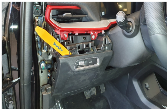
Фото 1.11. Снять пластиковую накладку под рулевой колонкой
