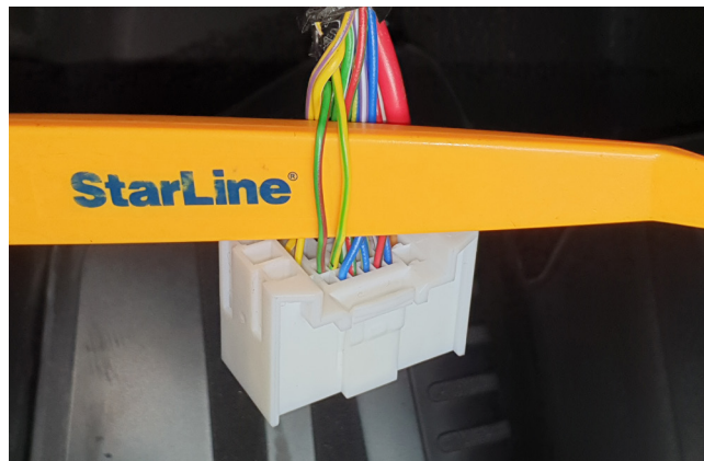
Фото 3.6. Шина CAN-B (жёлто-зелёный, pin 16 и зелёно-красный, pin 17)
