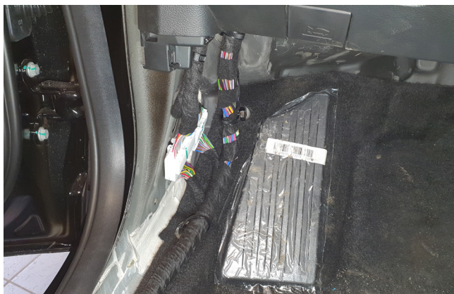
Фото 1.5. Накладка левой кик-панели снята
