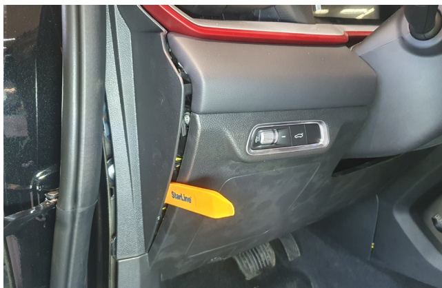
Фото 1.6. Снять боковую накладку передней панели
