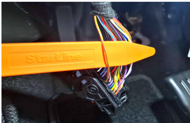
Фото 3.11. Деактивация штатной системы охраны (коричнево-жёлтый, pin 7)
