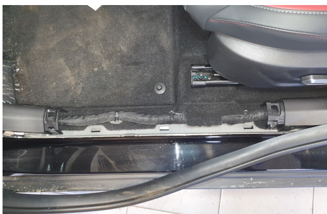
Фото 1.3. Накладка порога двери водителя снята
