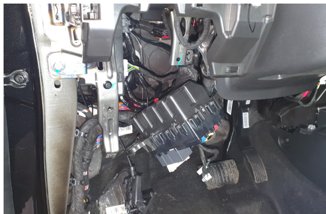
Фото 1.14. Монтажный блок предохранителей снят
