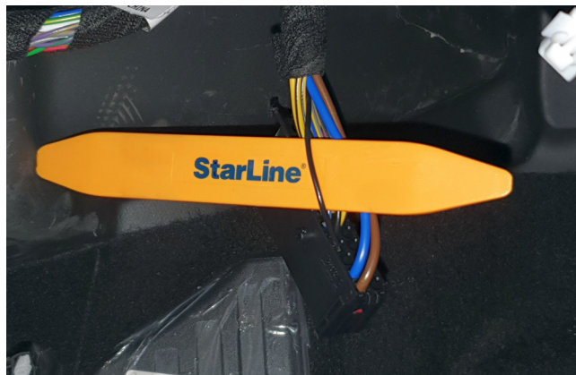
Фото 3.2. Подключение массы (чёрный, pin 7)
