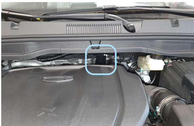
Фото 2.2. Возможное место установки сирены
