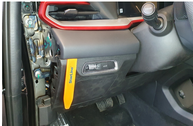
Фото 1.8. Снять накладку под левым воздуховодом
