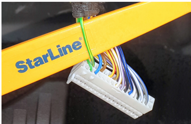
Фото 3.14. Зажигание 2 (зелёно-жёлтый, pin 31)
