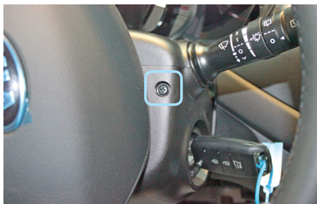
Фото 1.11. Саморез крепления кожуха рулевого вала справа
