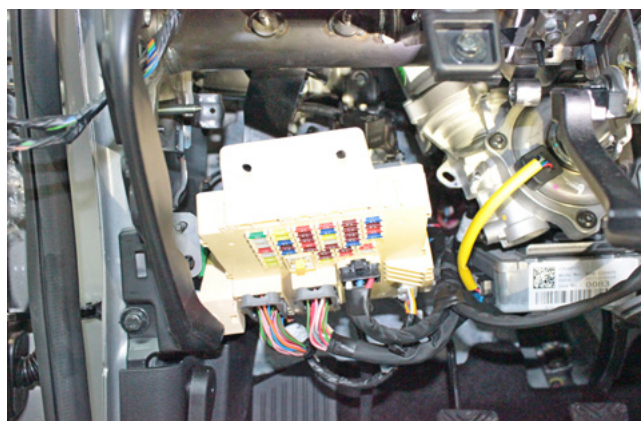
Фото 1.16. Монтажный блок снят
