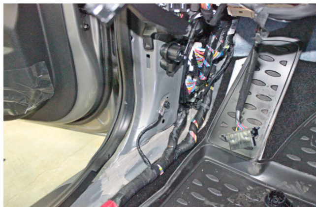
Фото 1.8. Накладка кик-панели снята
