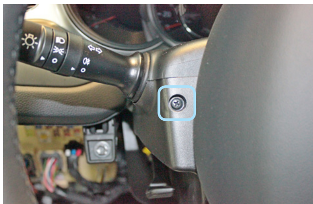
Фото 1.10. Саморез крепления кожуха рулевого вала слева
