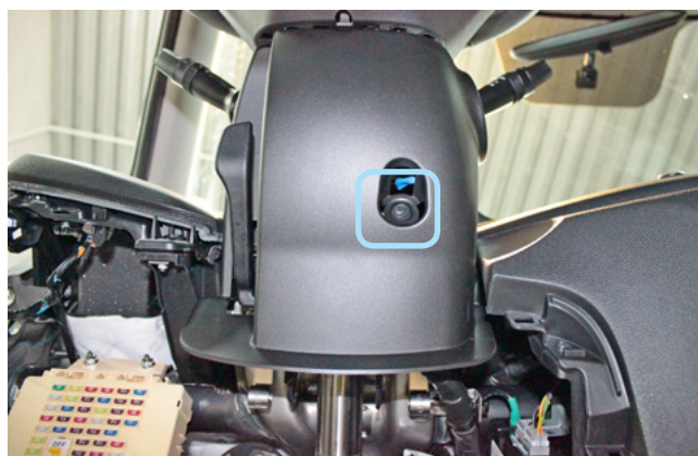
Фото 1.12. Саморез крепления кожуха рулевого вала снизу
