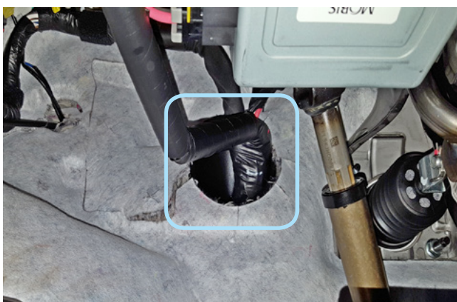
Фото 2.5. Штатный уплотнитель. Вид со стороны салона
