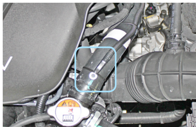
Фото 2.4. Крепление датчика температуры двигателя
