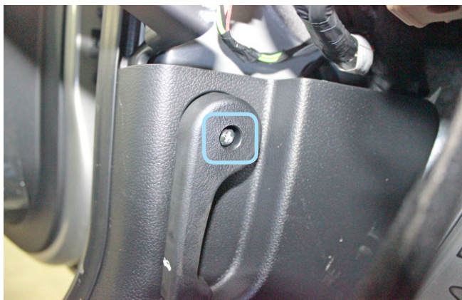
Фото 1.7. Винт крепления ручки отпирания капота
