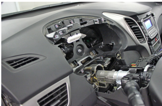
Фото 1.12. Панель приборов снята
