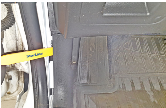
Фото 1.19. Снять накладку левой кик-панели
