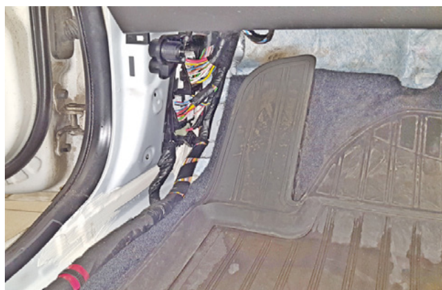
Фото 1.20. Накладка левой кик-панели снята
